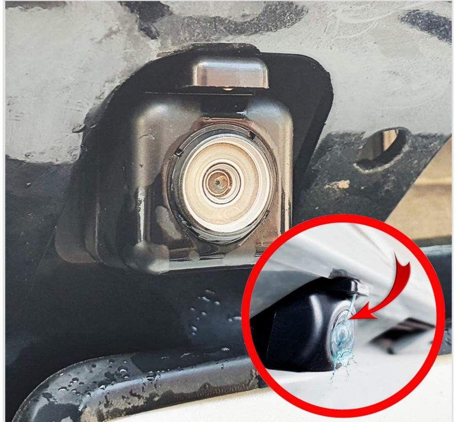
**9** Для регулировки форсунки используйте кнопку-гвоздь (в комплекте), согнув её плоскогубцами, как это показано на рисунке.
