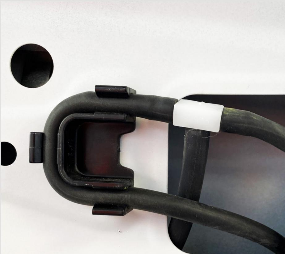
**8** Установите камеру с кронштейном в штатное место. Включите омыватель заднего стекла, убедитесь в отсутствии течей. Сборка авто осуществляется в обратной последовательности (при сборке убедитесь, что устанавливаемые накладки не пережимают шланг подачи жидкости к омывателю камеры).
