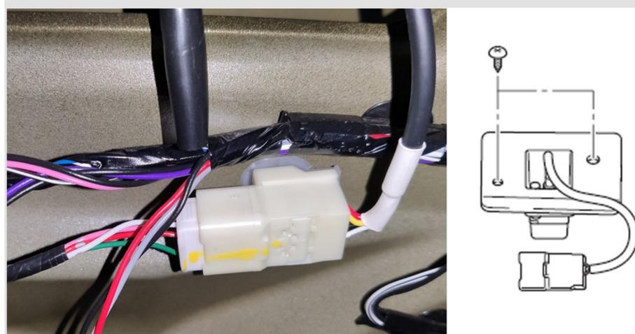
**4** Отверните два винта крепления камеры к кронштейну и **два винта** крепления провода к камере, затем отсоедините **провод** от камеры.
