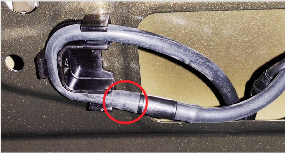
**7** Соедините тройник с омывателем камеры заднего вида шлангом, затем закрепите его стяжками на штатной проводке.
