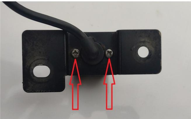
4. ТОНКИМ ОСТРЫМ ПРЕДМЕТОМ ПОДДЕНЬТЕ 2 ФИКСАТОРА КРЕПЛЕНИЯ ПРОВОДА К КАМЕРЕ И СНИМИТЕ ПРОВОД
