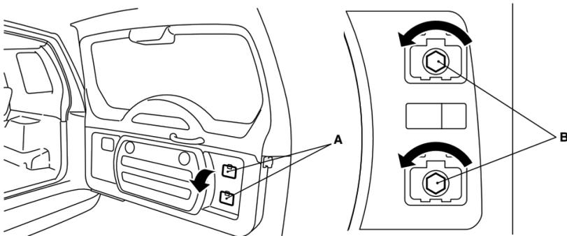
2. ОТКРОЙТЕ КРЫШКУ ЗАПАСНОГО КОЛЕСА, ОТСОЕДИНИТЕ РАЗЪЕМ КАМЕРЫ, ОСВОБОДИТЕ КРЕПЛЕНИЕ РАЗЪЕМА К КУЗОВУ, ВЫВЕРНИТЕ 2 ВИНТА И СНИМИТЕ КАМЕРУ ЗАДНЕГО ВИДА
