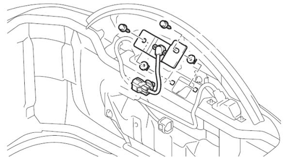
3. ОТВЕРНИТЕ 2 ВИНТА КРЕПЛЕНИЯ КАМЕРЫ К КРОНШТЕЙНУ
