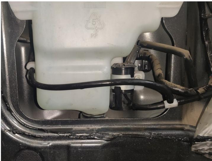
8. СОЕДИНИТЕ ТРОЙНИК С ОМЫВАТЕЛЕМ КАМЕРЫ ШЛАНГОМ, ЗАКРЕПИТЕ ЕГО СТЯЖКАМИ НА ШТАТНОЙ ПРОВОДКЕ.
