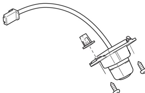
7. ОТВЕРНИТЕ 2 ВИНТА КРЕПЛЕНИЯ КАМЕРЫ К КРОНШТЕЙНУ
