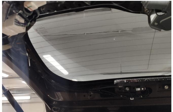
11. УСТАНОВИТЕ КАМЕРУ С КРОНШТЕЙНОМ В ШТАТНОЕ МЕСТО. ВКЛЮЧИТЕ ОМЫВАТЕЛЬ ЗАДНЕГО СТЕКЛА, УБЕДИТЕСЬ В ОТСУТСТВИИ ТЕЧЕЙ. СБОРКА АВТО ОСУЩЕСТВЛЯЕТСЯ В ОБРАТНОЙ ПОСЛЕДОВАТЕЛЬНОСТИ (ПРИ СБОРКЕ УБЕДИТЕСЬ ЧТО УСТАНАВЛИВАЕМЫЕ НАКЛАДКИ НЕ ПЕРЕЖИМАЮТ ШЛАНГ ПОДАЧИ ЖИДКОСТИ К ОМЫВАТЕЛЮ КАМЕРЫ). ПРИ НЕОБХОДИМОСТИ ОТРЕГУЛИРУЙТЕ ПОЛОЖЕНИЕ ШАРИКА ДЛЯ НАИЛУЧШЕГО ОМЫВАНИЯ КАМЕРЫ
