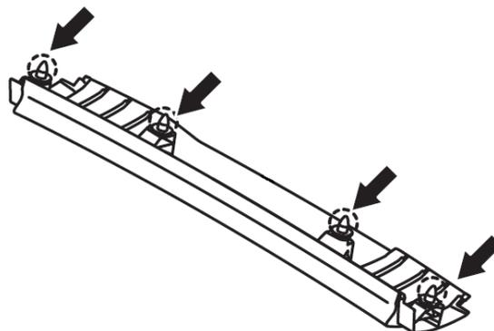
3. СНИМИТЕ РУЧКУ ЗАКРЫВАНИЯ ДВЕРИ БАГАЖНО-
