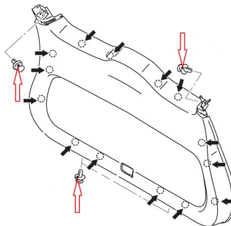
5. ОТВЕРНИТЕ 4 БОЛТА КРЕПЛЕНИЯ НАРУЖНОГО МОЛ-
