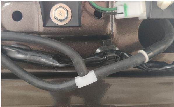
10. СОЕДИНИТЕ ТРОЙНИК С ОМЫВАТЕЛЕМ КАМЕРЫ ШЛАНГОМ, ЗАКРЕПИТЕ ЕГО СТЯЖКАМИ НА ШТАТНОЙ ПРОВОДКЕ
