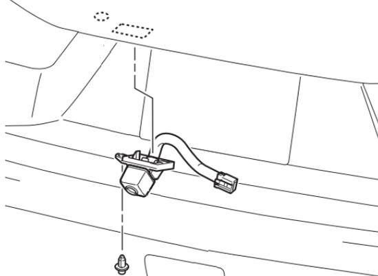
6. ДЛЯ АВТОМОБИЛЕЙ ДО 2017 ГОДА ВЫПУСКА ОСТРЫМ ПРЕДМЕТОМ ОСВОБОДИТЕ 2 ФИКСАТОРА И ОТСОЕДИНИТЕ ПРОВОД ОТ КАМЕРЫ. У АВТОМОБИЛЕЙ ПОСЛЕ 2017 ГОДА НЕОБХОДИМО РАЗОБРАТЬ РАЗЪЕМ ПРОВОДКИ КАМЕРЫ.
