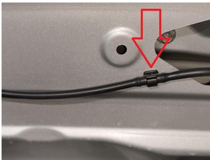
10. СОЕДИНИТЕ ТРОЙНИК С ОМЫВАТЕЛЕМ КАМЕРЫ ШЛАНГОМ, ЗАКРЕПИТЕ ЕГО СТЯЖКАМИ НА ШТАТНОЙ ПРОВОДКЕ
