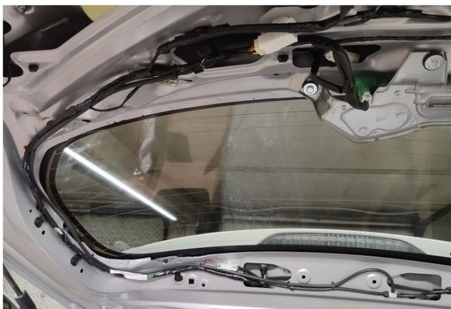
11. УСТАНОВИТЕ КАМЕРУ С КРОНШТЕЙНОМ В ШТАТНОЕ МЕСТО. ВКЛЮЧИТЕ ОМЫВАТЕЛЬ ЗАДНЕГО СТЕКЛА, УБЕДИТЕСЬ В ОТСУТСТВИИ ТЕЧЕЙ. СБОРКА АВТО ОСУЩЕСТВЛЯЕТСЯ В ОБРАТНОЙ ПОСЛЕДОВАТЕЛЬНОСТИ (ПРИ СБОРКЕ УБЕДИТЕСЬ ЧТО УСТАНАВЛИВАЕМЫЕ НАКЛАДКИ НЕ ПЕРЕЖИМАЮТ ШЛАНГ ПОДАЧИ ЖИДКОСТИ К ОМЫВАТЕЛЮ КАМЕРЫ). ПРИ НЕОБХОДИМОСТИ ОТРЕГУЛИРУЙТЕ ПОЛОЖЕНИЕ ШАРИКА ДЛЯ НАИЛУЧШЕГО ОМЫВАНИЯ КАМЕРЫ
