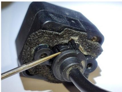
7. У АВТОМОБИЛЕЙ ПОСЛЕ 2017 ГОДА НЕОБХОДИМО РАЗОБРАТЬ РАЗЪЕМ ПРОВОДКИ КАМЕРЫ. С ПОМОЩЬЮ ОСТРОГО ПРЕДМЕТА ОСВОБОДИТЕ БОКОВОЙ ФИКСАТОР, А ЗАТЕМ ОСВОБОДИТЕ ФИКСАТОРЫ КАЖДОГО ПИНА И ВЫНЬТЕ ИХ ИЗ РАЗЪЕМА
