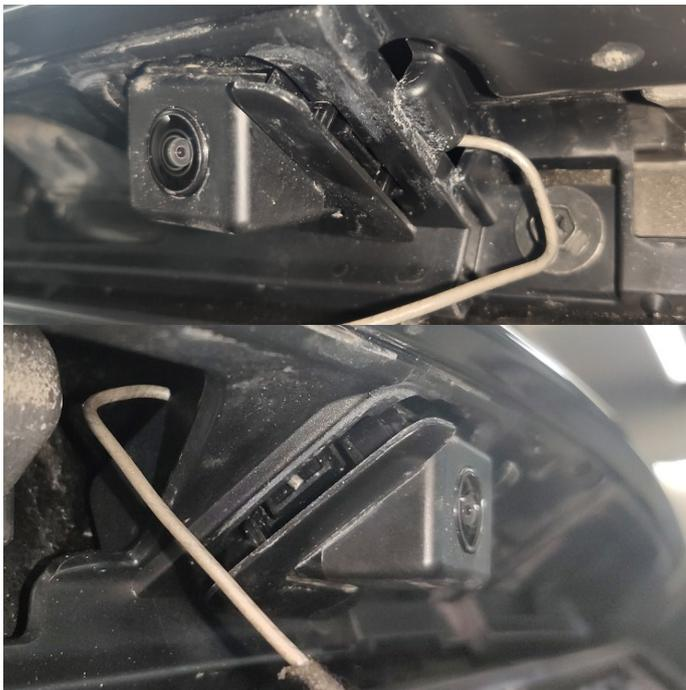
12. УСТАНОВИТЕ КАМЕРУ С КРОНШТЕЙНОМ В ШТАТНОЕ МЕСТО. СНИМИТЕ ШТАТНЫЙ СОЕДИНИТЕЛЬНЫЙ УГОЛОК И ЗАМЕНИТЕ ЕГО НА ТРОЙНИК. СОЕДИНИТЕ ШЛАНГ С ТРОЙНИКОМ, ЗАКРЕПИТЕ ШЛАНГ СТЯЖКАМИ НА ШТАТНОЙ ПРОВОДКЕ.
