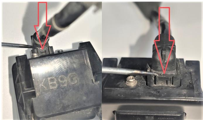
11. УСТАНОВИТЕ КАМЕРУ НА НОВЫЙ КРОНШТЕЙН, ЗАКРУТИТЕ 2 ВИНТА. В УПЛОТНИТЕЛЬНОЙ РЕЗИНКЕ ВТУЛКИ ПРОВОДКИ КАМЕРЫ ПРОДЕЛАЙТЕ ОТВЕРСТИЕ ПОД ШЛАНГ (НАПРИМЕР МОЖНО ПРОБИТЬ ЕГО ГОЛОВКОЙ НА 5 мм), ПРОЛОЖИТЕ ШЛАНГ ЧЕРЕЗ ОТВЕРСТИЕ И СОЕДИНИТЕ ЕГО С ОБРАТНЫМ КЛАПАНОМ
