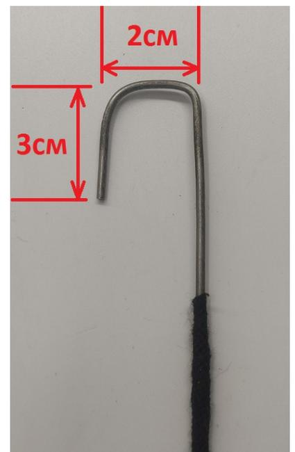
9. С ПОМОЩЬЮ ДАННОГО ПРИСПОСОБЛЕНИЯ НЕОБХОДИМО ОТОГНУТЬ 2 ЗАЩЕЛКИ КРЕПЛЕНИЯ КАМРЫ ЗАДНЕГО ВИДА И СНЯТЬ ЕЕ
