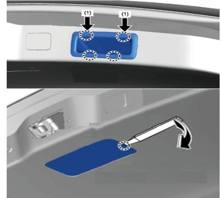
4. СНИМИТЕ КНОПКУ ЗАКРЫВАНИЯ КРЫШКИ
