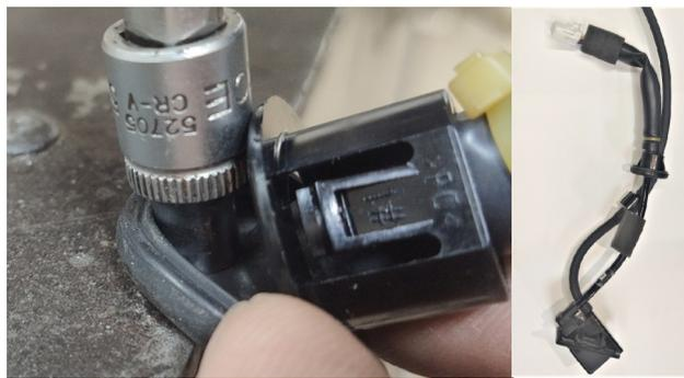
13. ВКЛЮЧИТЕ ОМЫВАТЕЛЬ ЗАДНЕГО СТЕКЛА, УБЕДИТЕСЬ В ОТСУТСТВИИ ТЕЧЕЙ. СБОРКА АВТО ОСУЩЕСТВЛЯЕТСЯ В ОБРАТНОЙ ПОСЛЕДОВАТЕЛЬНОСТИ (ПРИ СБОРКЕ УБЕДИТЕСЬ ЧТО УСТАНАВЛИВАЕМЫЕ НАКЛАДКИ НЕ ПЕРЕЖИМАЮТ ШЛАНГ ПОДАЧИ ЖИДКОСТИ К ОМЫВАТЕЛЮ КАМЕРЫ). ПРИ НЕОБХОДИМОСТИ ОТРЕГУЛИРУЙТЕ ПОЛОЖЕНИЕ ШАРИКА ДЛЯ НАИЛУЧШЕГО ОМЫВАНИЯ КАМЕРЫ
