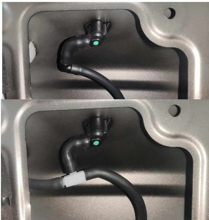
10. С ПОМОЩЬЮ ОСТРОГО ПРЕДМЕТА ОТОГНИТЕ 2 ФИКСАТОРА КРЕПЛЕНИЯ ПРОВОДА К КАМЕРЕ И ОТСОЕДИНИТЕ ПРОВОД. ОТКРУТИТЕ 2 ВИНТА КРЕПЛЕНИЯ КАМЕРЫ К КРОНШТЕЙНУ.
