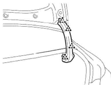
3. ОТВЕРНИТЕ ПО 4 ГАЙКИ, ОТСОЕДИНИТЕ РАЗЪЕМ И СНИМИТЕ ЛЕВЫЙ И ПРАВЫЙ ФОНАРИ ДВЕРИ БАГАЖНОГО ОТДЕЛЕНИЯ
