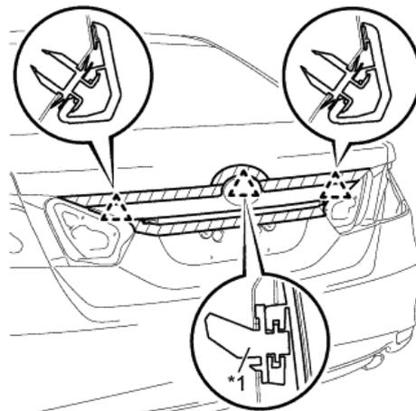
6. ОСВОБОДИТЕ 2 ЗАХВАТА И СНИМИТЕ ЗАДНЮЮ КАМЕРУ В СБОРЕ
