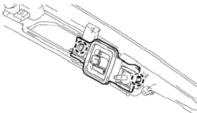
7. ОТВЕРНИТЕ ВИНТЫ КРЕПЛЕНИЯ КАМЕРЫ К ШТАТНОМУ КРОНШТЕЙНУ И УСТАНОВИТЕ ЕЕ НА НОВЫЙ КРОНШТЕЙН. НЕ ПЫТАЙТЕСЬ СНЯТЬ ШЛАНГ С КРОНШТЕЙНА — ВЫ МОЖЕТЕ ЕГО СЛОМАТЬ!
