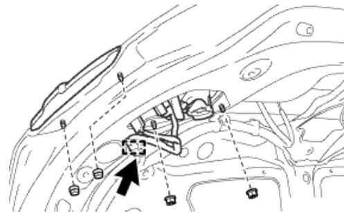
4. ОТВЕРНИТЕ 5 ГАЕК НАРУЖНОЙ НАКЛАДКИ ДВЕРИ БАГАЖНОГО ОТДЕЛЕНИЯ, ОТСОЕДИНИТЕ РАЗЪЕМЫ КНОПКИ ОТКРЫВАНИЯ БАГАЖНОГО ОТДЕЛЕНИЯ И КАМЕРЫ ЗАДНЕГО ВИДА
