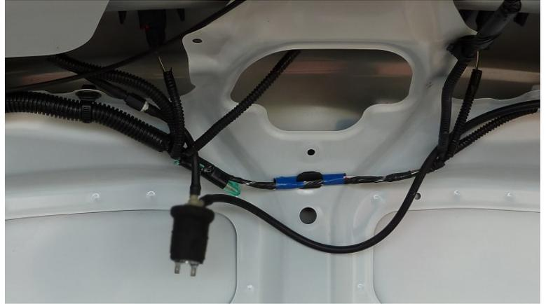
16. ПОДКЛЮЧИТЕ ПРОВОДА ОБРАТНОГО КЛАПАНА К ЛАМПЕ ЗАДНЕГО ХОДА НА ПРАВОМ ФОНАРЕ (ПОЛЯРНОСТЬ ПОДКЛЮЧЕНИЯ ЗНАЧЕНИЯ НЕ ИМЕЕТ)
