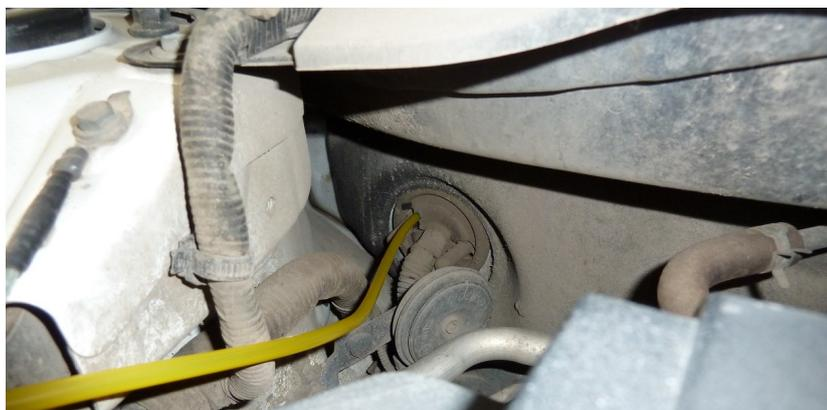
14. ЗАКРЕПИТЕ ШЛАНГ НА ПЕТЛЕ ОТКРЫВАНИЯ БАГАЖНИКА ПЛАСТИКОВЫМИ СТЯЖКАМИ. **ОСТАВЬТЕ У ШЛАНГА СЛАБИНУ, НЕОБХОДИМУЮ ДЛЯ ОТКРЫВАНИЯ-ЗАКРЫВАНИЯ КРЫШКИ БАГАЖНИКА.**
