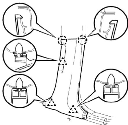
10. СНИМИТЕ ПЛАСТИКОВУЮ НАКЛАДКУ ПАНЕЛИ ПРИБОРОВ ПОД ПЕРЧАТОЧНЫМ ЯЩИКОМ
