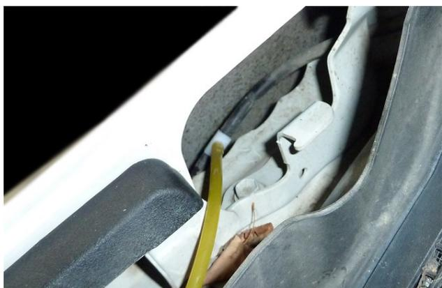
13. ПРОЛОЖИТЕ ШЛАНГ ОТ ТРОЙНИКА ЧЕРЕЗ ШТАТНЫЙ УПЛОТНИТЕЛЬ МОТОРНОГО ОТСЕКА, ДАЛЕЕ ПО ПОРОГУ К КРЫШКЕ БАГАЖНИКА.
