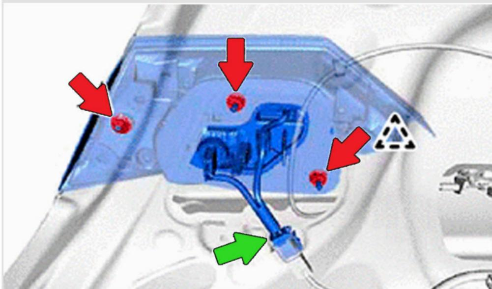
**4** Снимите **нижнюю наружную накладку** двери багажного отделения.
