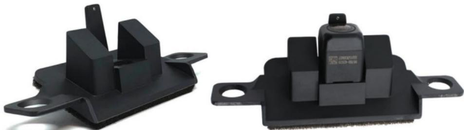
**8** Установите камеру с кронштейном в штатное место и, придерживая изнутри, прижмите её наружной накладкой двери багажного отделения. Заверните 2 винта и установите нижнюю наружную накладку двери багажного отделения.
