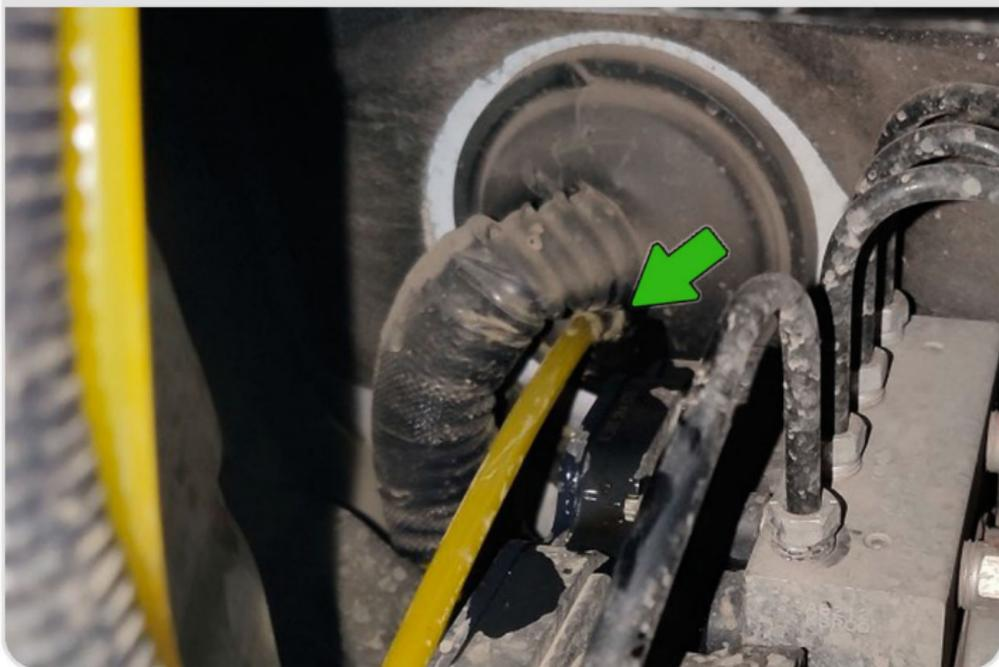
**15** Закрепите шланг на петле открывания багажного отделения пластиковыми стяжками.
