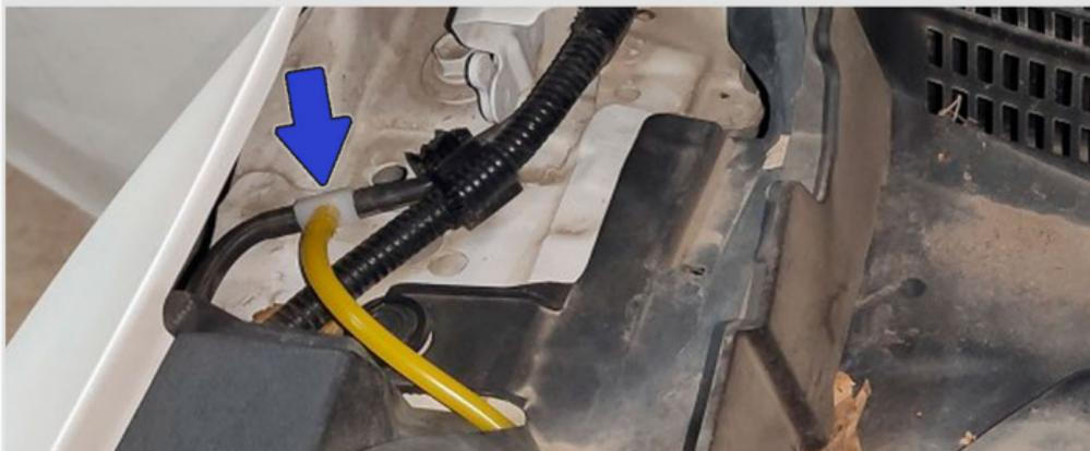
**14** Проложите шланг от тройника через **штатный уплотнитель** моторного отсека, далее по порогу к крышке багажника.
