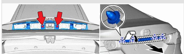
**6** Освободите **2 захвата** и **снимите** заднюю камеру в **сборе**, отсоедините **разъем**.
