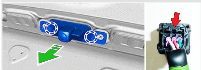
**7** Отверните винты крепления камеры к штатному кронштейну и установите её на новый кронштейн.
