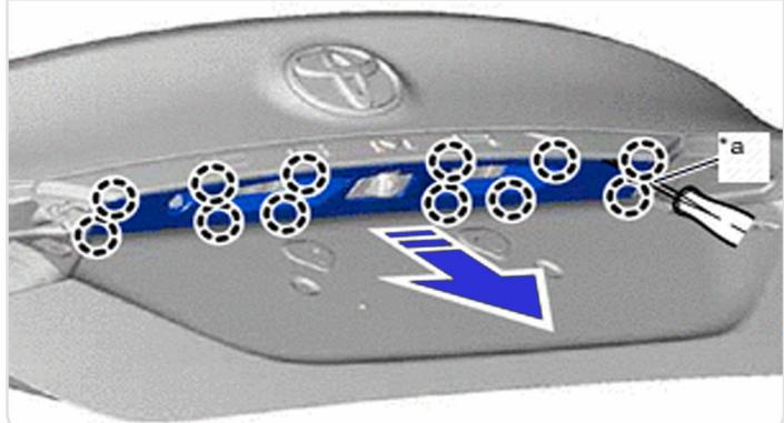
**5** Выверните **2 винта**, освободите **4 фиксатора** и снимите наружную накладку двери багажного отделения.
