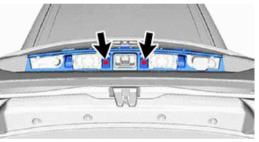
7. ОТВЕРНИТЕ ВИНТЫ КРЕПЛЕНИЯ КАМЕРЫ К ШТАТНОМУ КРОНШТЕЙНУ И УСТАНОВИТЕ ЕЕ НА НОВЫЙ КРОНШТЕЙН. НЕ ПЫТАЙТЕСЬ СНЯТЬ ШЛАНГ С **КРОНШТЕЙНА** — ВЫ МОЖЕТЕ ЕГО СЛОМАТЬ!
