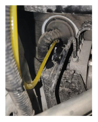
15. ЗАКРЕПИТЕ ШЛАНГ НА ПЕТЛЕ ОТКРЫВАНИЯ БАГАЖНИКА ПЛА-СТИКОВЫМИ СТЯЖКАМИ. ОСТАВЬТЕ У ШЛАНГА СЛАБИНУ, НЕОБХО-ДИМУЮ ДЛЯ ОТКРЫВАНИЯ-ЗАКРЫВАНИЯ КРЫШКИ БАГАЖНИКА.
