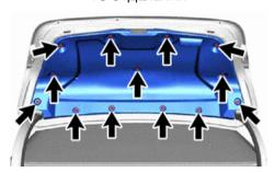
4. СНИМИТЕ НИЖНЮЮ НАРУЖНУЮ НАКЛАДКУ ДВЕРИ БАГАЖНОГО ОТДЕЛЕНИЯ
