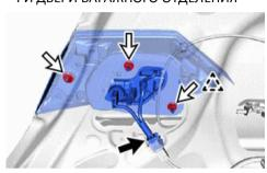
5. ВЫВЕРНИТЕ 2 ВИНТА, ОСВОБОДИТЕ 4 ФИКСАТОРА И СНИМИТЕ НАРУЖНУЮ НАКЛАДКУ ДВЕРИ БАГАЖНОГО ОТДЕЛЕНИЯ
