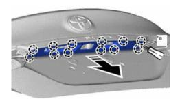
6. ОСВОБОДИТЕ 2 ЗАХВАТА И СНИМИТЕ ЗАДНЮЮ КАМЕРУ В СБОРЕ, ОТСОЕДИНИТЕ РАЗЪЕМ
