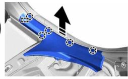
10. СНИМИТЕ ОБЛИЦОВОЧНУЮ НАКЛАДКУ СРЕДНЕЙ СТОЙКИ КУЗОВА
