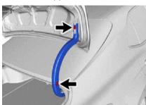
3. ОТВЕРНИТЕ ПО 4 ГАЙКИ, ОТСОЕДИНИТЕ РАЗЪЕМ И СНИМИТЕ ЛЕВЫЙ И ПРАВЫЙ ФОНА-РИ ДВЕРИ БАГАЖНОГО ОТДЕЛЕНИЯ
