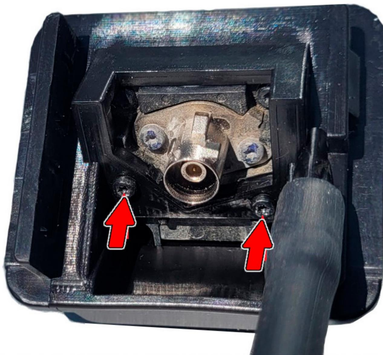
**8** В уплотнительной резинке проводки камеры сделайте **отверстие** под шланг (можно пробить его головкой на 5 мм либо сделать надрез 5 мм канцелярским ножом). Проложите шланг через отверстие и соедините его с обратным клапаном. Установите камеру с омывателем в штатное место. Протяните шланг по штатной проводке к верхней части крышки багажника, закрепите шланг стяжками на штатной проводке.
