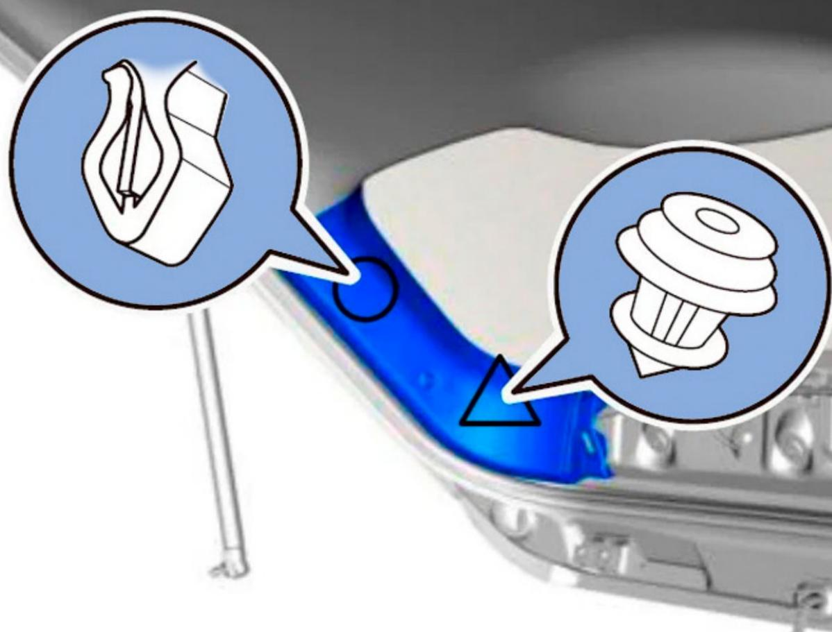
**3** Откройте **заглушку** самореза крепления нижней обивки двери багажного отделения, затем открутите **три самореза** крепления нижней обивки двери багажного отделения.
