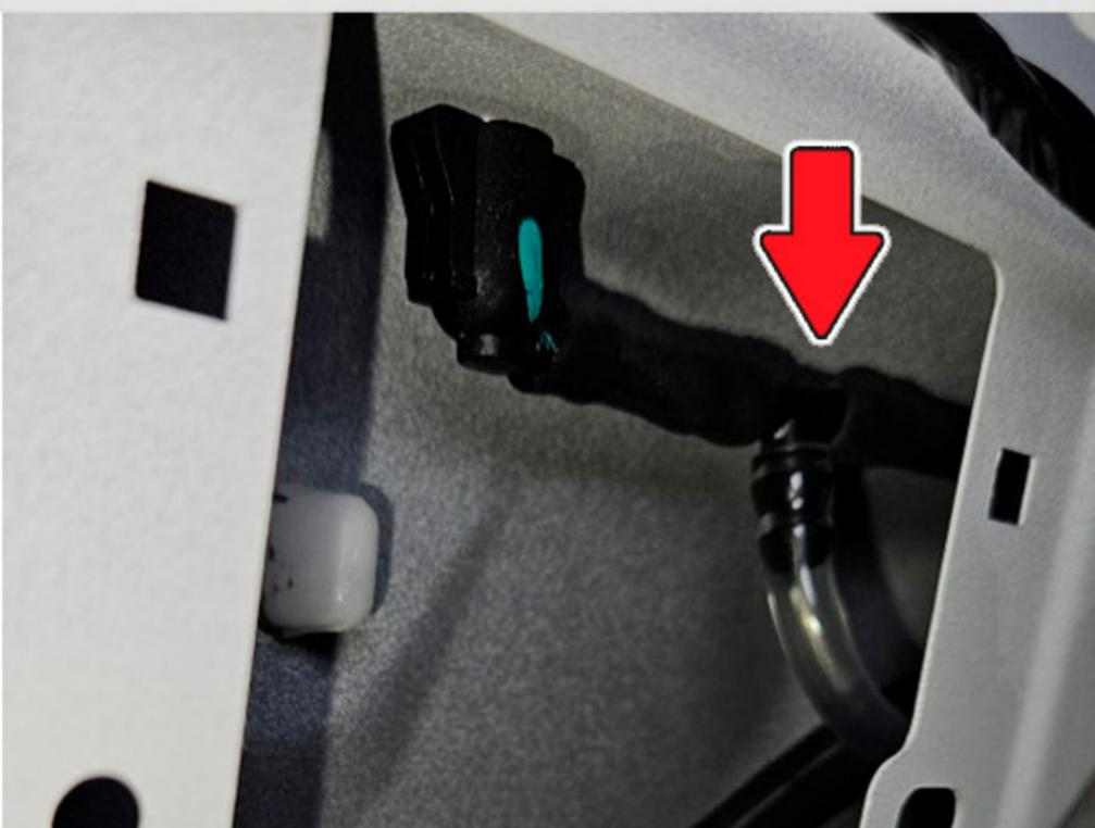
**10** Включите омыватель заднего стекла, убедитесь в отсутствии течей. Сборка авто осуществляется в обратной последовательности (при сборке убедитесь, что устанавливаемые накладки не пережимают шланг подачи жидкости к омывателю камеры).
