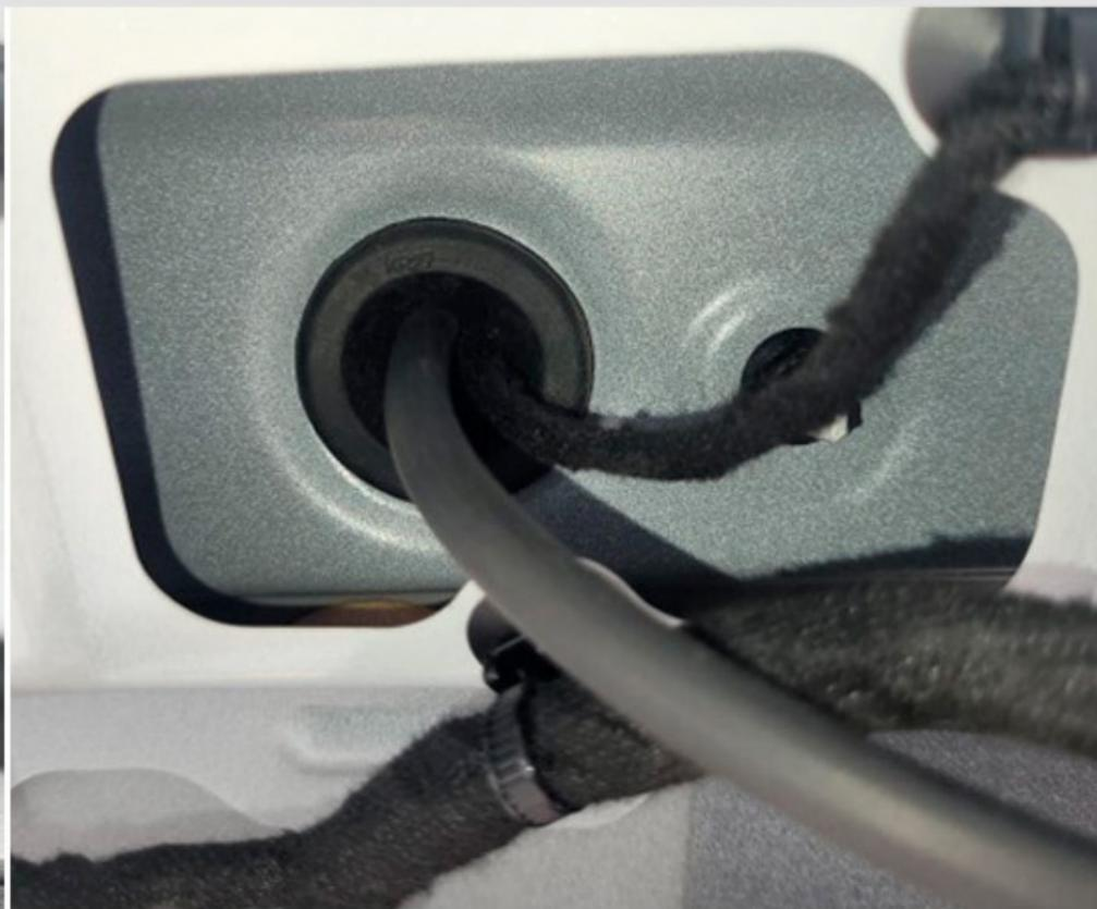
**9** Снимите шланг со штатной форсунки омывателя заднего стекла и установите **тройник** из комплекта, соединив его с форсункой куском шланга. Соедините тройник со шлангом от омывателя камеры. Соедините штатный шланг с тройником.
