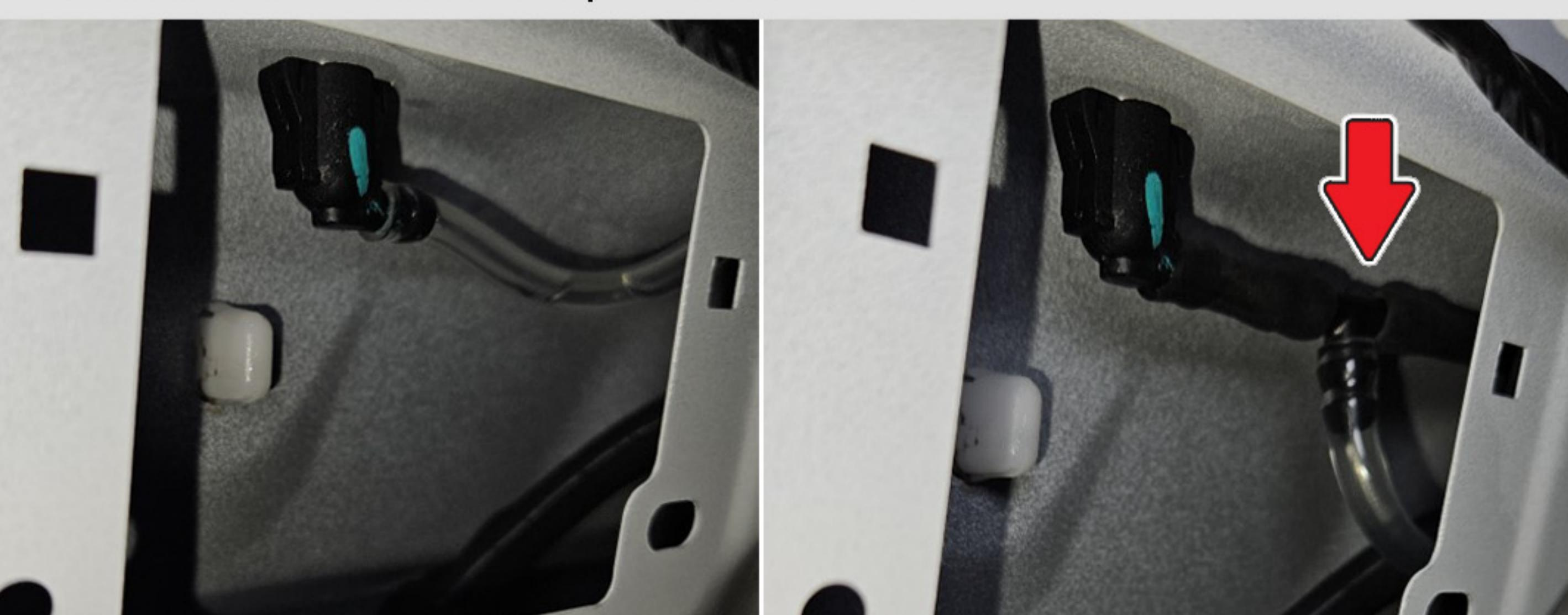
**10** Включите омыватель заднего стекла, убедитесь в отсутствии течи. Сборка авто осуществляется в обратной последовательности (при сборке убедитесь, что устанавливаемые накладки не пережимают шланг подачи жидкости к омывателю камеры).
