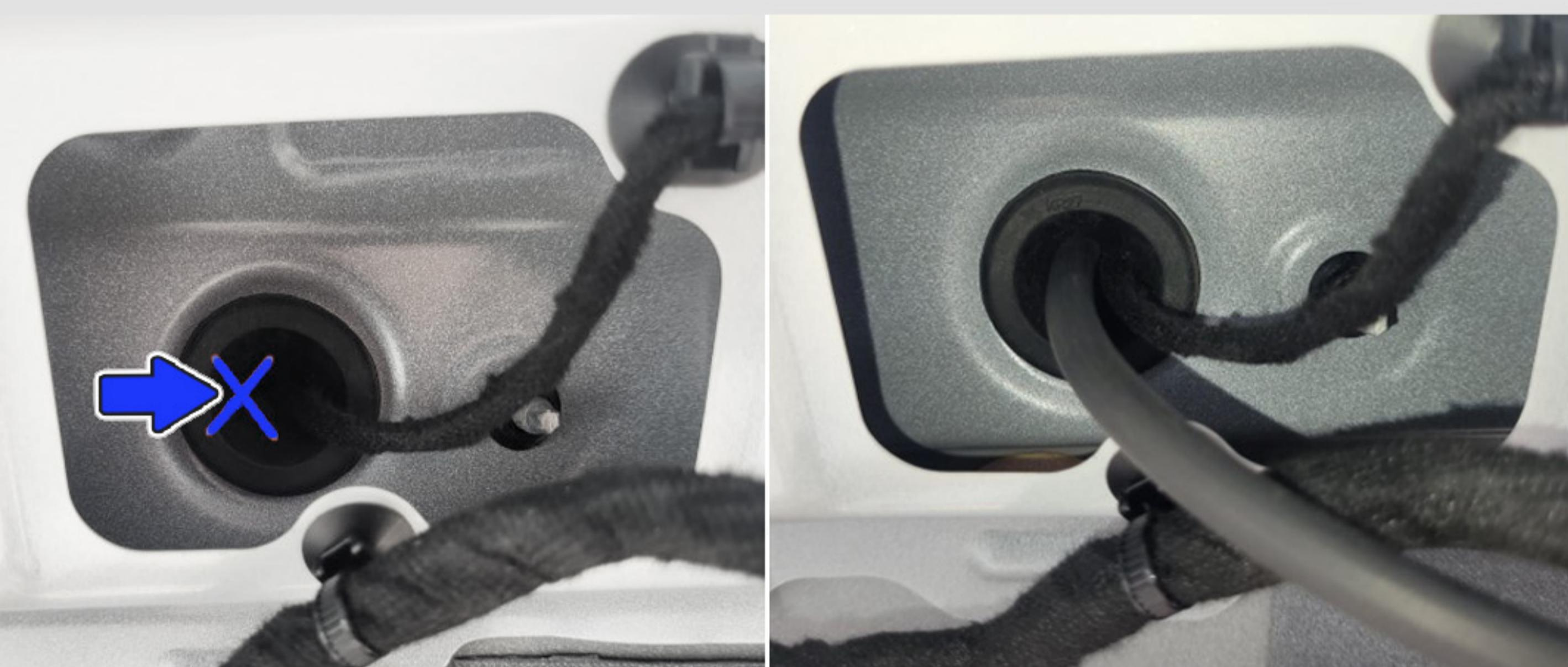
**9** Снимите шланг со штатной форсунки омывателя заднего стекла и установите **тройник** из комплекта, соединив его с форсункой куском шланга. Соедините тройник со шлангом от омывателя камеры. Соедините штатный шланг с тройником.
