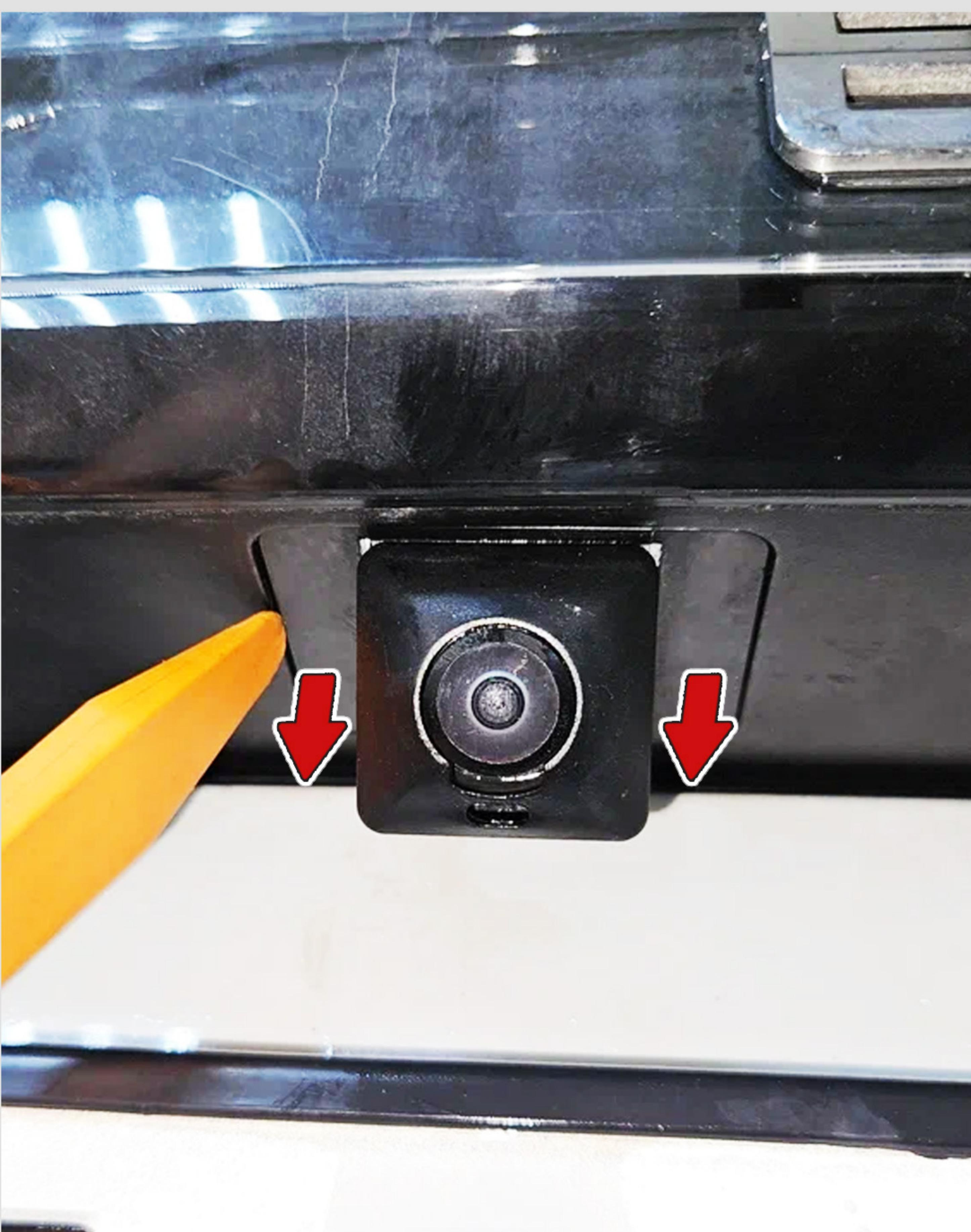
**6** Открутите **два самореза TORX6** крепления камеры к штатному кронштейну и снимите её.
