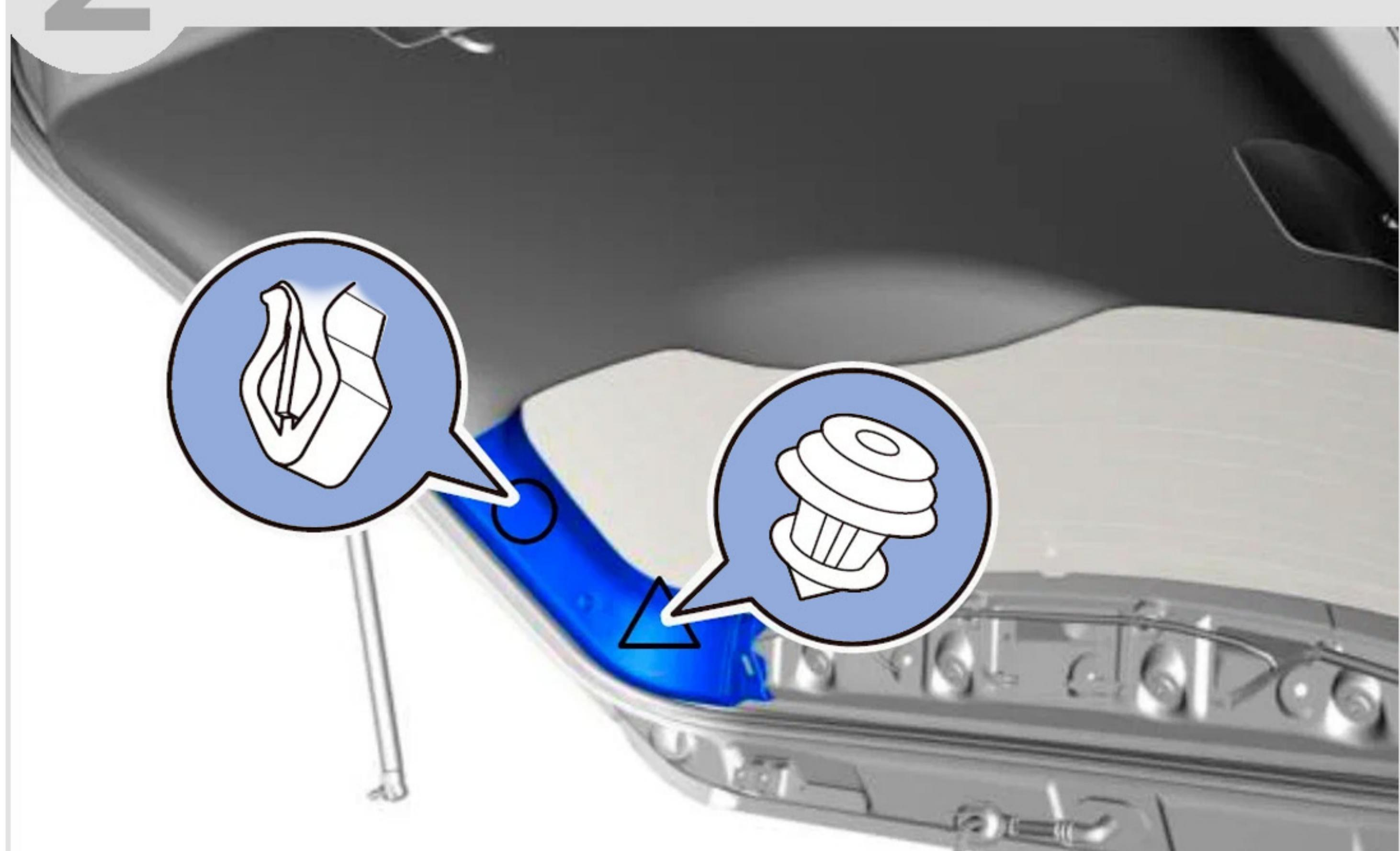
3 Откройте **заглушку** самореза крепления нижней обивки двери багажного отделения, затем открутите **три самореза** крепления нижней обивки двери багажного отделения.
