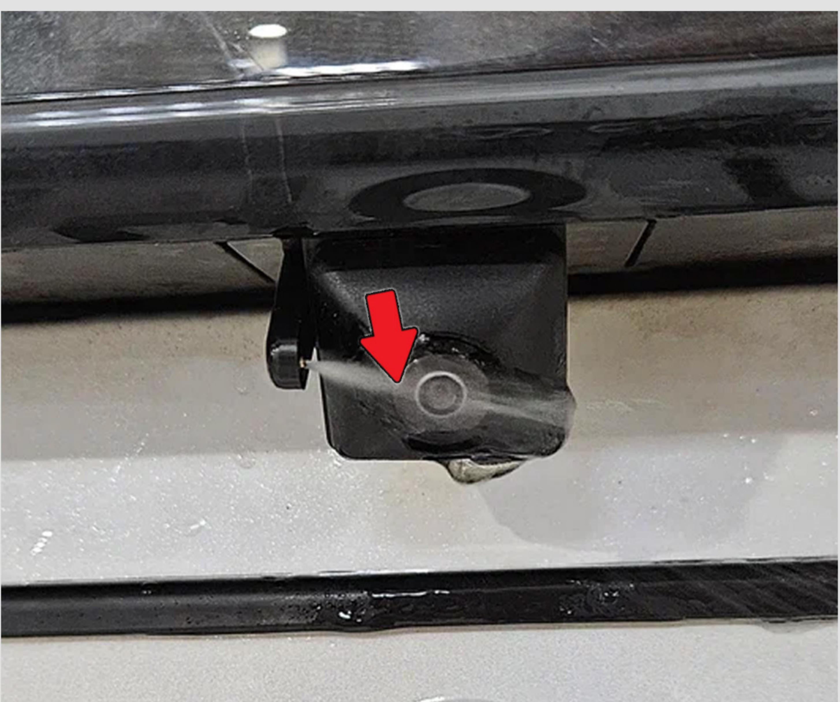
**11** Для регулировки форсунки используйте кнопку - гвоздь (в комплекте), согнув её плоскогубцами, как это показано на рисунке.
