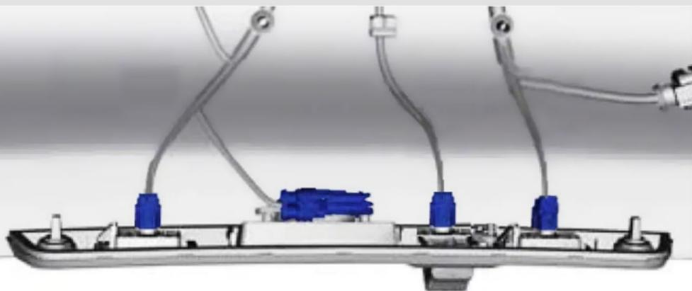
**7** Освободите фиксаторы и снимите кронштейн камеры заднего вида. Отверните 2 винта TORX6 крепления камеры к штатному кронштейну и установите камеру на новый кронштейн.
