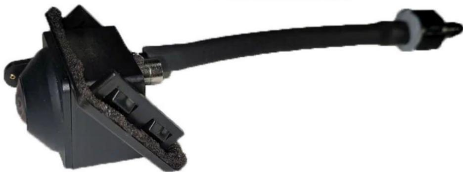
**8** Установите камеру с омывателем в штатное место, соедините шланг с обратным клапаном, закрепите накладку на двери багажного отделения.
