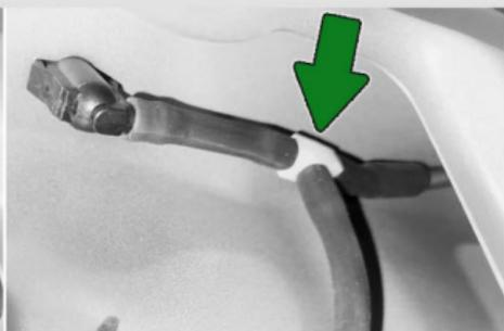
**10** Включите омыватель заднего стекла, убедитесь в отсутствии течей. Сборка авто осуществляется в обратной последовательности (при сборке убедитесь, что устанавливаемые накладки не пережимают шланг подачи жидкости к омывателю камеры).
