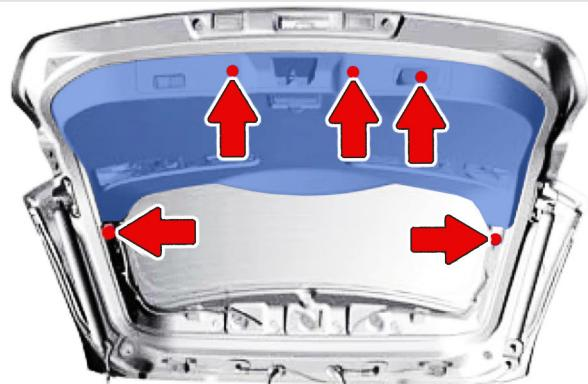
**5** Открутите **два самореза** наружной накладки двери багажного отделения.
