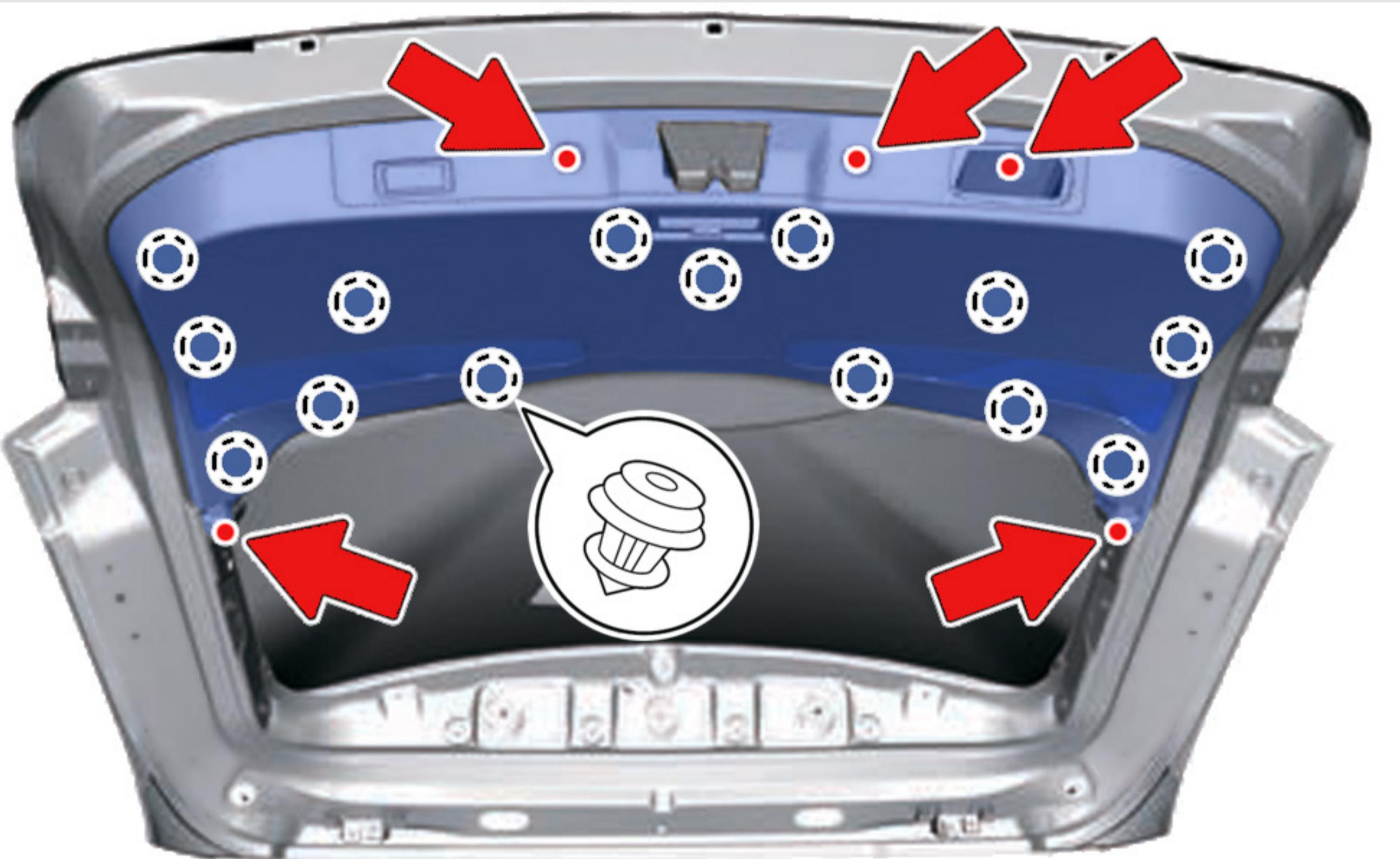
**5** Оттягивая **камеру** свободите фиксаторы изнутри и снимите камеру заднего вида.
