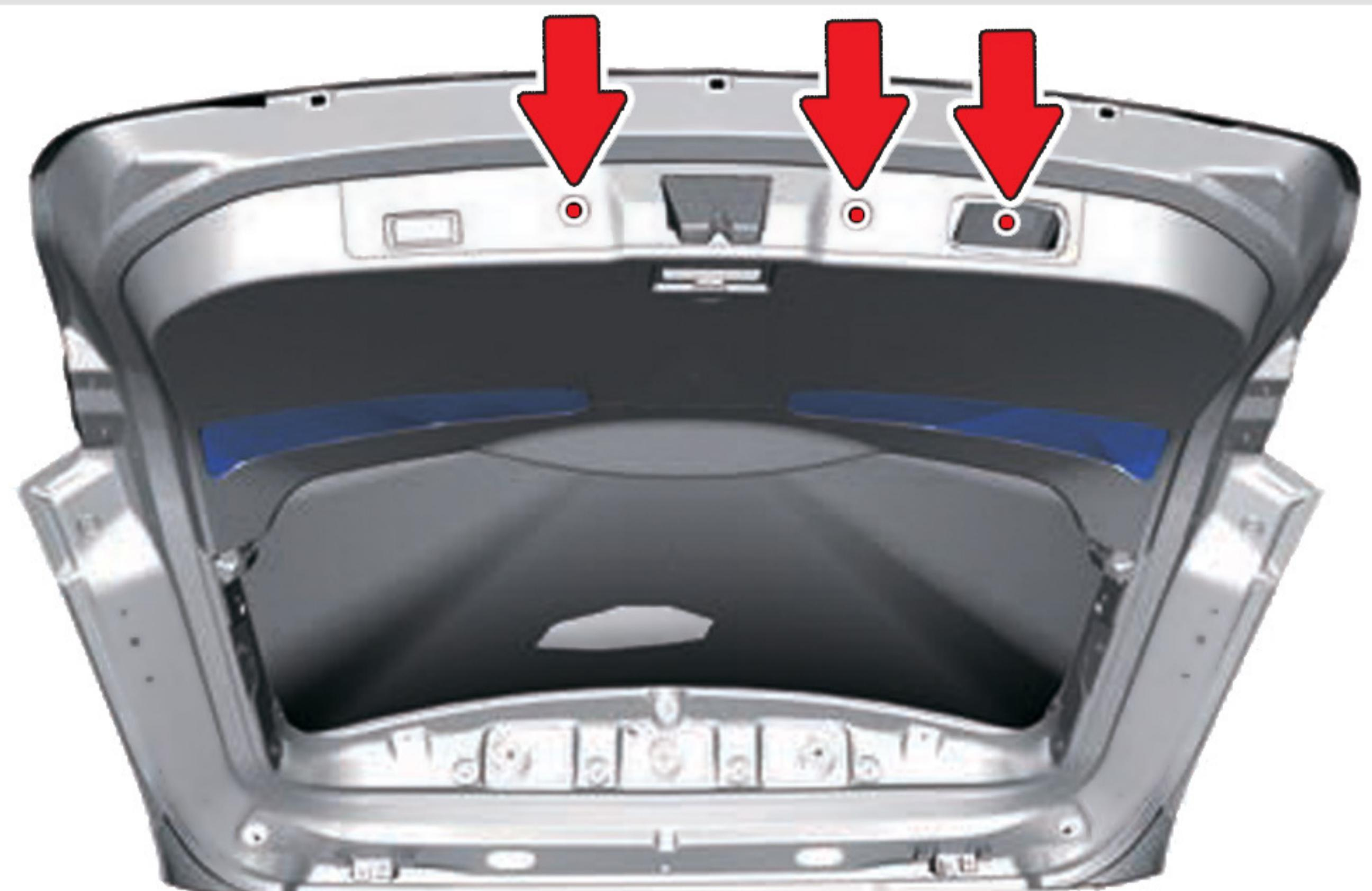
**4** Открутите **пять саморезов** крепления нижней обивки двери багажного отделения. Снимите **нижнюю обивку двери**, отстегнув клипсы
