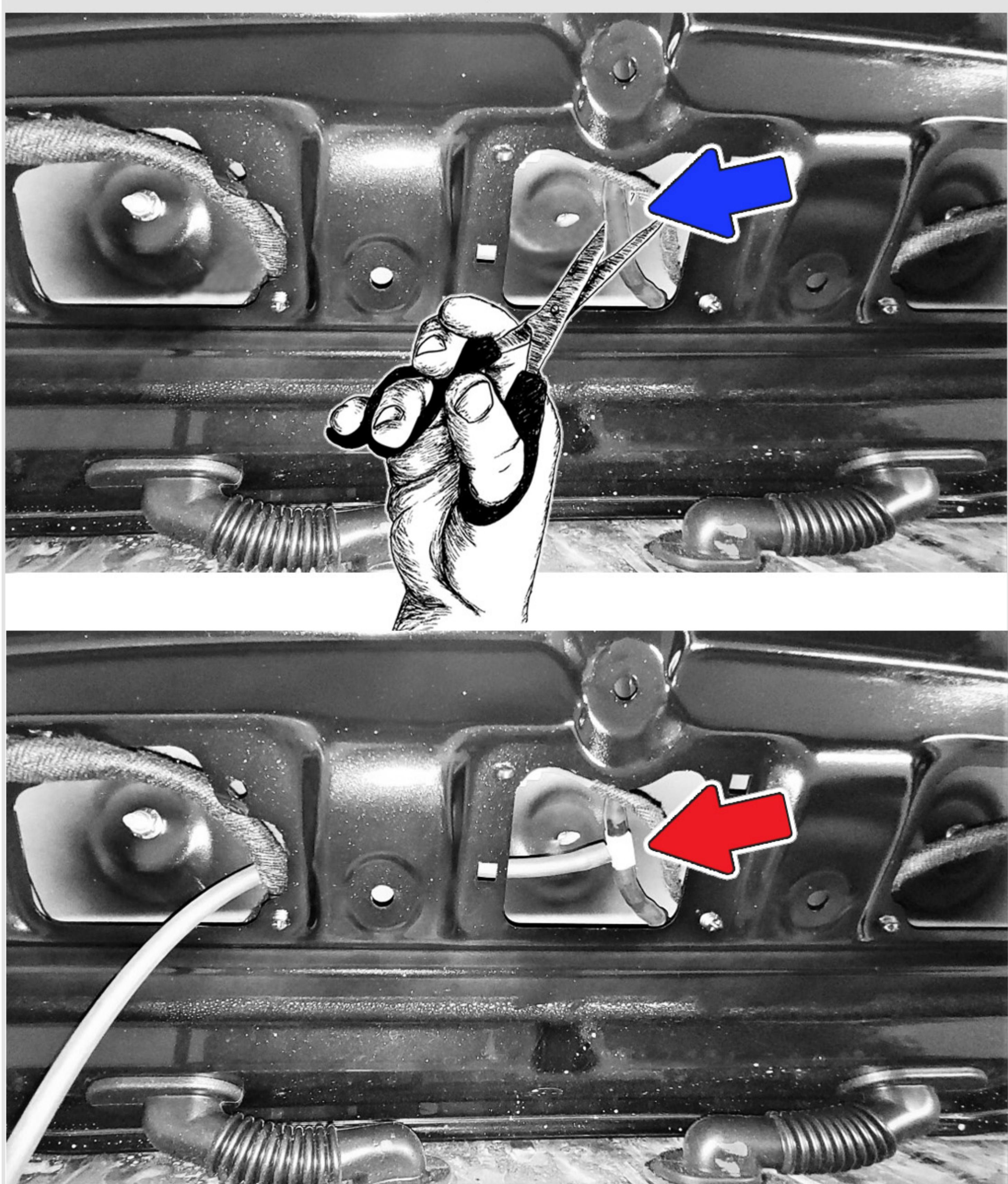
**8** Включите омыватель заднего стекла, убедитесь в отсутствии течи. Сборка авто осуществляется в обратной последовательности (при сборке убедитесь, что устанавливаемые накладки не пережимают шланг подачи жидкости к омывателю камеры).
