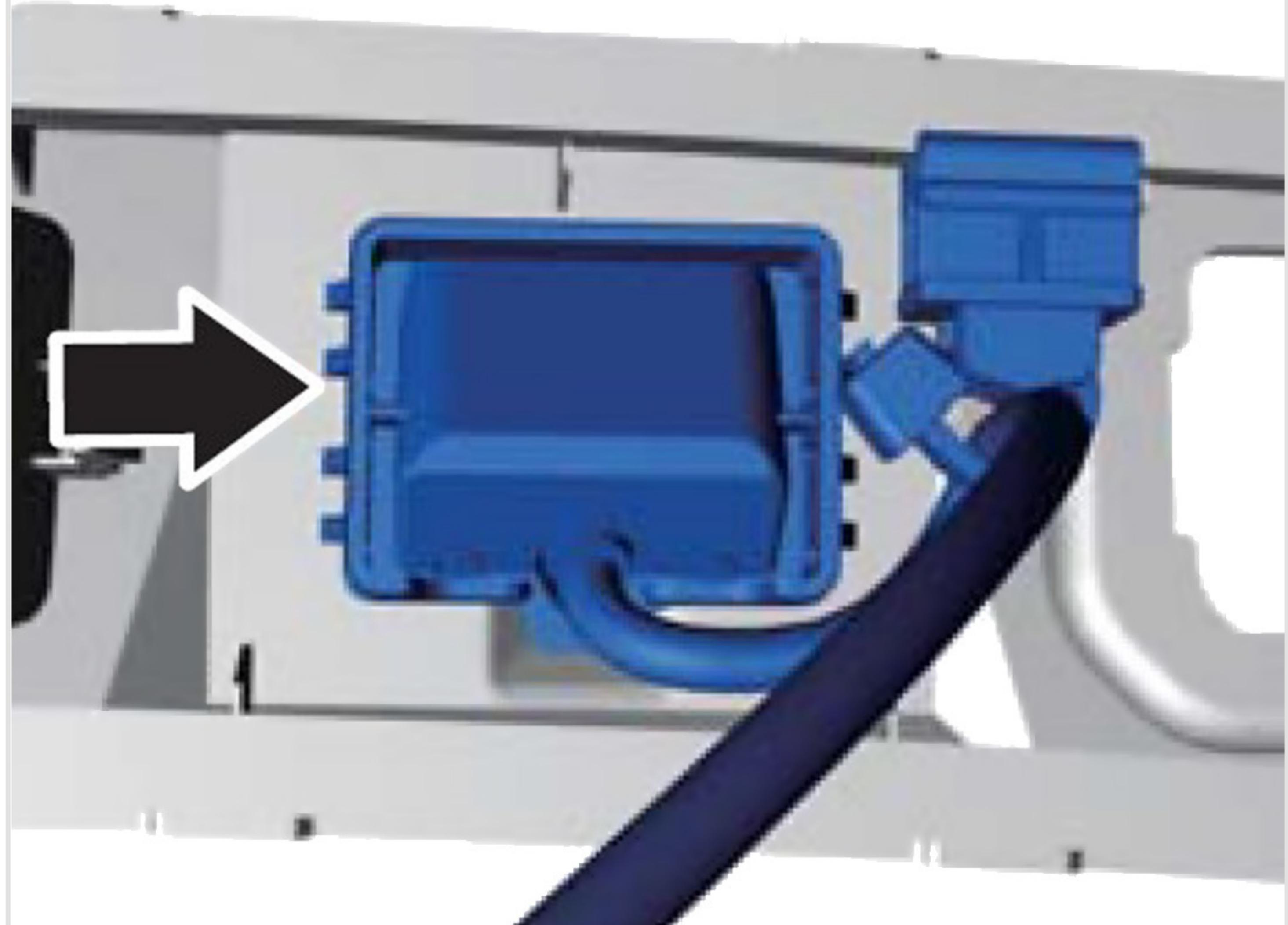
**6** Отверните **2 винта TORX6** крепления камеры к штатному кронштейну и установите камеру на новый кронштейн. Установите новый кронштейн с камерой в штатное место.
