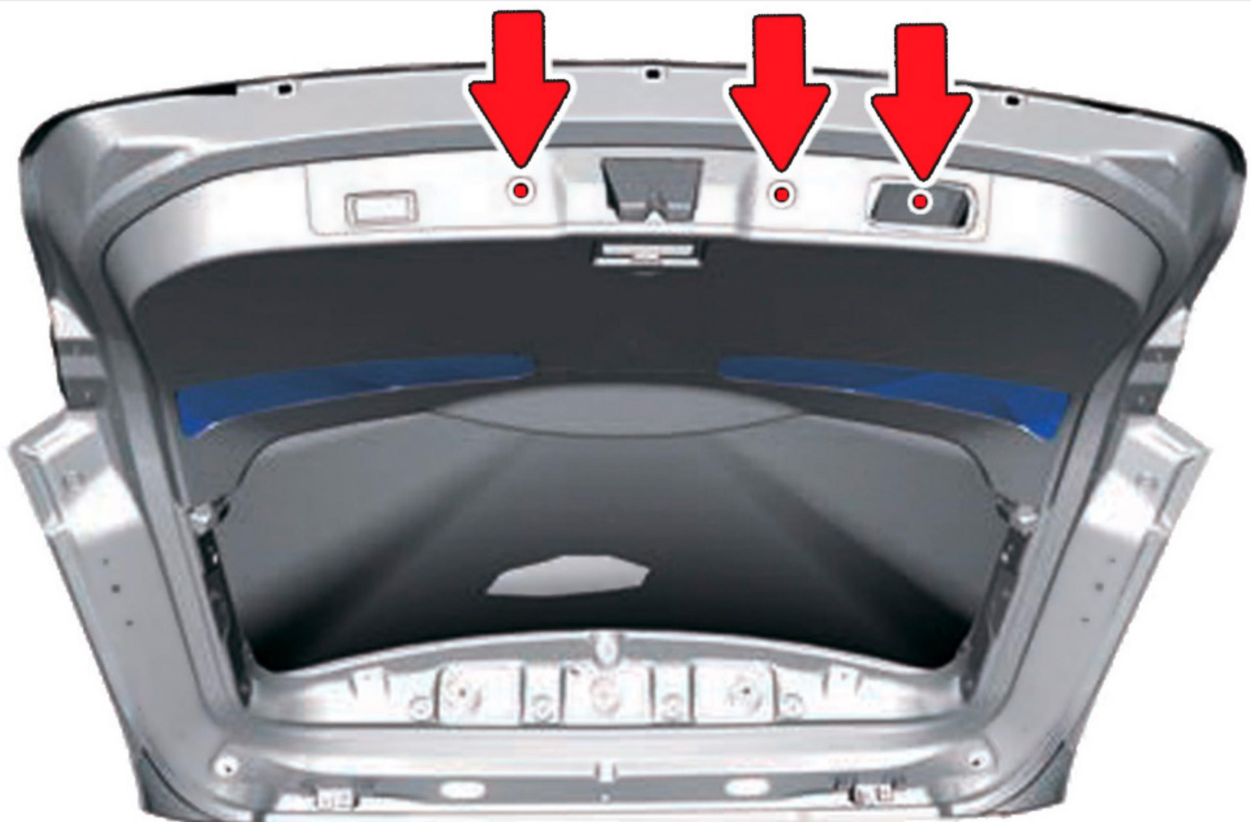
**4** Открутите **пять саморезов** крепления нижней обивки двери багажного отделения. Снимите **нижнюю обивку двери**, отстегнув клипсы
