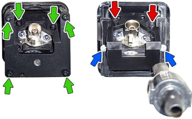
**9** В уплотнительной резинке проводки камеры проделайте отверстие под шланг (можно пробить его головкой на 5 мм или прорезать канцелярским ножом), проложите шланг через отверстие к месту установки камеры. Соедините шланг с обратным клапаном и установите камеру с омывателем на штатное место.
