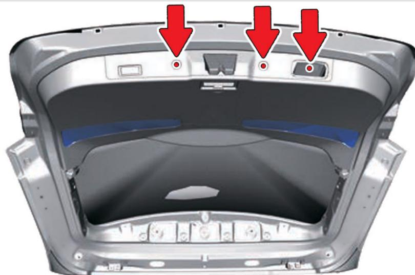
**4** Открутите **пять саморезов** крепления нижней обивки двери багажного отделения. Снимите **нижнюю обивку** двери, отстегнув клипсы.
