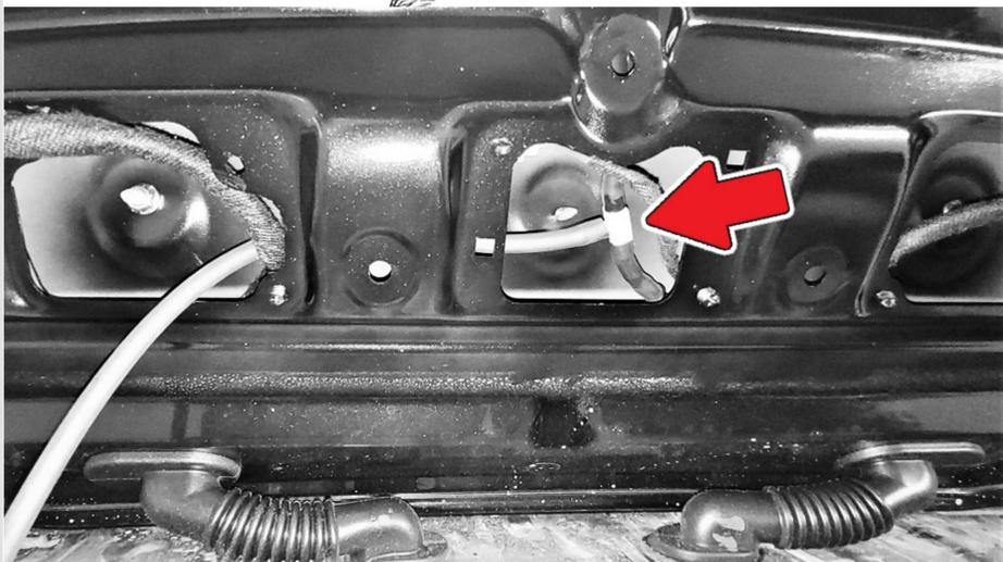
**11** Включите омыватель заднего стекла, убедитесь в отсутствии течей. Сборка авто осуществляется в обратной последовательности (при сборке убедитесь, что устанавливаемые накладки не пережимают шланг подачи жидкости к омывателю камеры).
