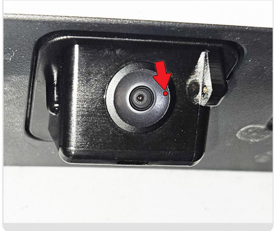
**12** Для регулировки форсунки используйте кнопку-гвоздь (в комплекте), согнув её плоскогубцами, как это показано на рисунке.
