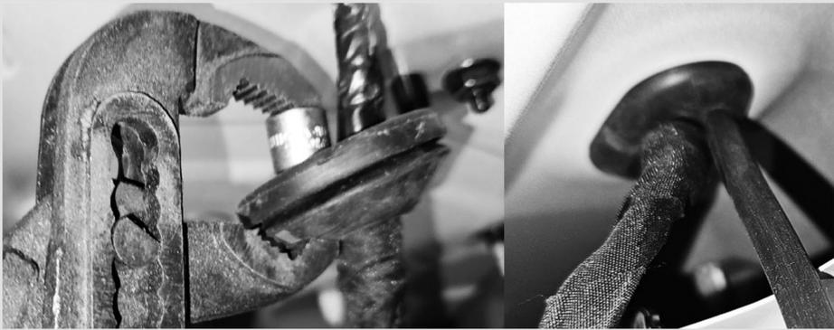
**10** Протяните шланг к верхней части двери багажного отделения, закрепите шланг стяжками на штатной проводке.
