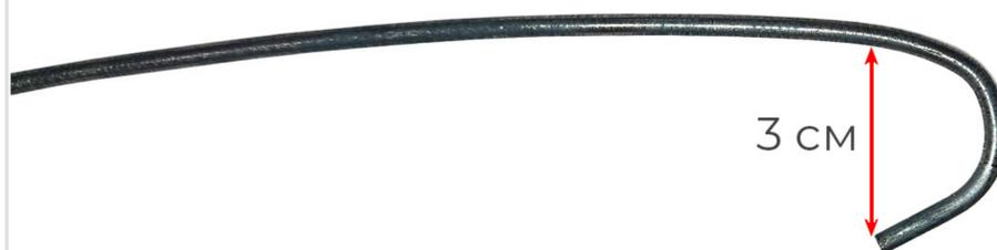
**7** С помощью данного приспособления отогните сначала **дальнюю**, а затем **ближнюю** к нише фонаря защёлку крепления камеры заднего вида и снимите её. Отсоедините разъём камеры.
