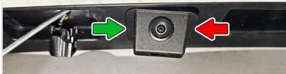
**8** Отверните **6 винтов TORX6** крепления камеры к штатному кронштейну. Закрепите камеру на внутренней части нового кронштейна **двумя штатными винтами**. **Двумя винтами из комплекта** прикрутите наружную часть кронштейна с омывателем.
