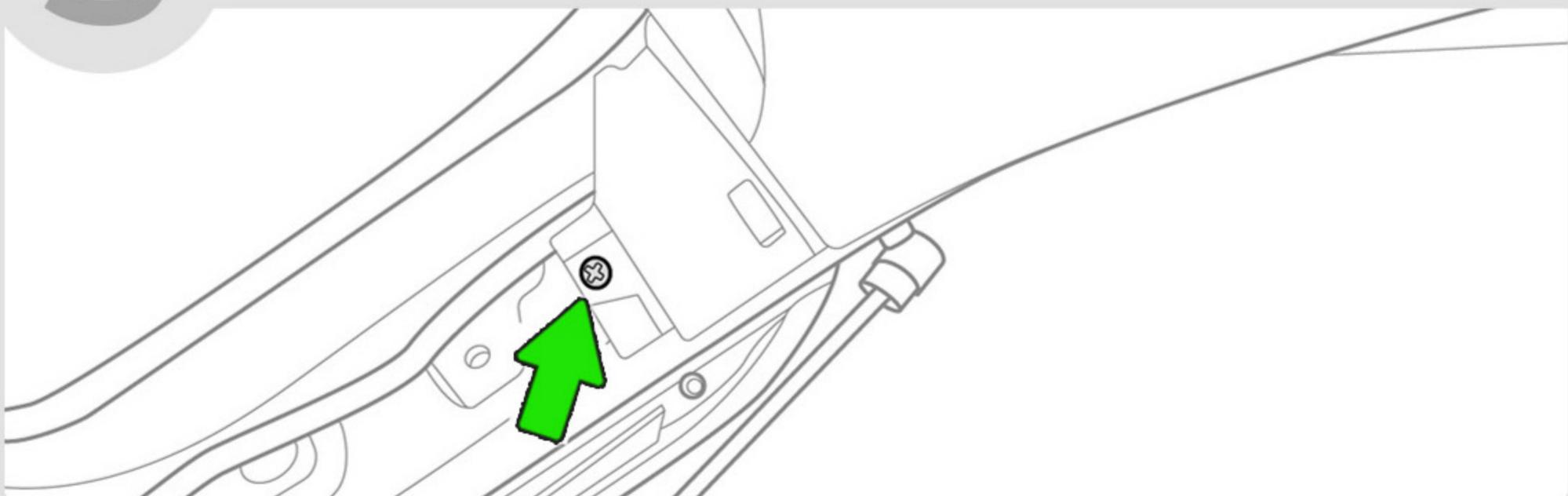
**4** Снимите заглушки в кармашке и в нижней части облицовки двери багажного отделения, выверните 3 самореза и снимите нижнюю облицовку двери багажного отделения.
