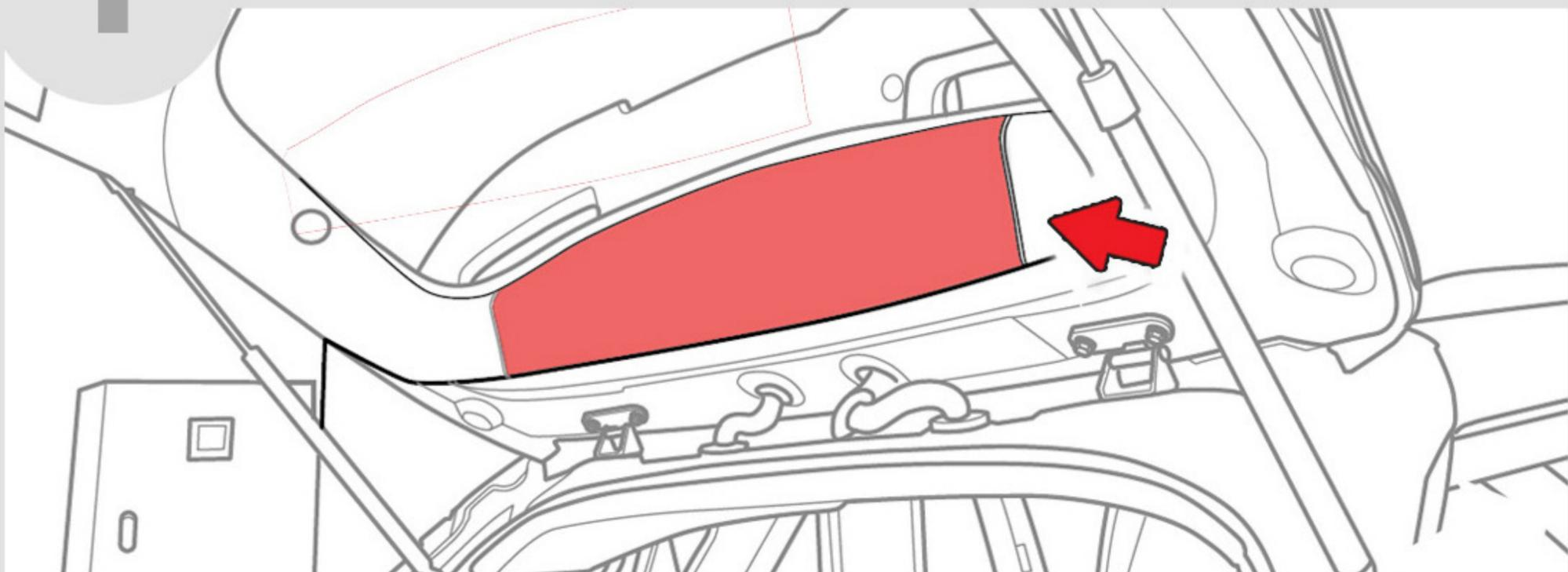
**2** Выверните **2 самореза** и снимите левую и правую боковые облицовочные панели двери багажного отделения.
