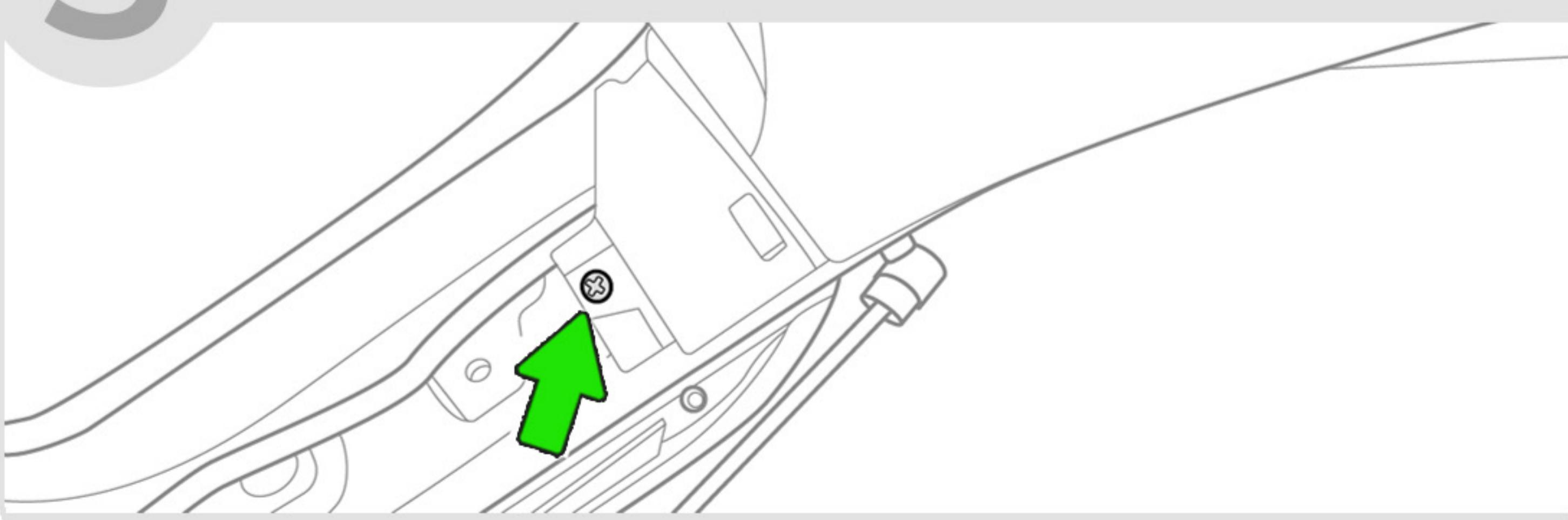
4 Снимите заглушки в кармашке и в нижней части облицовки двери багажного отделения, выверните 3 самореза и снимите нижнюю облицовку двери багажного отделения.
