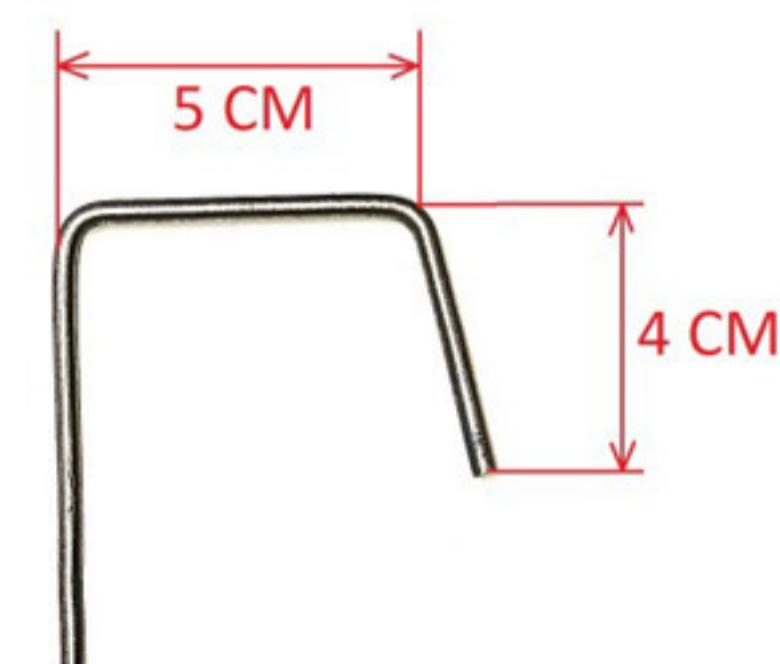
7 С помощью данного приспособления отогните левую защелку крепления камеры заднего вида и снимите ее. Отсоедините разъем камеры.
