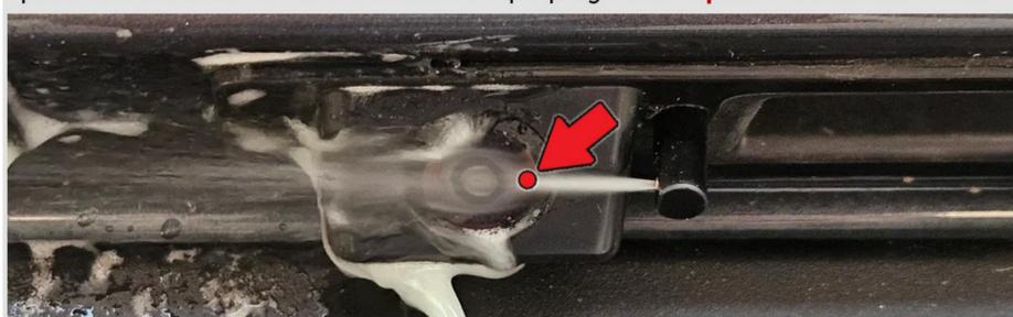
**11** Для регулировки форсунки используйте кнопку-гвоздь (в комплекте), согнув её плоскогубцами, как показано на рисунке.
