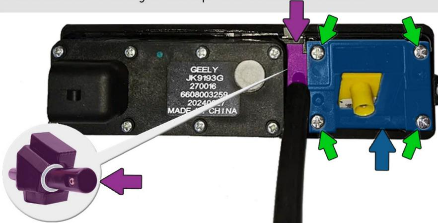
**8** Отрежьте 5 см от шланга из комплекта. Снимите шланг со штатного соединителя омывателя заднего стекла и установите тройник из комплекта, соединив его с соединителем отрезком шланга. Соедините тройник со шлангом из комплекта.
