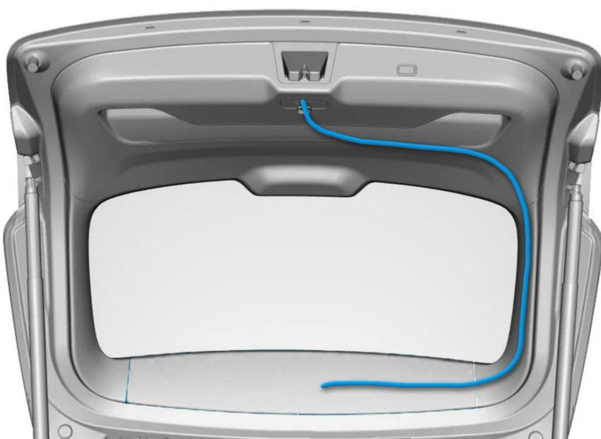
**10** Включите омыватель заднего стекла, убедитесь в отсутствии течей. Сборка авто осуществляется в обратной последовательности. При сборке убедитесь, что устанавливаемые накладки не пережимают шланг подачи жидкости к омывателю камеры. Отрегулируйте направление струи, чтобы она разбивалась о ближний к форсунке **край объектива**.
