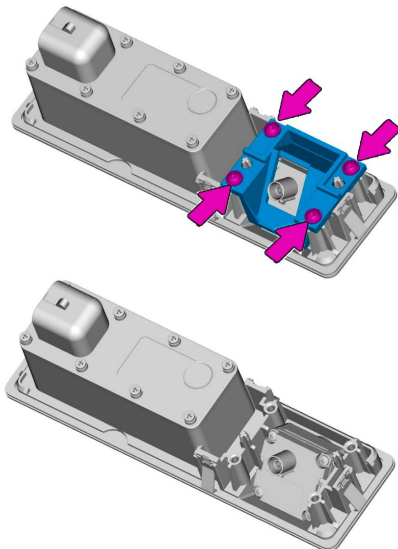
**6** Установите **шаблон** из комплекта, прижмите его **штатной рамкой** крепления камеры с помощью **двух саморезов**. Сквозь шаблон просверлите отверстие в корпусе кнопки сверлом диаметром 6 мм. Снимите **шаблон**.
