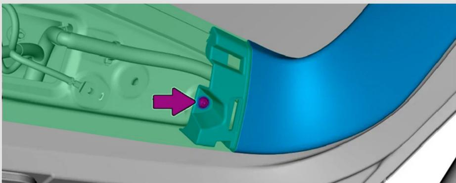
**3** Открутите **4 винта TORX27** крепления **рамки** номерного знака и снимите её.
