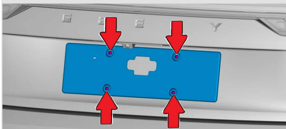
**4** Освободите **4 фиксатора** и снимите **кнопку** открывания багажника с камерой заднего вида. Отсоедините 2 разъема.
