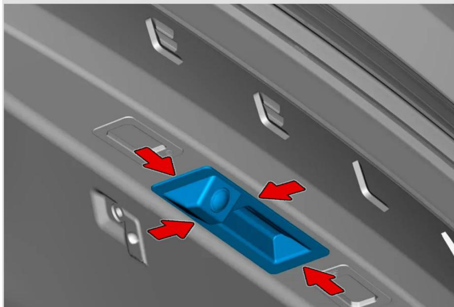
**5** Открутите **4 винта** крепления камеры к корпусу кнопки и снимите **крепление камеры**.
