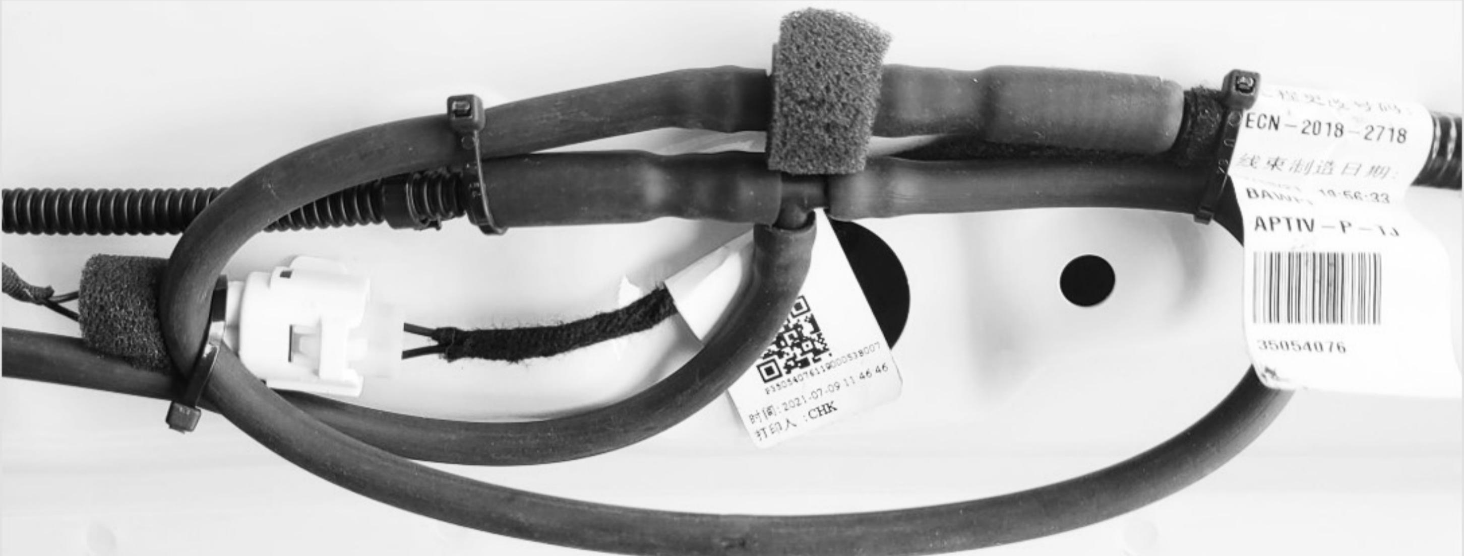
**12** Включите омыватель заднего стекла, убедитесь в отсутствии течей. Сборка авто осуществляется в обратной последовательности (при сборке убедитесь, что устанавливаемые накладки не пережимают шланг подачи жидкости к омывателю камеры).
