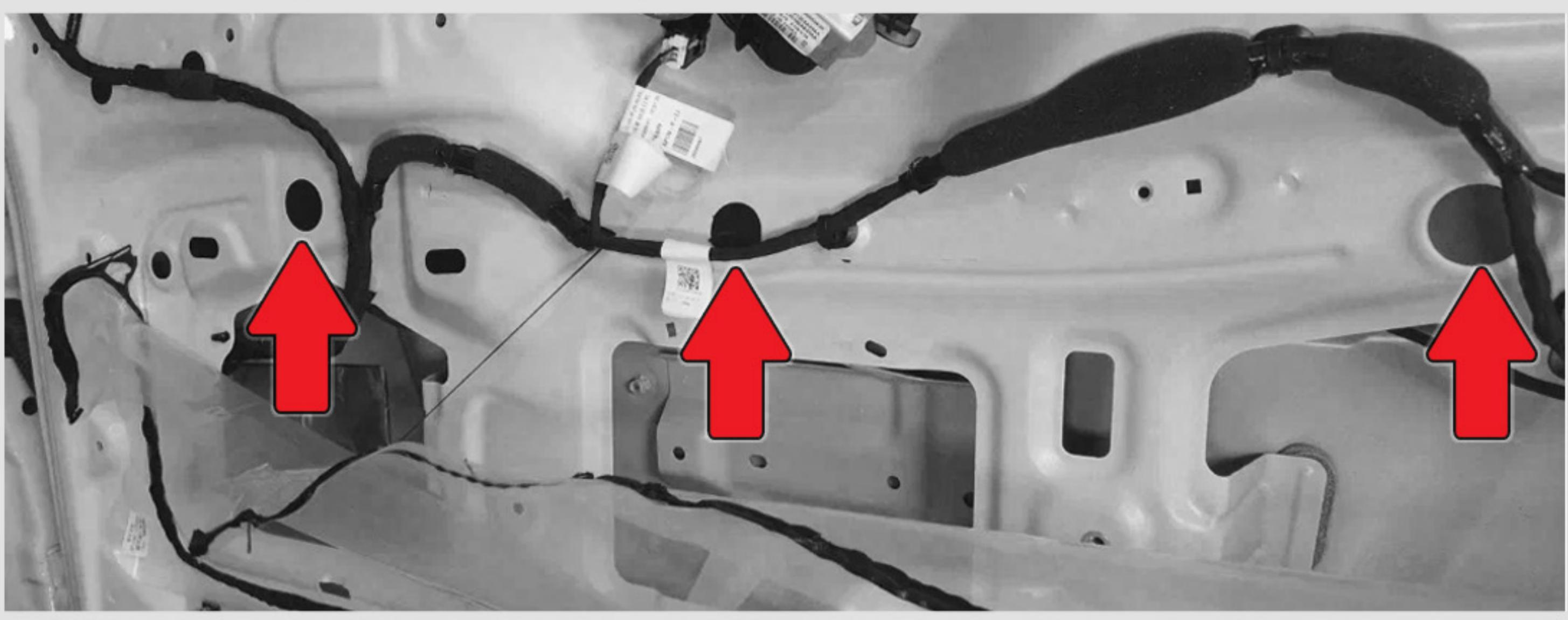
**8** Нажмите на **два фиксатора** и отсоедините крепление разъема камеры к крышке багажника, затем нажмите на **фиксаторы** и отсоедините разъем камеры.
