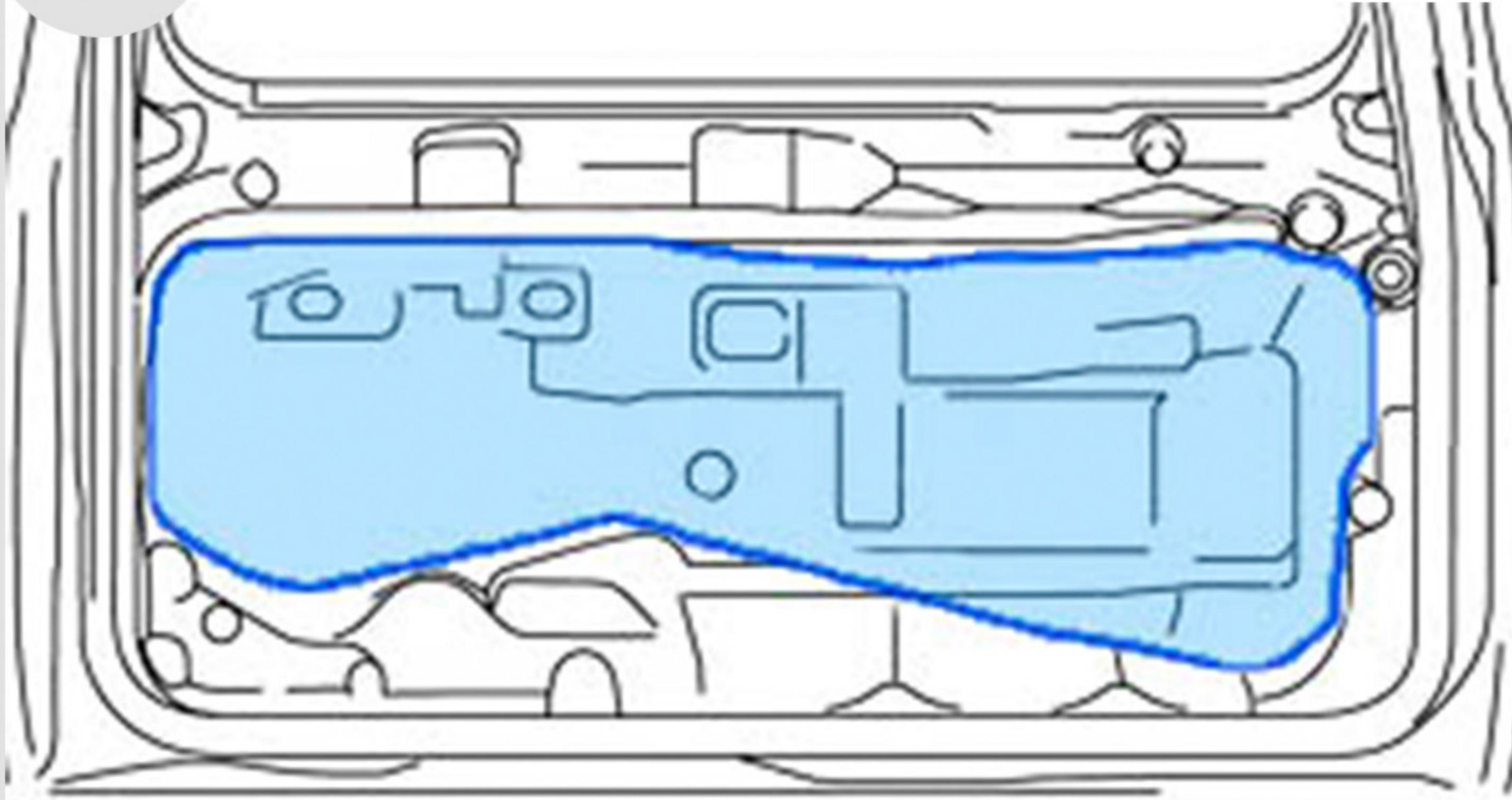
**7** Открутите **3 гайки** крепления наружной накладки крышки багажника (отверстия находятся под **наклейками**) и снимите ее, отсоединив разъемы подсветки номера.
