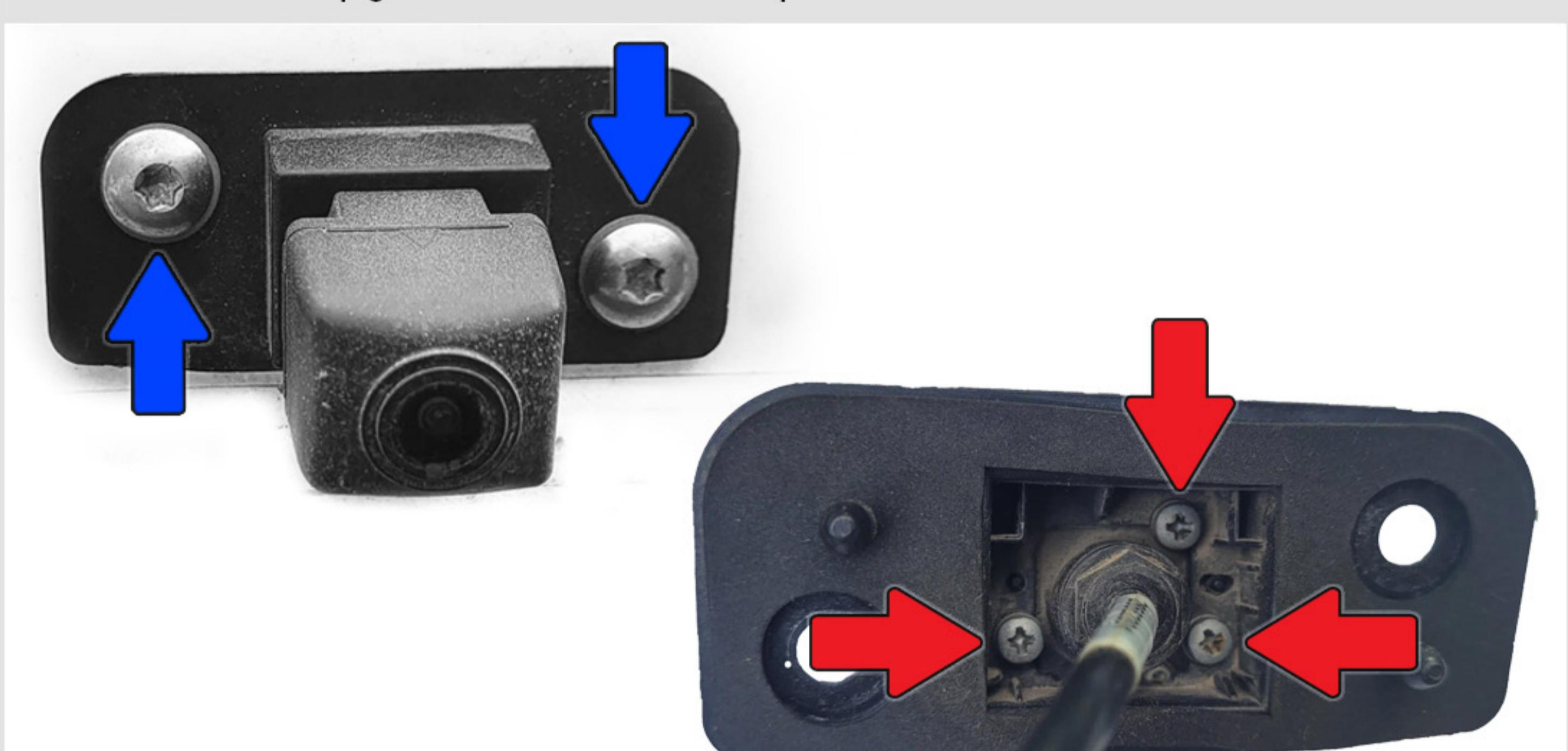
**10** Установите камеру на кронштейн омывателя и закрепите его двумя винтами TORX27 на крышке багажника. Соедините шланг с обратным клапаном и протяните его к верхней части крышки багажника, закрепив стяжками на штатной проводке.
