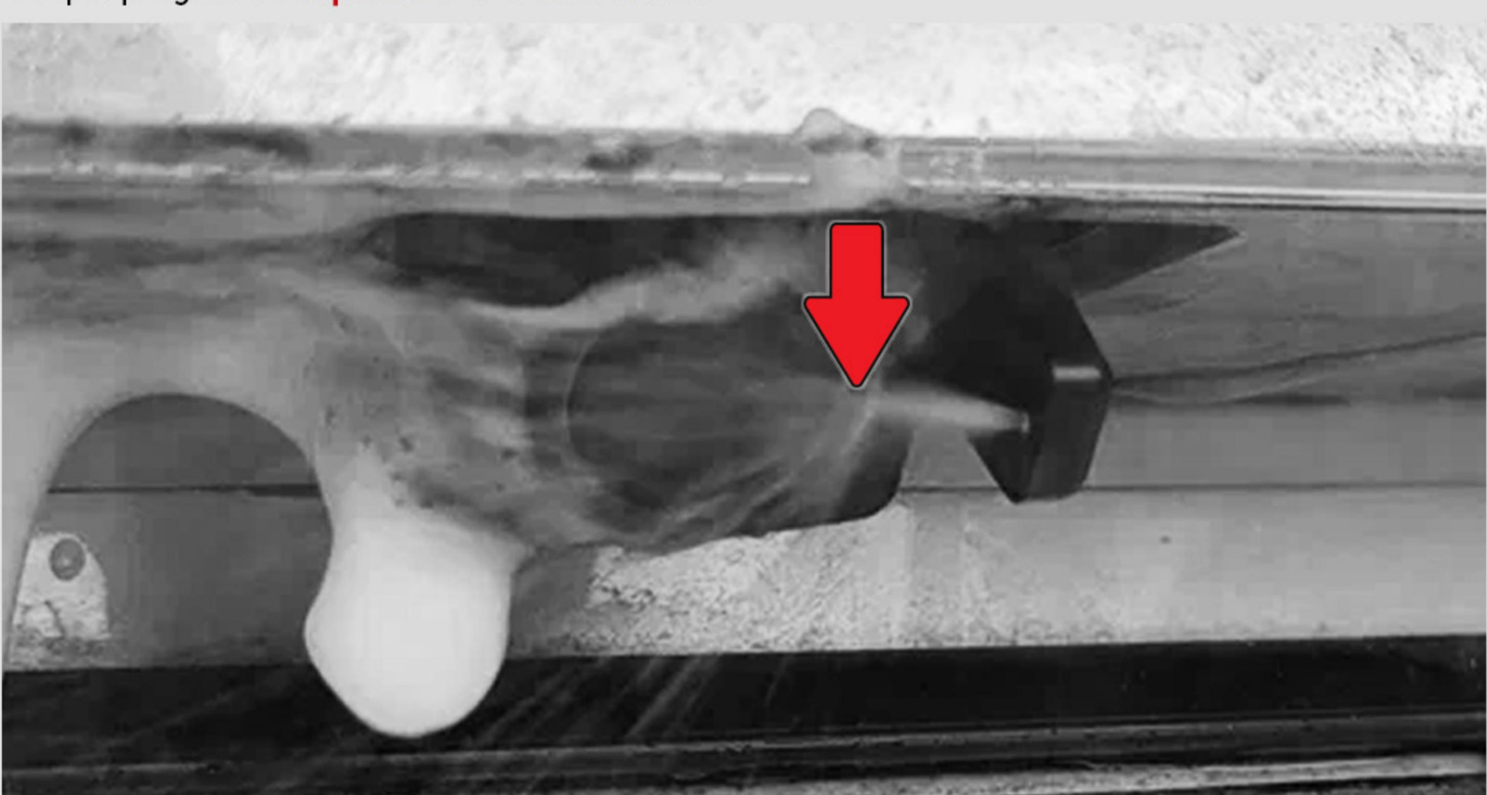
**13** Для регулировки форсунки используйте кнопку - гвоздь (в комплекте), согнув её плоскогубцами, как это показано на рисунке.
