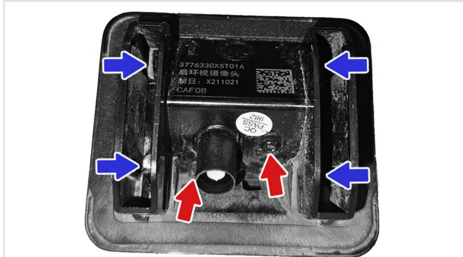
**6** Установите камеру на кронштейн с омывателем, закрутите **ВИНТЫ** крепления.
