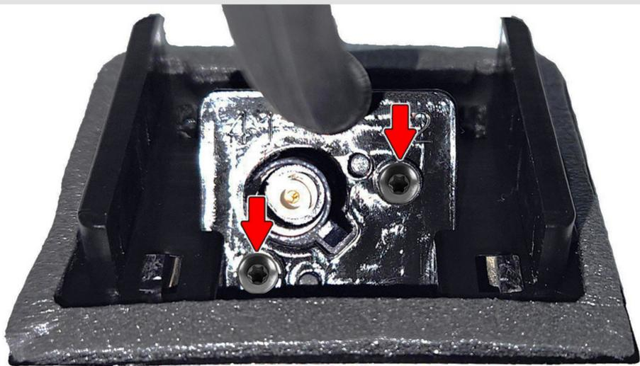
**7** Установите колпачок камеры на кронштейн с омывателем. Установите камеру в штатное место, подключите разъем камеры.
