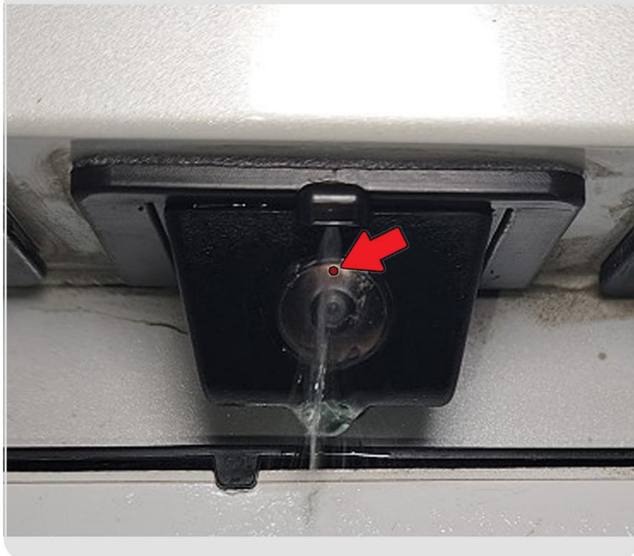
**11** Для регулировки форсунки используйте кнопку-гвоздь (в комплекте), согнув её плоскогубцами, как это показано на рисунке.
