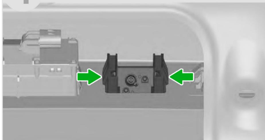
**5** Сожмите **4 фиксатора** и снимите наружный колпачок с камеры заднего вида.
