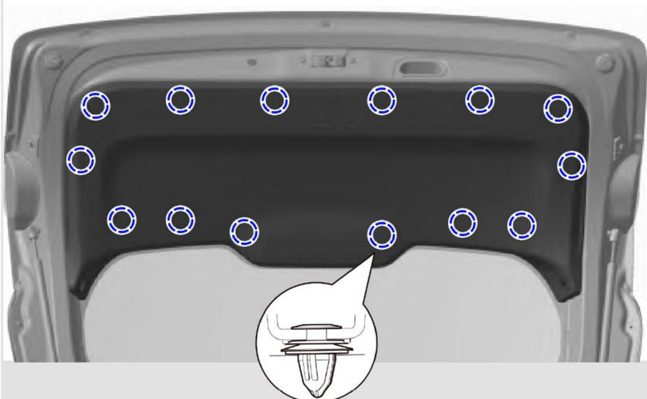
**2** Освободите **3 клипсы** и снимите верхнюю **накладку** крышки багажного отделения.
