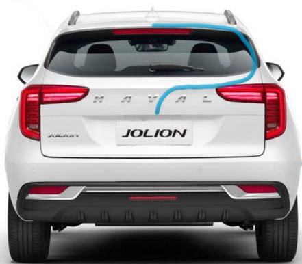
**9** Разрежьте штатный шланг форсунки омывателя заднего стекла и установите тройник из комплекта в место разреза.
