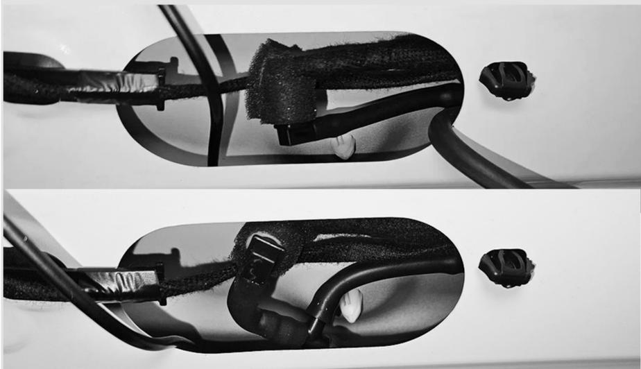
**10** Включите омыватель заднего стекла, убедитесь в отсутствии течей. Сборка авто осуществляется в обратной последовательности (при сборке убедитесь, что устанавливаемые наклейки не пережимают шланг подачи жидкости к омывателю камеры).
