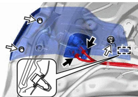
7. ОТСОЕДИНИТЕ РАЗЪЕМ, ВЫВЕРНИТЕ 4 БОЛТА И СНИМИТЕ ЭЛЕКТРОДВИГАТЕЛЬ ЗАДНЕГО СТЕКЛООЧИСТИТЕЛЯ
