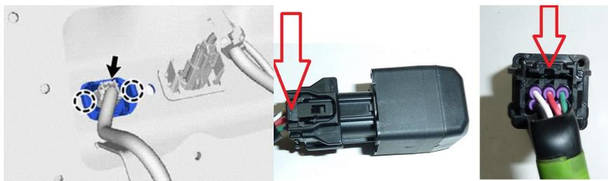
10. ОТОГНИТЕ ОБИВКУ ПОТОЛКА, ОТСТЕГНУВ КЛИПСЫ, СНИМИТЕ ШТАТНЫЙ СОЕДИНИТЕЛЬ И ЗАМЕНИТЕ ЕГО НА ТРОЙНИК
