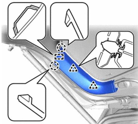
3. СНИМИТЕ КРЫШКУ ЗАМКА МЕХАНИЗМА ОТКРЫВАНИЯ ЗАДНЕГО СТЕКЛА
