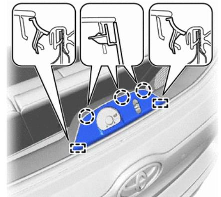
4. СНИМИТЕ ПАНЕЛЬ ОБЛИЦОВКИ ДВЕРИ БАГАЖНОГО ОТДЕЛЕНИЯ
