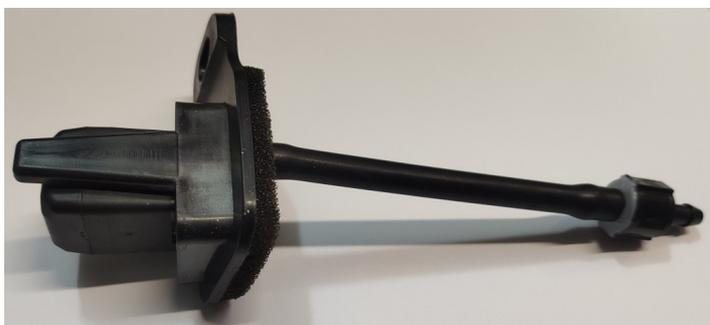
13. УСТАНОВИТЕ КАМЕРУ С КРОНШТЕЙНОМ В ШТАТНОЕ МЕСТО. ВКЛЮЧИТЕ ОМЫВАТЕЛЬ ЗАДНЕГО СТЕКЛА, УБЕДИТЕСЬ В ОТСУТСТВИИ ТЕЧЕЙ. СБОРКА АВТО ОСУЩЕСТВЛЯЕТСЯ В ОБРАТНОЙ ПОСЛЕДОВАТЕЛЬНОСТИ (ПРИ СБОРКЕ УБЕДИТЕСЬ ЧТО УСТАНАВЛИВАЕМЫЕ НАКЛАДКИ НЕ ПЕРЕЖИМАЮТ ШЛАНГ ПОДАЧИ ЖИДКОСТИ К ОМЫВАТЕЛЮ КАМЕРЫ). ПРИ НЕОБХОДИМОСТИ ОТРЕГУЛИРУЙТЕ ПОЛОЖЕНИЕ ШАРИКА ДЛЯ НАИЛУЧШЕГО ОМЫВАНИЯ КАМЕРЫ
