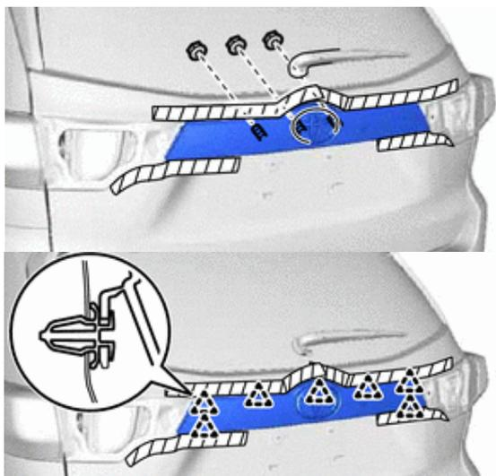
9. ОСВОБОДИТЕ 2 ЗАХВАТА И СНИМИТЕ КАМЕРУ ЗАДНЕГО ВИДА. НАЖМИТЕ НА ФИКСАТОР РАЗЪЕМА КАК УКАЗАНО НИЖЕ И СНИМИТЕ РАЗЪЕМ С КАМЕРЫ
