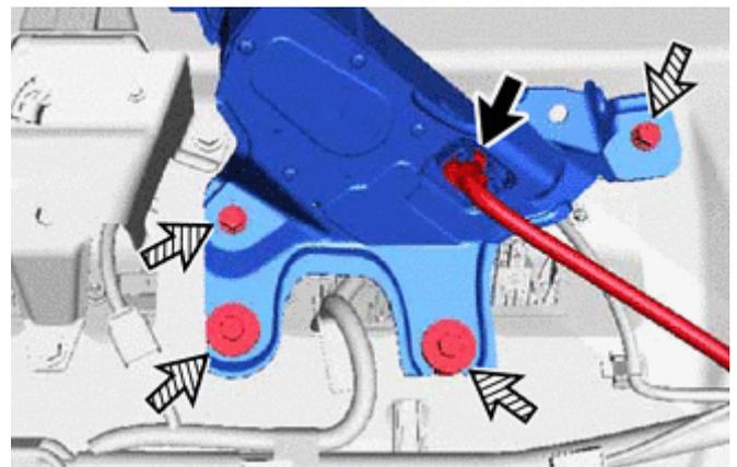
8. ОТВЕРНИТЕ 3 ГАЙКИ, ОТСОЕДИНИТЕ 7 ФИКСАТОРОВ И СНИМИТЕ НАРУЖНУЮ НАКЛАДКУ КРЫШКИ БАГАЖНИКА
