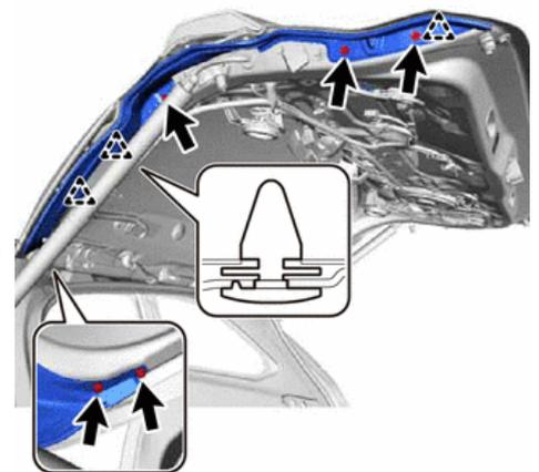
6. ОТВЕРНИТЕ 3 ГАЙКИ, ОТСОЕДИНИТЕ РАЗЪЕМЫ И СНИМИТЕ ЛЕВЫЙ И ПРАВЫЙ ФОНАРИ КРЫШКИ БАГАЖНИКА
