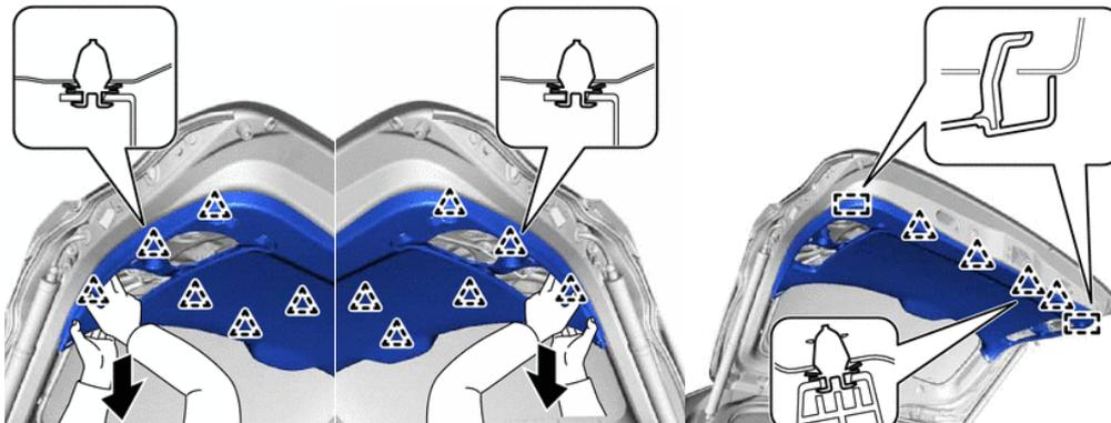
5. ВЫВЕРНИТЕ 5 ВИНТОВ, ОСВОБОДИТЕ 3 ФИКСАТОРА И СНИМИТЕ ЛЕВЫЙ И ПРАВЫЙ ДАТЧИКИ ПРИВОДА КРЫШКИ БАГАЖНИКА
