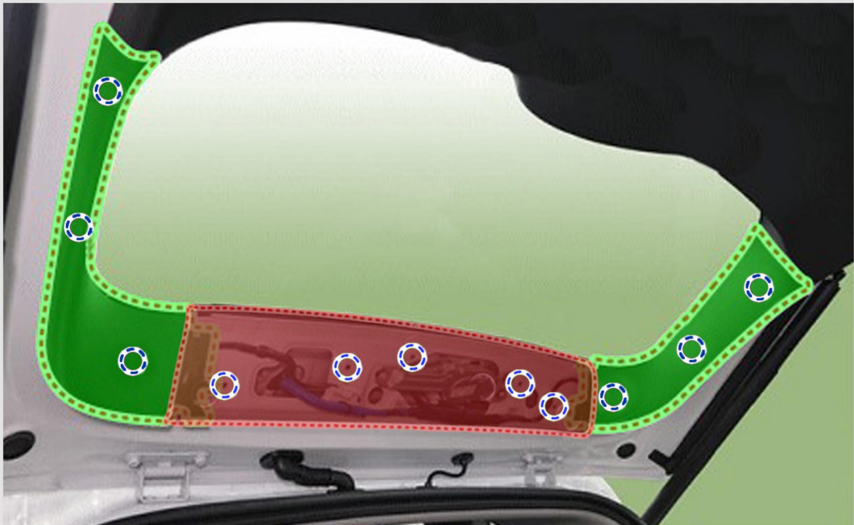
**2** Снимите заглушку ручки закрывания двери багажного отделения.
