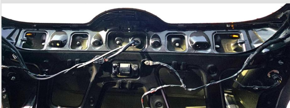
**8** Снимите шланг со штатного обратного клапана омывателя заднего стекла и установите тройник из комплекта, соединив его с клапаном отрезком шланга. Соедините тройник со шлангом от омывателя камеры.
