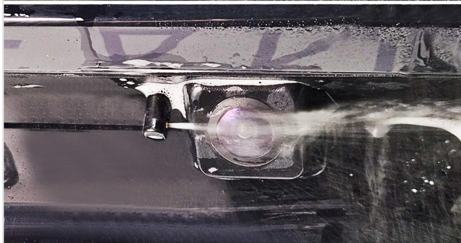
**10** Для регулировки форсунки используйте кнопку-гвоздь (в комплекте), согнув её плоскогубцами, как показано на рисунке.
