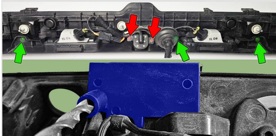
**5** Снимите шаблон, установите камеру на штатное место, установите омыватель камеры. Закрепите их **штатным винтом** и **винтом из комплекта**.
