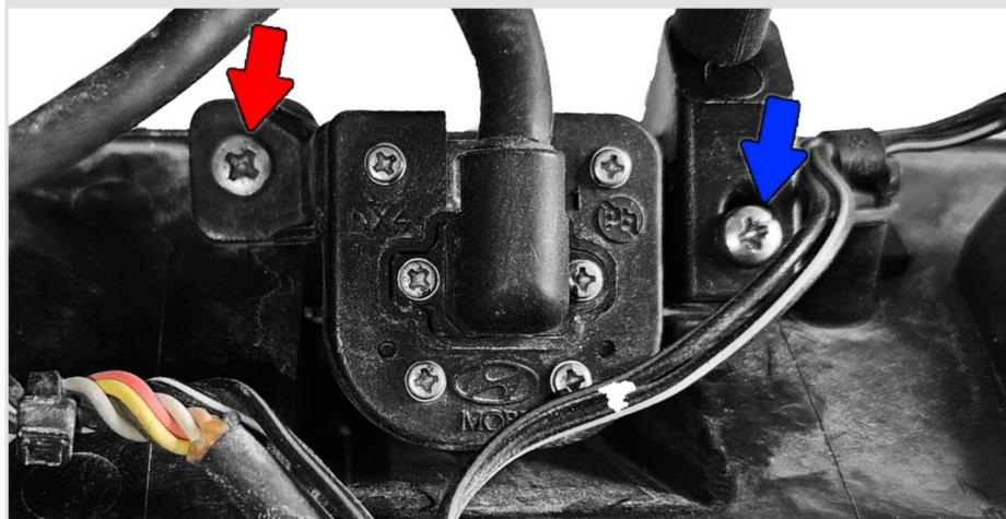
**6** В уплотнительной резинке проводки наружной накладке двери багажного отделения пробейте отверстие под шланг (сделать это можно головкой на 5 мм). Протяните шланг омывателя через проделанное отверстие.
