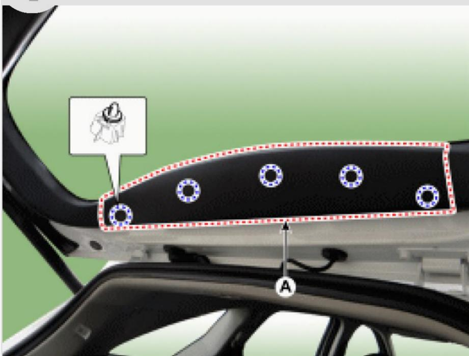
**2** Отверните **два самореза** и, отстегнув **клипсы**, снимите **левую** и **правую** боковые облицовки двери багажного отделения.
