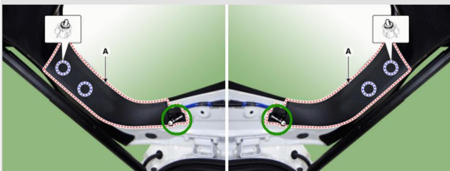
**3** Снимите **накладку** ручки закрывания багажного отделения.
