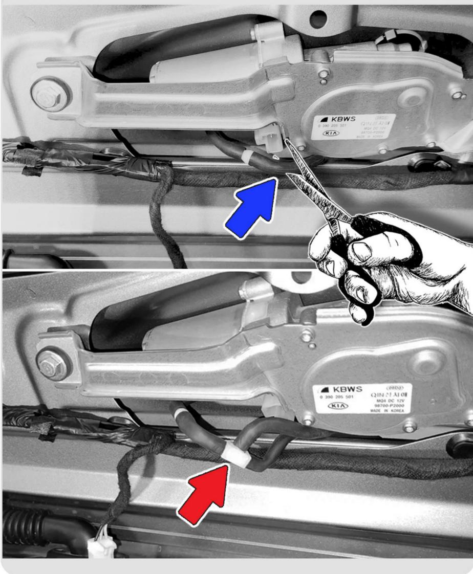
**10** Включите омыватель заднего стекла, убедитесь в отсутствии течей. Сборка авто осуществляется в обратной последовательности (при сборке убедитесь, что устанавливаемые накладки не пережимают шланг подачи жидкости к омывателю камеры).
