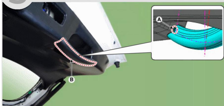
**4** Открутите **четыре винта**, снимите нижнюю **обивку двери** багажного отделения, отстегнув **клипсы**. Отсоедините разъем кнопки закрывания багажного отделения.
