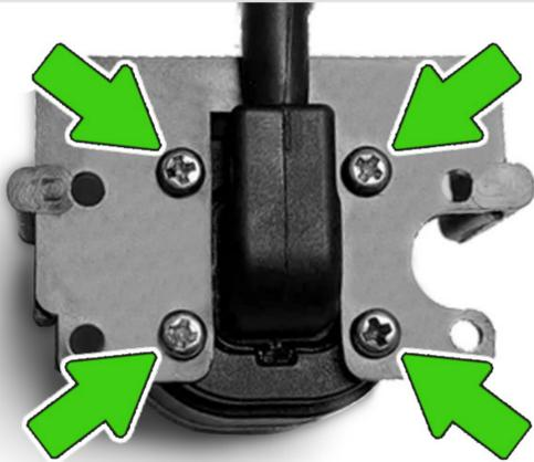
**8** Установите наружную часть кронштейна с омывателем в отверстие в кузове. Вставьте изнутри крышки багажника камеру с частью кронштейна. Закрутите **четыре длинных самореза**.
