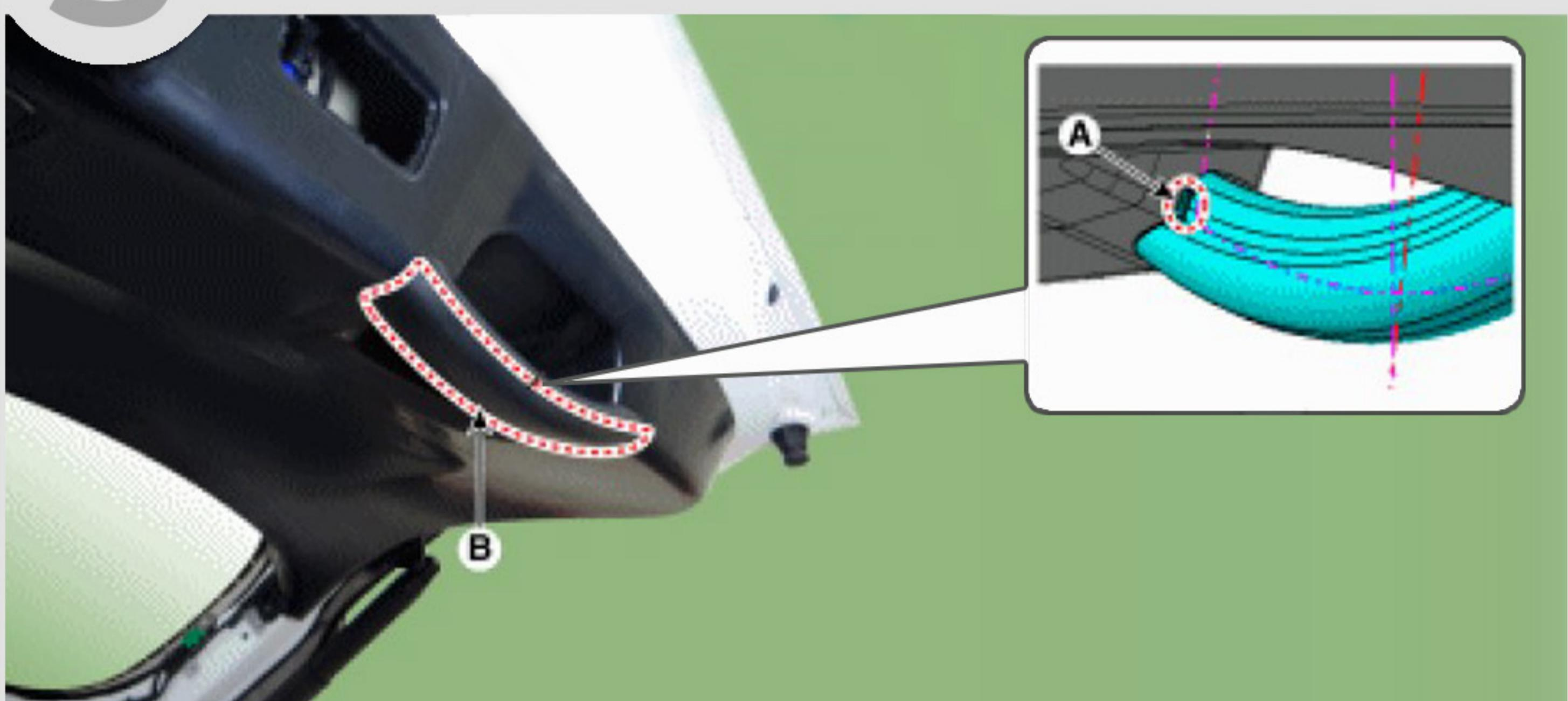
**4** Открутите **четыре винта**, снимите нижнюю **обивку** **двери** багажного отделения, отстегнув **клипсы**. Отсоедините разъем кнопки закрывания багажного отделения.
