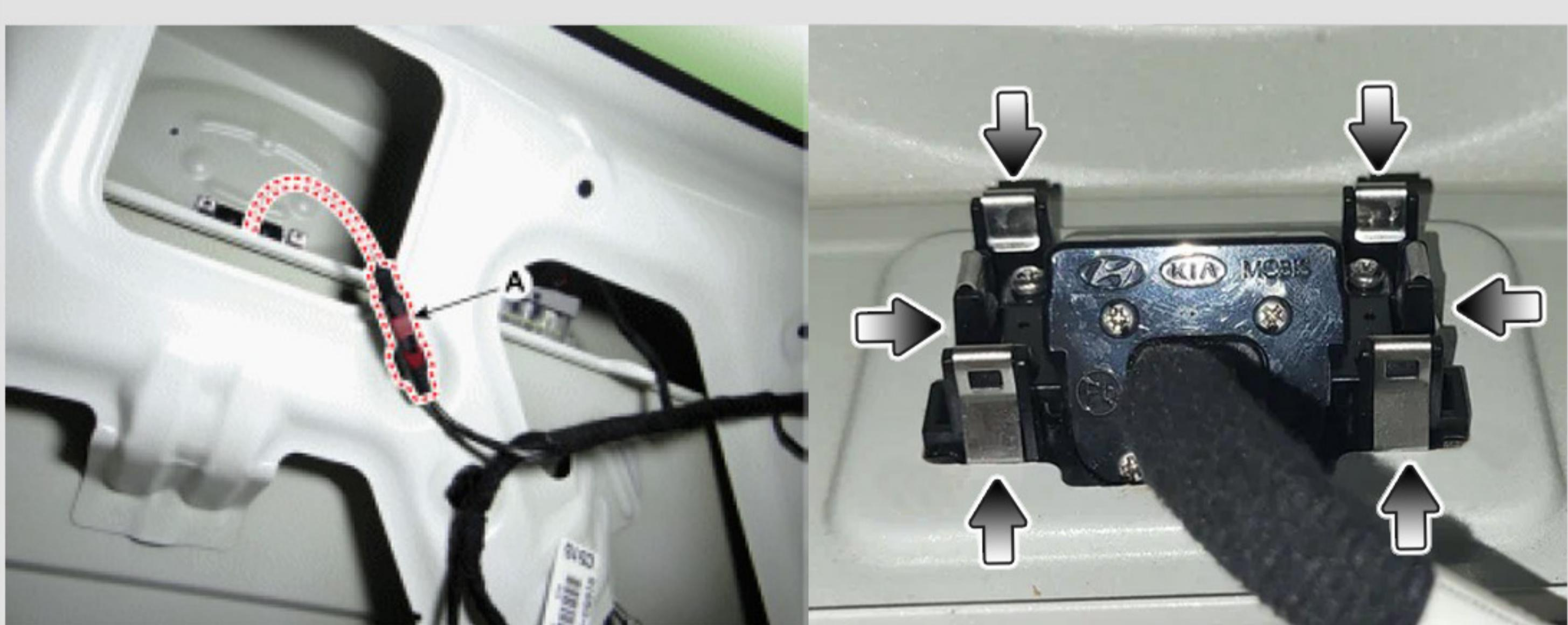
**6** Снимите **камеру заднего вида**, выверните **восемь винтов** крепления камеры.
