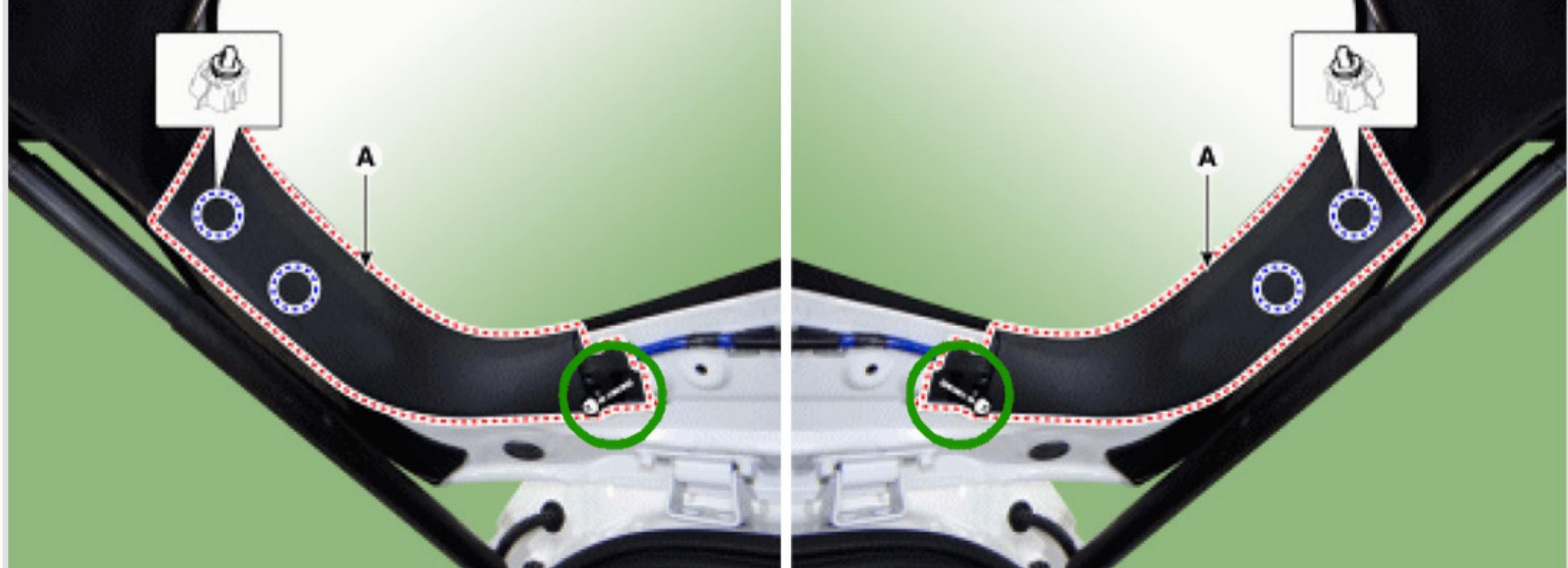
**3** Снимите **накладку** ручки закрывания багажного отделения.
