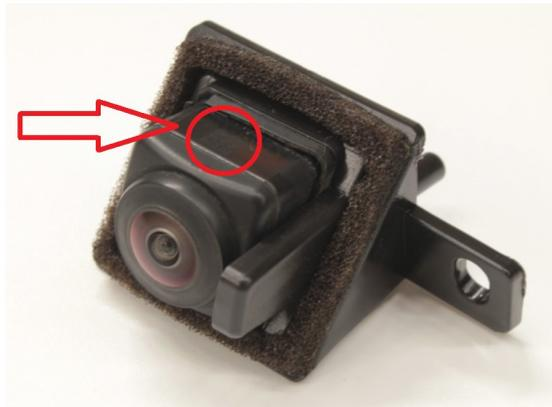
11. ДЛЯ АВТОМОБИЛЕЙ ПОСЛЕ РЕСТАЙЛИНГА 2020 г ОТВЕРНИТЕ 2 ВИНТА КРЕПЛЕНИЯ КАМЕРЫ К КРОНШТЕЙНУ, ОСВОБОДИТЕ ФИКСАТОР И УСТАНОВИТЕ КАМЕРУ НА НОВЫЙ КРОНШТЕЙН НАКЛЕЙКОЙ ВВЕРХ, КАК ПОКАЗАНО НА ФОТО
