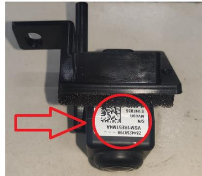
11. УСТАНОВИТЕ КРОНШТЕЙН С КАМЕРОЙ В ШТАТНОЕ МЕСТО, С ПОМОЩЬЮ ОТВЕРТКИ ЗАЩЕЛКНИТЕ КЛИПСЫ КРЕПЛЕНИЯ, ЗАКРУТИТЕ ВИНТ. УСТАНОВИТЕ НАКЛАДКУ НА КРЫШКУ БАГАЖНИКА
