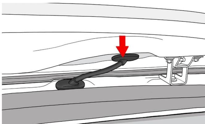
13. СОЕДИНИТЕ ТРОЙНИК С ОМЫВАТЕЛЕМ КАМЕРЫ ШЛАНГОМ, ПРОТЯНУВ ЕГО ВНУТРИ ПРАВОЙ СТОРОНЫ КРЫШКИ БАГАЖНИКА. ВКЛЮЧИТЕ ОМЫВАТЕЛЬ ЗАДНЕГО СТЕКЛА, УБЕДИТЕСЬ В ОТСУТСТВИИ ТЕЧЕЙ. СБОРКА АВТО ОСУЩЕСТВЛЯЕТСЯ В ОБРАТНОЙ ПОСЛЕДОВАТЕЛЬНОСТИ (ПРИ СБОРКЕ УБЕДИТЕСЬ ЧТО УСТАНОВЛИВАЕМЫЕ НАКЛАДКИ НЕ ПЕРЕЖИМАЮТ ШЛАНГ ПОДАЧИ ЖИДКОСТИ К ОМЫВАТЕЛЮ КАМЕРЫ). ПРИ НЕОБХОДИМОСТИ ОТРЕГУЛИРУЙТЕ ПОЛОЖЕНИЕ ШАРИКА ДЛЯ НАИЛУЧШЕГО ОМЫВАНИЯ КАМЕРЫ
