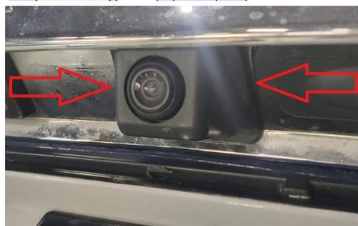
10. ДЛЯ АВТОМОБИЛЕЙ ДО РЕСТАЙЛИНГА 2020 г ОТВЕРНИТЕ 2 ВИНТА КРЕПЛЕНИЯ КАМЕРЫ К КРОНШТЕЙНУ И УСТАНОВИТЕ КАМЕРУ НА НОВЫЙ КРОНШТЕЙН QR КОДОМ ВВЕРХ, КАК ПОКАЗАНО НА ФОТО
