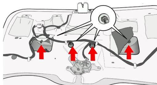
7. ПРОГРЕЙТЕ НАРУЖНУЮ НАКЛАДКУ СТРОИТЕЛЬНЫМ ФЕНОМ (ТЕМПЕРАТУРОЙ ОКОЛО 100 С) И СНИМИТЕ ЕЕ
