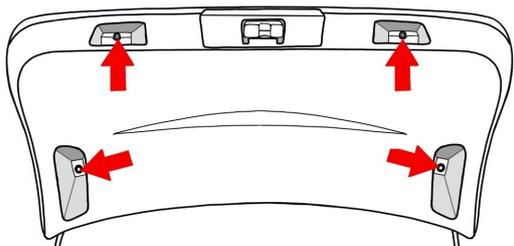
2. СНИМИТЕ ПЛАСТИКОВУЮ ОБИВКУ КРЫШКИ БАГАЖНИКА
