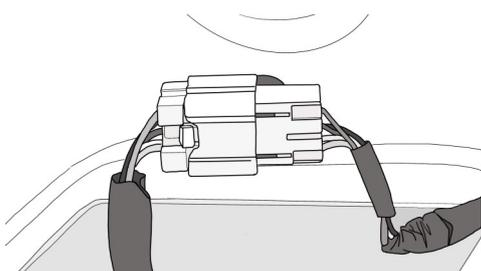
5. СНИМИТЕ РАЗЪЕМ С ЗАМКА КРЫШКИ БАГАЖНИКА
