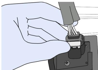
9. ОТВЕРТКОЙ TORX T20 ОТВЕРНИТЕ ВИНТ КРЕПЛЕНИЯ КАМЕРЫ ЗАДНЕГО ВИДА ИЛИ ОСВОБОДИТЕ 2 ФИКСАТОРА (ДЛЯ АВТОМОБИЛЕЙ ПОСЛЕ РЕСТАЙЛИНГА 2020 ГОДА) И СНИМИТЕ КУМЕРУ
