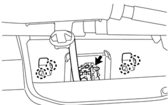
6. НАЖМИТЕ НА ФИКСАТОР РАЗЪЕМА КАК УКАЗАНО НИЖЕ И СНИМите РАЗЪЕМ С КАМЕРЫ
