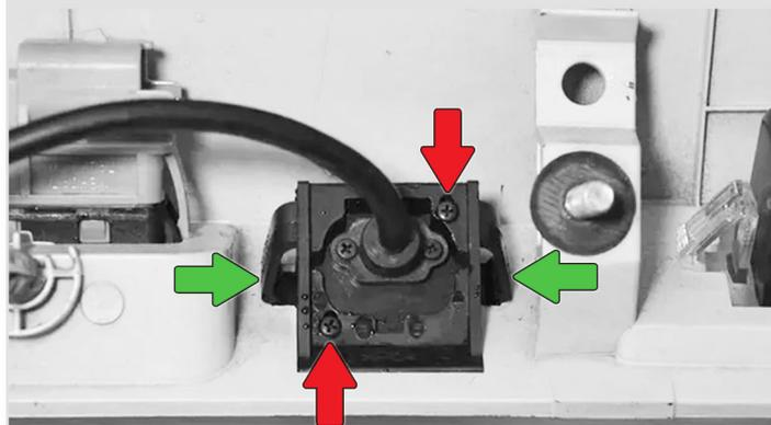
**4** Нанесите подручный смазочный материал на резиновый уплотнитель (только для модели с 2020 года выпуска), чтобы его было проще пропустить сквозь кронштейн. Снимите камеру со штатного кронштейна и установите ее на новый. Закрутите **2 винта** крепления камеры.
