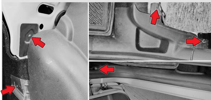
**10** Снимите **заглушки гаек** крепления рычагов стеклоочистителя, ключом на 16 мм открутите **гайки** снимите рычаги стеклоочистителя. Отверните **6 саморезов** крепления пластиковой накладки под лобовым стеклом и снимите её.
