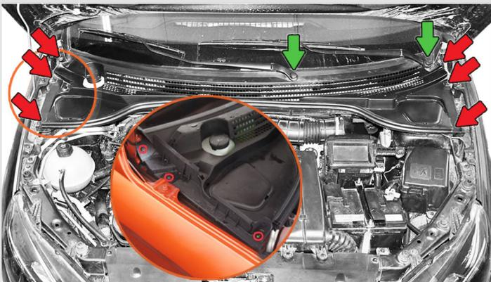
**11** Используя подручный смазочный материал, протяните шланг через **два штатных уплотнителя** к мотору омывателя лобового стекла. Разрежьте штатный шланг омывателя рядом с насосом и соедините его со шлангом омывателя камеры при помощи **тройника**.
