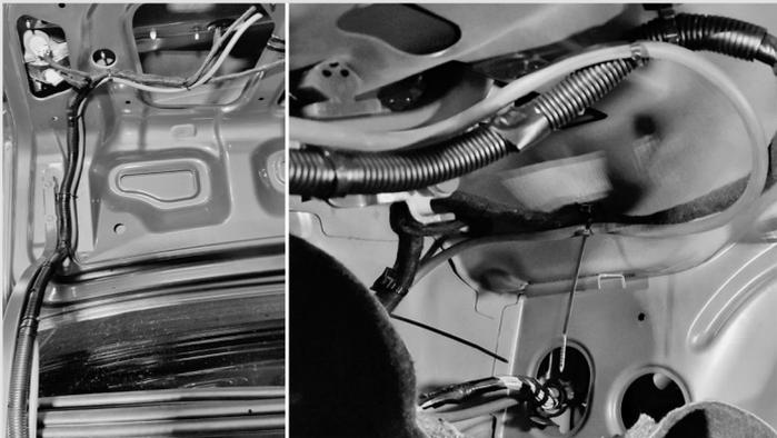
**9** Выверните **саморезы**, снимите накладку левого порога. Проложите шланг вдоль проводки порога и закрепите его стяжками.
