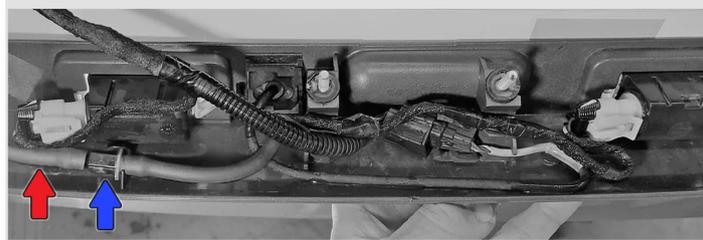
**7** Для схемы с **электромагнитным клапаном** (поставляется отдельно), установите его в разрыв шланга ближе к обратному клапану. Закрепите электромагнитный клапан на крышке багажника с помощью пластиковых стяжек, как показано на фото. Подключите провода обратного клапана к лампе заднего хода на фонаре. Полярность значения не имеет.
