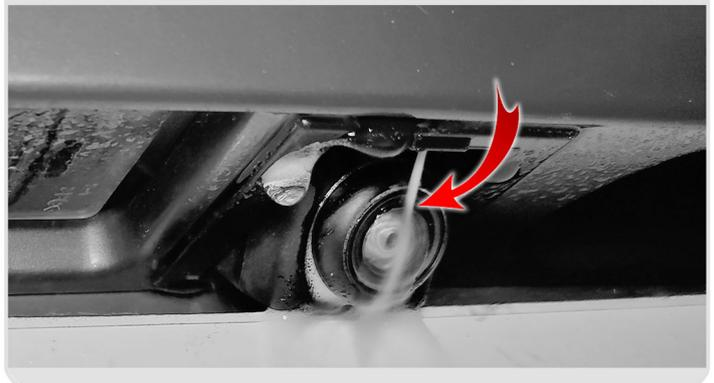
**13** Для регулировки форсунки используйте кнопку - гвоздь (в комплекте), согнув её плоскогубцами, как это показано на рисунке.
