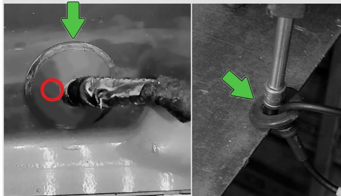
**6** Протяните **основной шланг** через отверстие в уплотнительной резинке и соедините его с **обратным клапаном**. Установите камеру с кронштейном в штатное место, установите на место наружную накладку крышки багажника.
