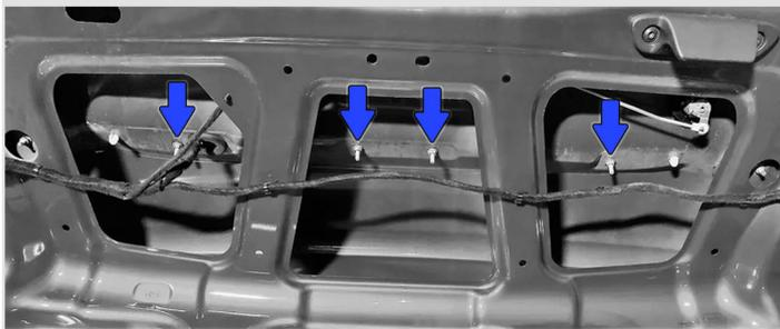
**3** Сожмите **2 фиксатора** и снимите камеру заднего вида. Открутите **2 винта** крепления камеры к кронштейну.
