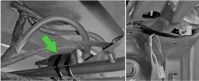
**8** Протяните шланг вдоль штатной проводки крышки багажного отделения за спинку заднего сиденья и закрепите его стяжками.
