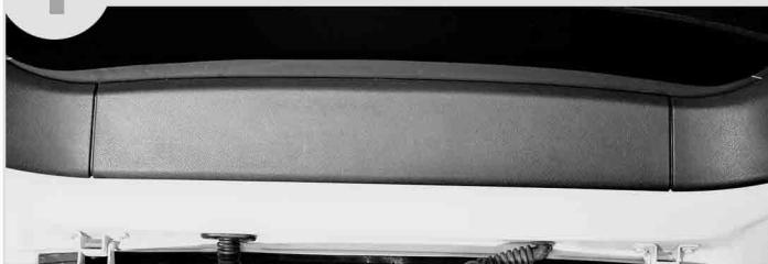
**2** Отверните **2 самореза**, затем снимите левую и правую боковые облицовки двери багажного отделения.
