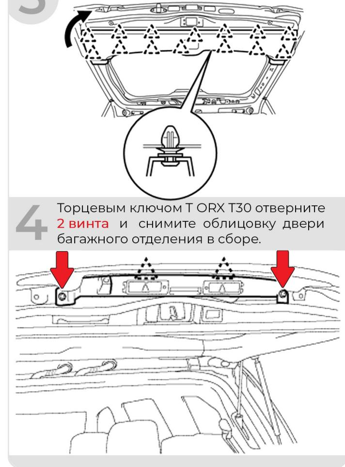
**4** Торцевым ключом TORX T30 отверните **2 винта** и снимите облицовку двери багажного отделения в сборе.
