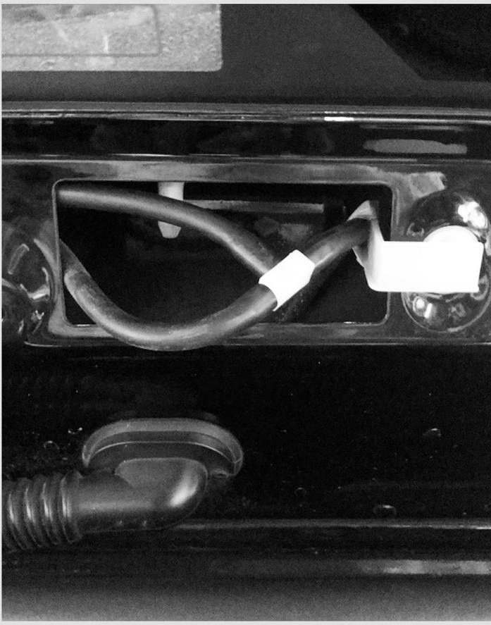
**10** Установите камеру с кронштейном в штатное место. Включите омыватель переднего или заднего стекла в зависимости от того, к которому подключились. Убедитесь в отсутствии течей. Сборка осуществляется в обратной последовательности. При сборке убедитесь, что устанавливаемые наклейки не пережимают шланг подачи жидкости к омывателю камеры. При необходимости отрегулируйте положение шарика для наилучшего омывания камеры.
