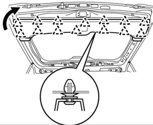
**4** Торцевым ключом TORX T30 отверните 2 винта и снимите облицовку двери багажного отделения в сборе.
