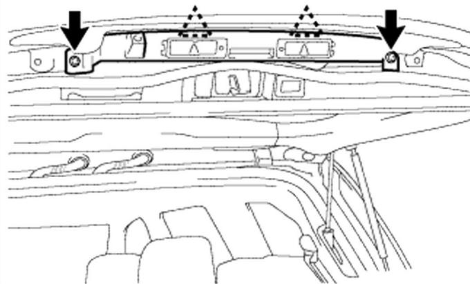
**5** Выверните 2 винта с головкой TORX T30. Сожмите **усики пластиковых клипс**, либо отрежьте клипсы и снимите камеру.
