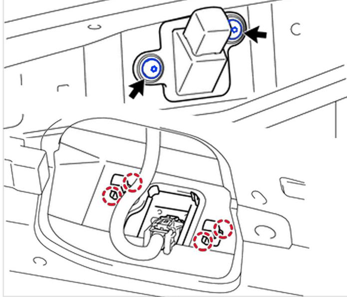
**6** Нажмите на фиксатор разъема как указано ниже и снимите разъем с камеры.
