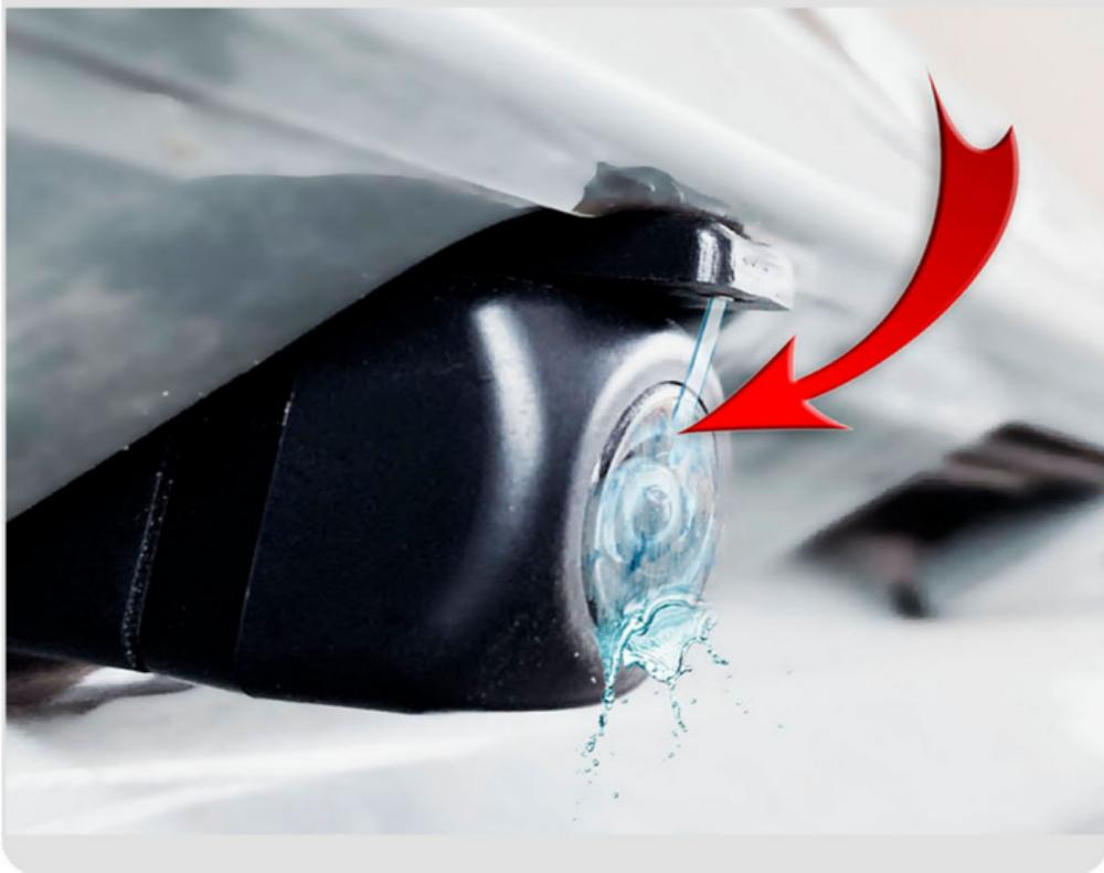
**15** Для регулировки форсунки используйте швейную иглу или финишный гвоздь, слегка заточив его на абразивном бруске и согнув плоскогубцами, как показано ниже.
