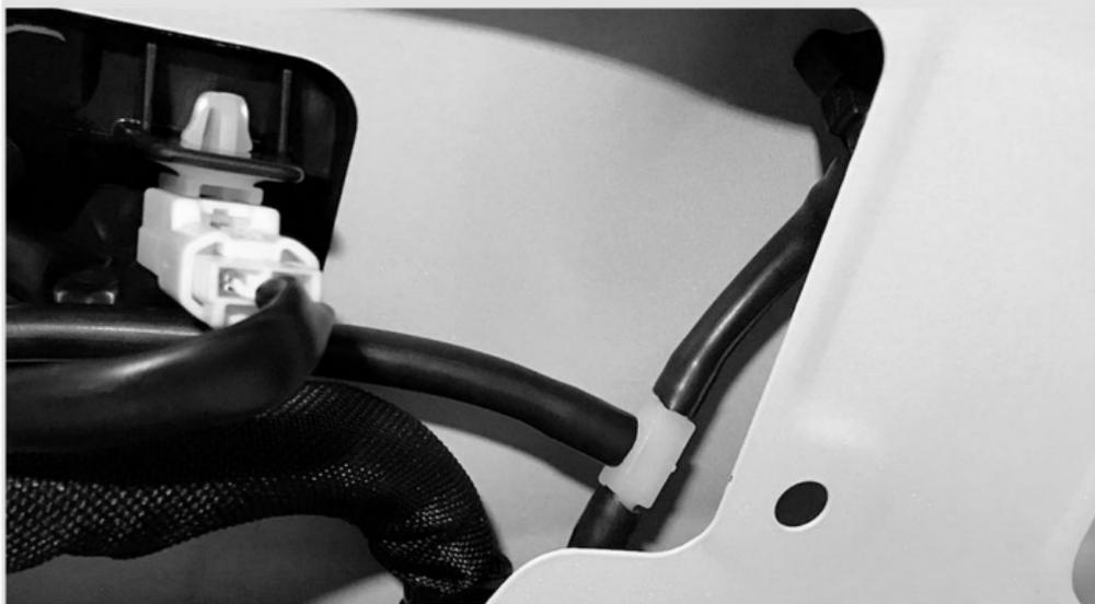
**14** Установите камеру с кронштейном в штатное место. Включите омыватель переднего или заднего стекла в зависимости от того, к которому подключились. Убедитесь в отсутствии течей. Сборка осуществляется в обратной последовательности. При сборке убедитесь, что устанавливаемые накладки не пережимают шланг подачи жидкости к омывателю камеры. При необходимости отрегулируйте положение шарика для наилучшего омывания камеры.
