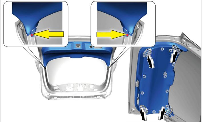
**5** Освободите резиновую втулку из отверстия в крышке багажника и проделайте во втулке отверстие диаметром 6-7 мм.
