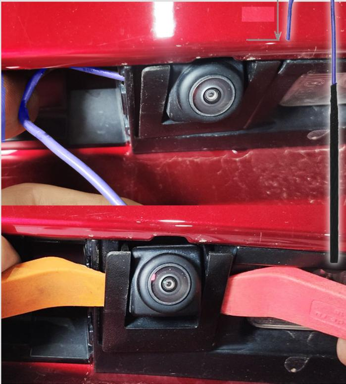
**8** Нажмите на фиксатор и отсоедините провод от камеры. Открутите 2 винта крепления камеры к кронштейну.
