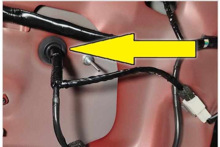
**6** Снимите **заглушку** накладки крышки багажника.
