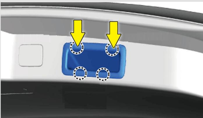
**3** Снимите кнопку закрывания крышки багажника, отсоедините разъем.
