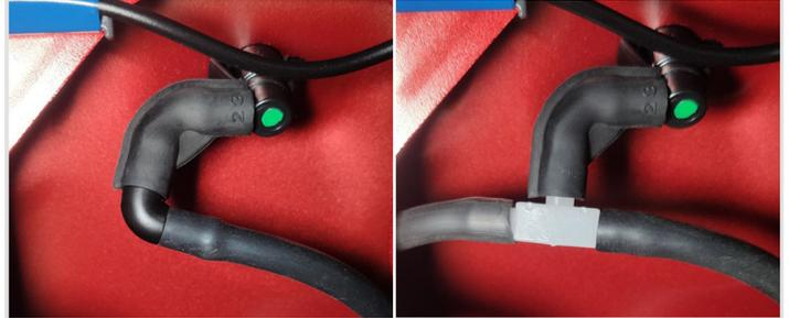
**11** Включите омыватель заднего стекла, убедитесь в отсутствии течей. Сборка автомобиля осуществляется в обратной последовательности. Убедитесь, что накладки не пережимают шланг подачи жидкости к омывателю камеры). Отрегулируйте форсунку так, чтобы струя разбивалась о ближний к ней край объектива (место указано красной стрелкой).
