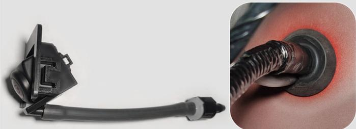
**10** Установите камеру с кронштейном в штатное место. Снимите штатный соединительный уголок и замените его на тройник. Соедините шланг с тройником, закрепите шланг стяжками на штатной проводке.
