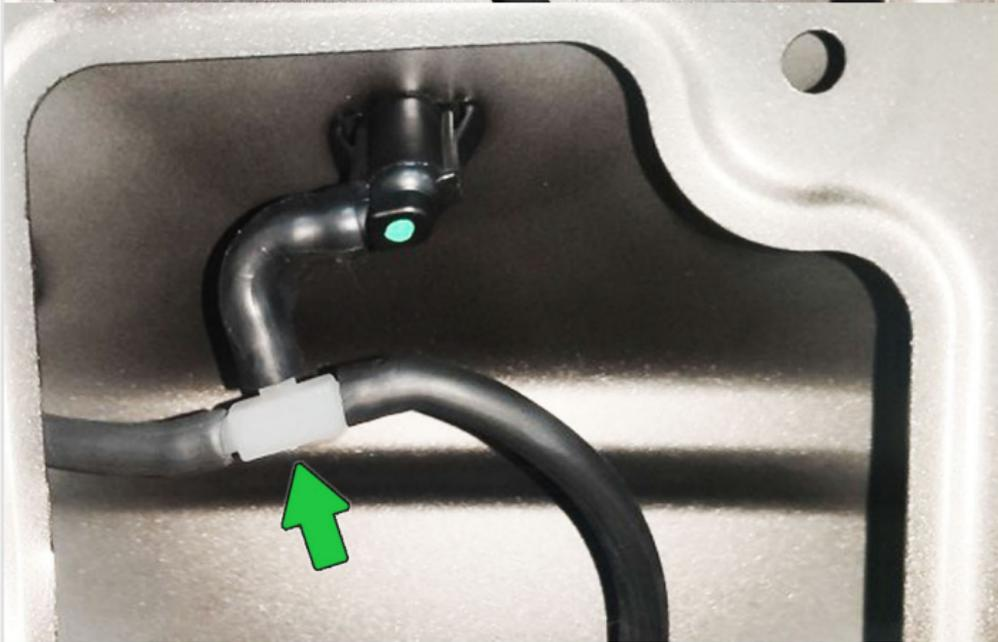
**13** Включите омыватель заднего стекла, убедитесь в отсутствии течей. Сборка авто осуществляется в обратной последовательности (при сборке убедитесь, что устанавливаемые накладки не пережимают шланг подачи жидкости к омывателю камеры).
