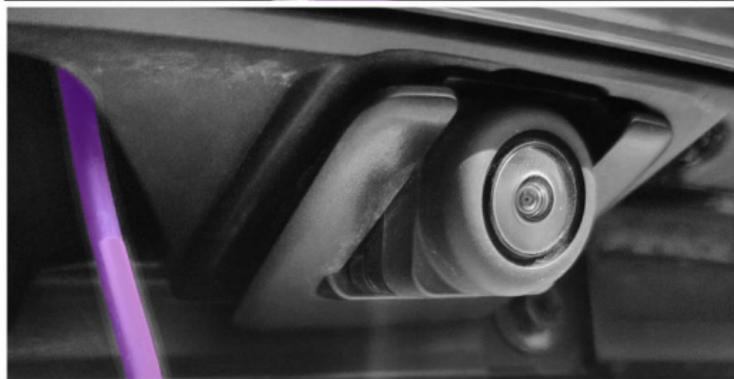
**9** С помощью острого предмета отогните **2 фиксатора** крепления провода к камере и отсоедините провод. Открутите 2 винта крепления камеры к кронштейну. Снимите камеру с кронштейна.
