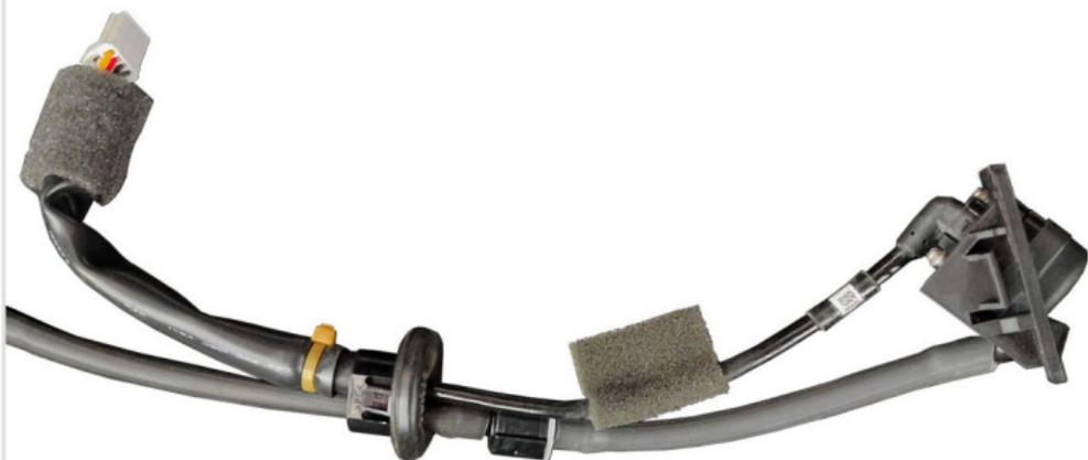
11 В уплотнительной резинке втулки проводки камеры проделайте отверстие под шланг (например, можно пробить его головкой на 5 мм), проложите шланг через отверстие и соедините его с обратным клапаном.
