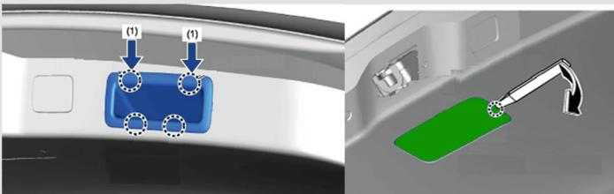
**3** Снимите кнопку закрывания крышки багажного отделения (заглушку для автомобиля без электропривода багажного отделения).
