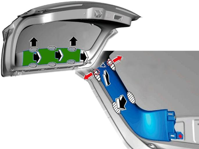
**2** Снимите **карман**, заглушку облицовки и **крышку** замка двери багажного отделения.
