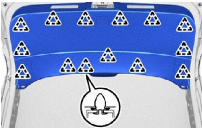
6. ОТВЕРНИТЕ БОЛТЫ И СНИМИТЕ НАРУЖНУЮ НАКЛАДКУ
