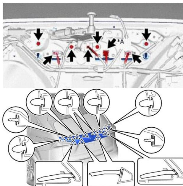
7. ОТВЕРНИТЕ ВИНТЫ КРЕПЛЕНИЯ КАМЕРЫ
