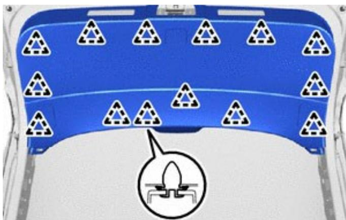
6. ОТВЕРНИТЕ БОЛТЫ И СНИМИТЕ НАРУЖНУЮ НАКЛАДКУ
