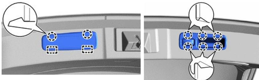
4. СНИМИТЕ КРЫШКУ ЗАМКА ДВЕРИ БАГАЖНОГО
