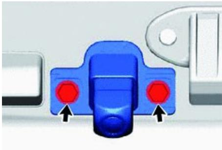
9. НАЖМИТЕ НА ФИКСАТОР РАЗЪЕМА КАК УКАЗАНО НИЖЕ И СНИМИТЕ РАЗЪЕМ С КАМЕРЫ
