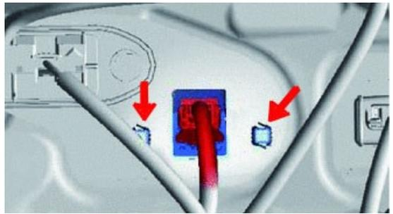
10. ОТВЕРНИТЕ ВИНТЫ КРЕПЛЕНИЯ КАМЕРЫ К ШТАТНОМУ КРОНШТЕЙНУ И УСТАНОВИТЕ ЕЕ НА НОВЫЙ КРОНШТЕЙН. НЕ ПЫТАЙТЕСЬ СНЯТЬ ШЛАНГ С КРОНШТЕЙНА — ВЫ МОЖЕТЕ ЕГО СЛОМАТЬ!
