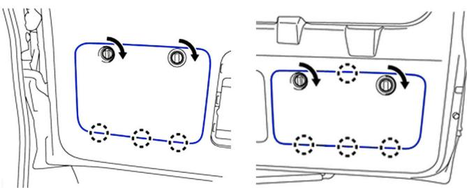
**4** Снимите **крышку замка** двери багажного отделения.
