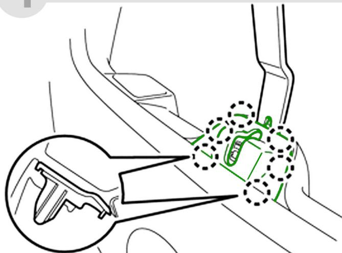
**5** Выверните **винт** из ручки закрывания двери багажного отделения.
