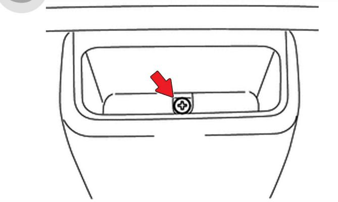
**6** Отверните **болт** и снимите панель облицовки двери багажного отделения в сборе.
