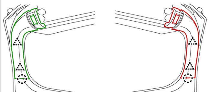
**3** Снимите **облицовочные накладки** двери багажного отделения.
