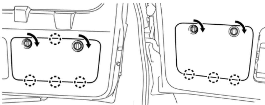
4. СНИМИТЕ КРЫШКУ ЗАМКА ДВЕРИ БАГАЖНОГО
