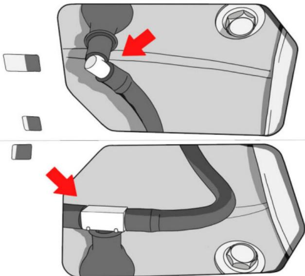
**11** Установите камеру с кронштейном в штатное место. Протяните шланг от тройника к камере заднего вида. Закрепите его стяжками на штатной проводке.
