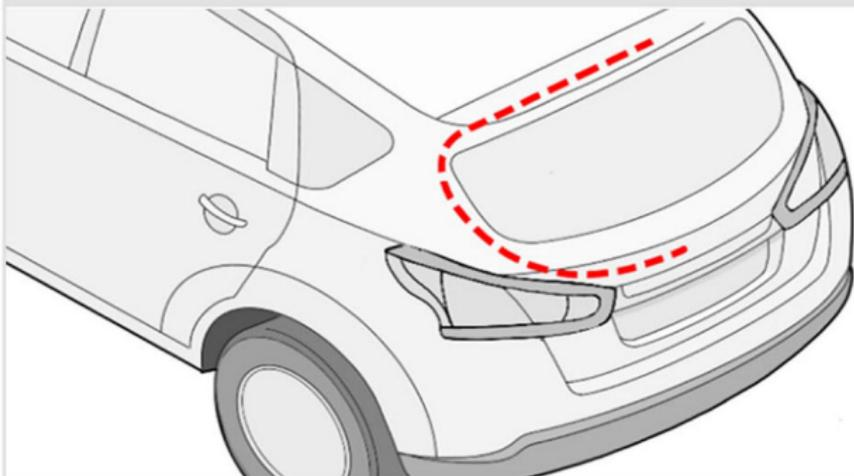
**12** Включите омыватель заднего стекла, убедитесь в отсутствии течей. Сборка авто осуществляется в обратной последовательности. При сборке убедитесь, что устанавливаемые наклейки не пережимают шланг подачи жидкости к омывателю камеры.
