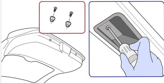
**2** Снимите нижнюю, затем верхнюю обивки двери багажного отделения.
