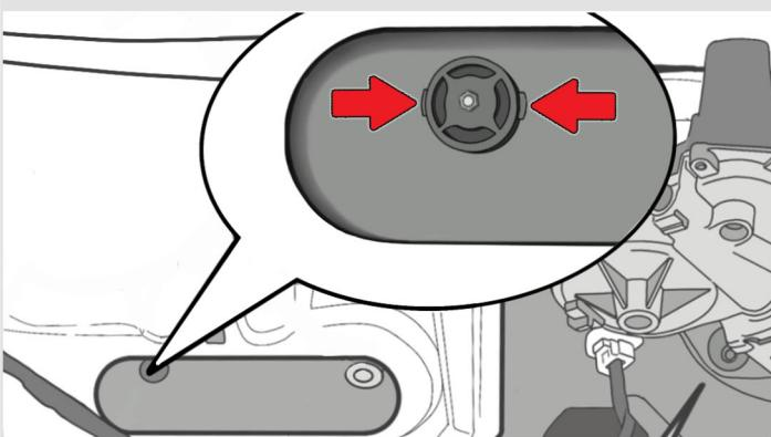
**6** Снимите наружную накладку двери багажного отделения.
