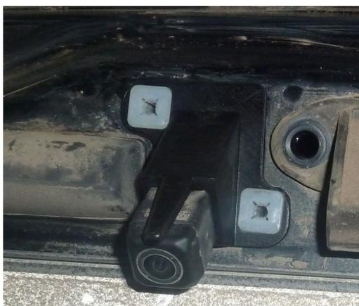
12. ПЕРЕД СБОРКОЙ ПЕРЕСТАВЬТЕ ПЛАСТИКОВЫЕ КЛИПСЫ С КРЫШКИ БАГАЖНИКА НА ПЛАСТИКОВЫЕ ПАНЕЛИ
