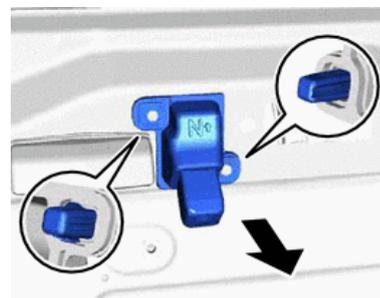
8. НАЖМИТЕ НА ФИКСАТОР РАЗЪЕМА КАК УКАЗАНО НИЖЕ И СНИМИТЕ РАЗЪЕМ С КАМЕРЫ
