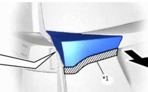
6. ВЫВЕРНИТЕ 4 БОЛТА И СНИМИТЕ НАРУЖНУЮ НАКЛАДКУ
