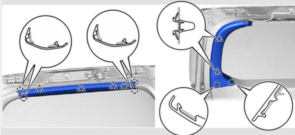
**2** Снимите панель облицовки двери багажного отделения и датчики защемления (для моделей с электроприводом багажника). Выверните 4 винта, освободите 3 фиксатора.
