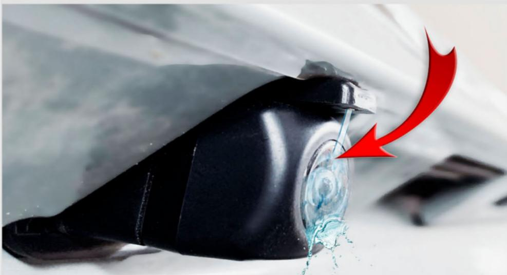
Для регулировки форсунки используйте швейную иглу или финишный гвоздь, слегка заточив его на образивном бруске и согнув плоскогубцами, как показано ниже.
