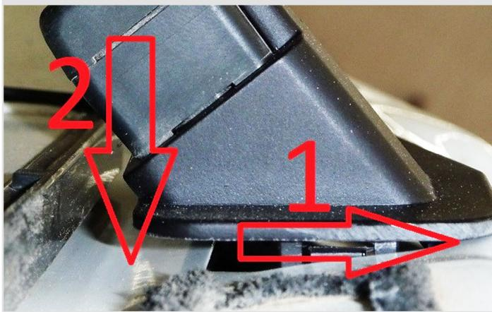
**10** Перед сборкой переставьте пластиковые клипсы с крышки багажника на пластиковые панели.
