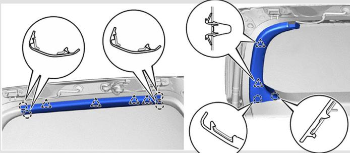
**2** Снимите панель облицовки двери багажного отделения и датчики защемления (для моделей с электроприводом багажника). Выверните 4 винта, освободите 3 фиксатора.
