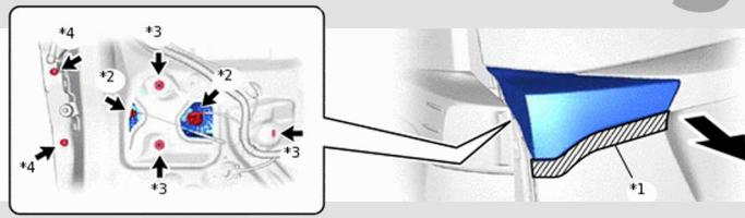
**4** Выверните 4 болта и снимите наружную накладку двери багажного отделения в сборе.
