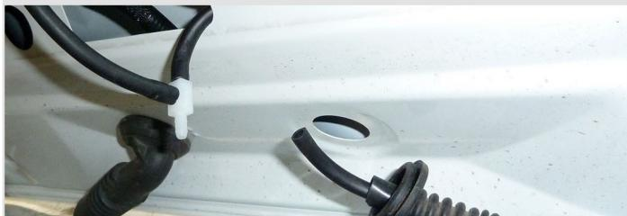
**9** Установите камеру с кронштейном в штатное место в последовательности как на фото. Вертикальные фиксаторы необходимы для облегчения установки,
