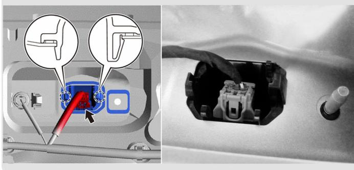
**6** Нажмите на фиксатор разъема как указано ниже и снимите разъем с камеры.
