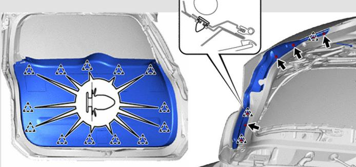
Снимите фонари крышки багажника отсоедините разъем, отверните 5 гаек.
