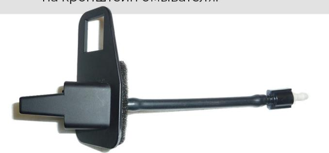
**8** Разрежьте штатный шланг заднего омывателя и установите тройник в место разреза. Соедините тройник с клапаном шлангом, закрепите его стяжками на штатной проводке.
