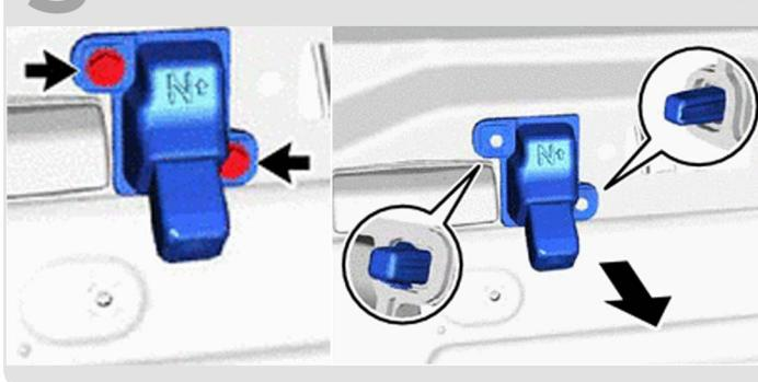
**6** Нажмите на фиксатор разъема как указано ниже и снимите разъем с камеры.
