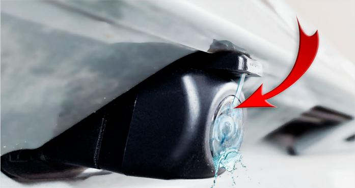
Для регулировки форсунки используйте швейную иглу или финишный гвоздь, слегка заточив его на образивном бруске и согнув плоскогубцами, как показано ниже.
