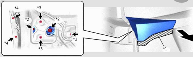
**4** Выверните 4 болта и снимите наружную накладку двери багажного отделения в сборе.
