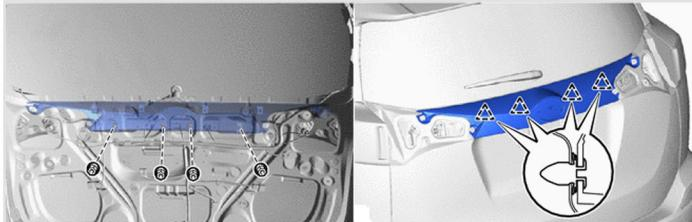
**5** Выверните 2 винта, плоскогубцами сожмите захваты клипса и снимите камеру.
