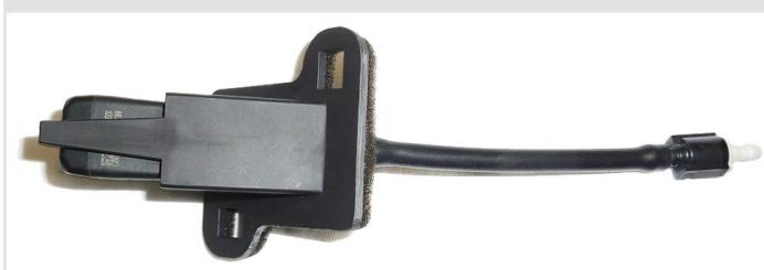
**8** Разрежьте штатный шланг заднего омывателя и установите тройник в место разреза. Соедините тройник с клапаном шлангом, закрепите его стяжками на штатной проводке.
