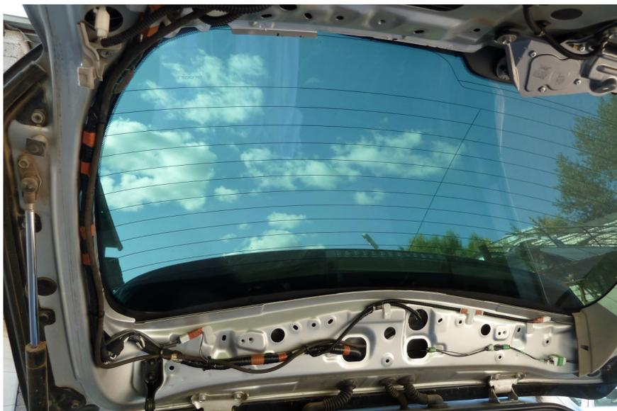
10. УСТАНОВИТЕ КАМЕРУ С КРОНШТЕЙНОМ В ШТАТНОЕ МЕСТО. ВКЛЮЧИТЕ ОМЫВАТЕЛЬ ЗАДНЕГО СТЕКЛА, УБЕДИТЕСЬ В ОТСУТСТВИИ ТЕЧЕЙ. СБОРКА АВТО ОСУЩЕСТВЛЯЕТСЯ В ОБРАТНОЙ ПОСЛЕДОВАТЕЛЬНОСТИ (ПРИ СБОРКЕ УБЕДИТЕСЬ ЧТО УСТАНАВЛИВАЕМЫЕ НАКЛАДКИ НЕ ПЕРЕЖИМАЮТ ШЛАНГ ПОДАЧИ ЖИДКОСТИ К ОМЫВАТЕЛЮ КАМЕРЫ). ПРИ НЕОБХОДИМОСТИ ОТРЕГУЛИРУЙТЕ ПОЛОЖЕНИЕ ШАРИКА ДЛЯ НАИЛУЧШЕГО ОМЫВАНИЯ КАМЕРЫ
