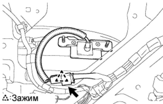
6. ПОДДЕНЬТЕ ОСТРЫМ ПРЕДМЕТОМ ФИКСАТОР И СНИМИТЕ РАЗЪЕМ С КАМЕРЫ
