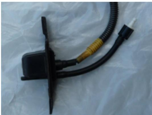
8. РАЗРЕЖЬТЕ ШЛАНГ ФОРСУНКИ ОМЫВАТЕЛЯ ЗАДНЕГО СТЕКЛА И УСТАНОВИТЕ ТРОЙНИК.
