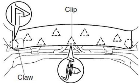
3. СНИМИТЕ НИЖНИЕ НАКЛАДКИ ОБИВКИ ДВЕРИ БАГАЖНОГО ОТДЕЛЕНИЯ
