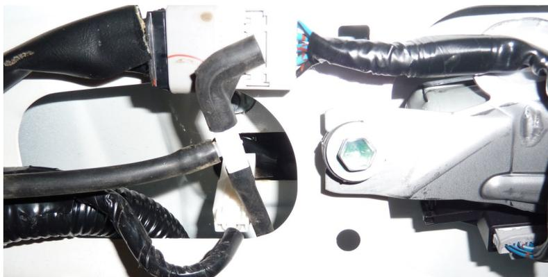
9. СОЕДИНИТЕ ТРОЙНИК С КЛАПАНОМ ШЛАНГОМ, ЗАКРЕПИТЕ ЕГО СТЯЖКАМИ НА ШТАТНОЙ ПРОВОДКЕ.
