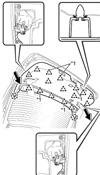
5. ОТВЕРНИТЕ БОЛТ И ГАЙКУ И СНИМИТЕ КАМЕРУ
