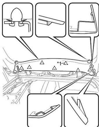
2. СНИМИТЕ НАКЛАДКИ ДВЕРИ БАГАЖНОГО ОТДЕЛЕНИЯ
