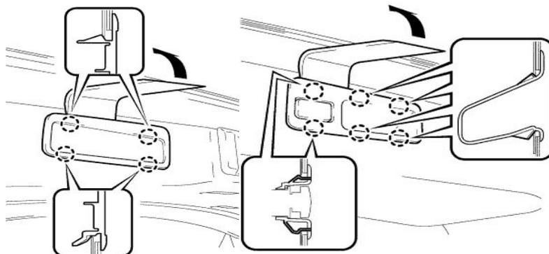
3. СНИМИТЕ ЗАГЛУШКИ И ВЫВЕРНИТЕ 2 ВИНТА КРЕПЛЕНИЯ
