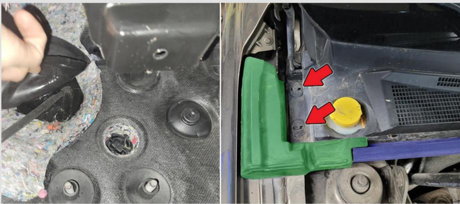
**10** Снимите **колпачки**, ключом на 16 мм открутите гайки и снимите поводки дворников. Снимите пластиковую накладку под лобовым стеклом.
