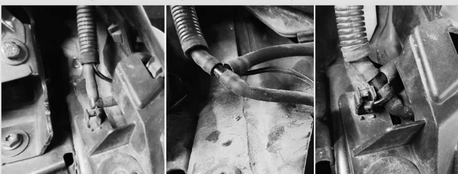
**13** Включите омыватель лобового стекла, убедитесь в отсутствии течей. Сборка авто осуществляется в обратной последовательности (при сборке убедитесь, что устанавливаемые накладки не пережимают шланг подачи жидкости к омывателю камеры).
