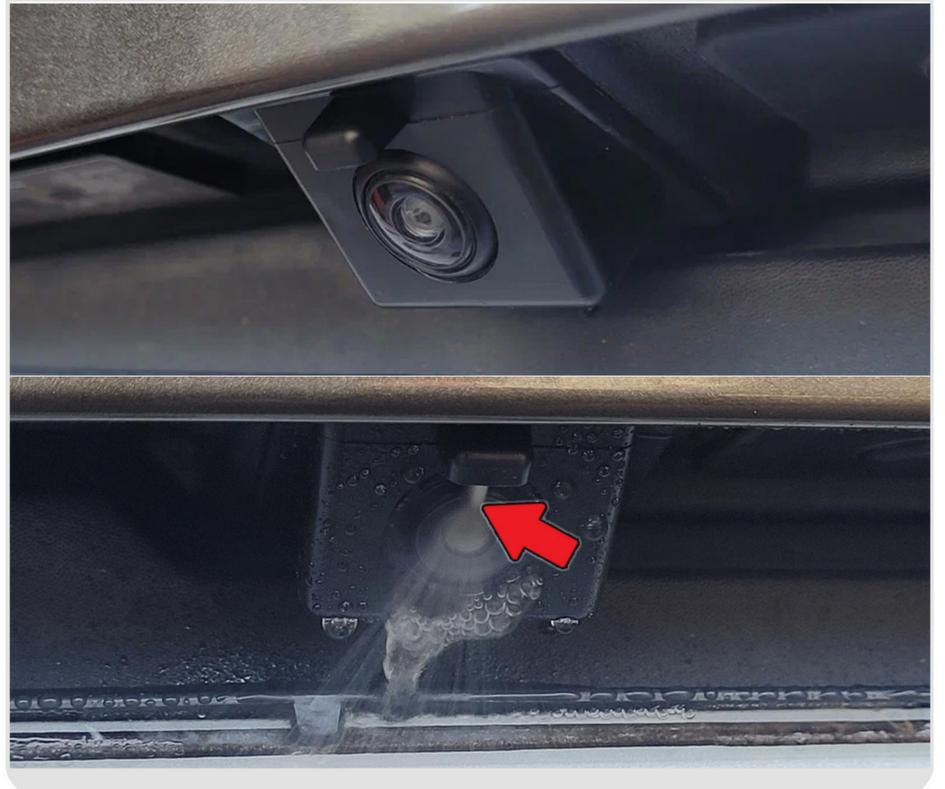
**14** Для регулировки форсунки используйте кнопку-гвоздь (в комплекте), согнув её плоскогубцами, как это показано на рисунке.
