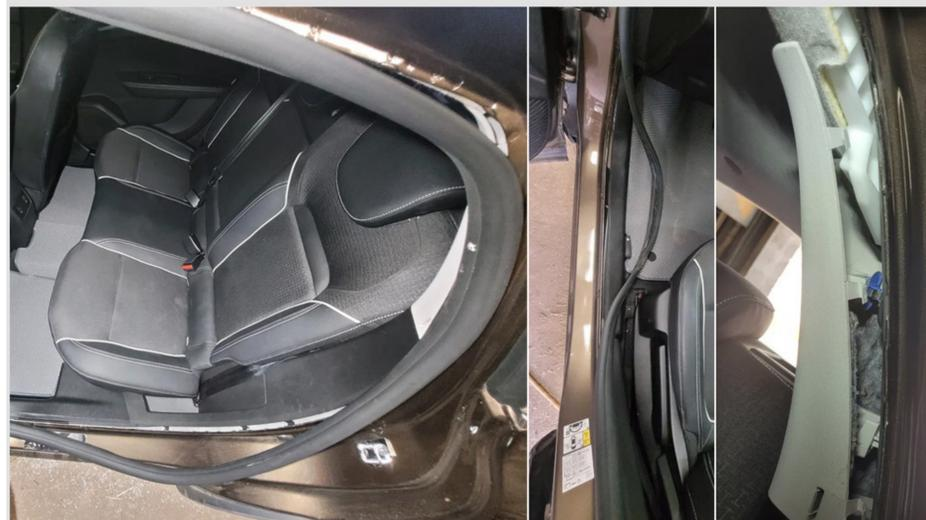
**8** Установите торцевую накладку крышки багажника, протяните шланг внутри крышки багажника, затем через резиновую гофру. Протяните шланг под обивкой крыши к проему задней левой двери, а затем по левому порогу к моторному отсеку.
