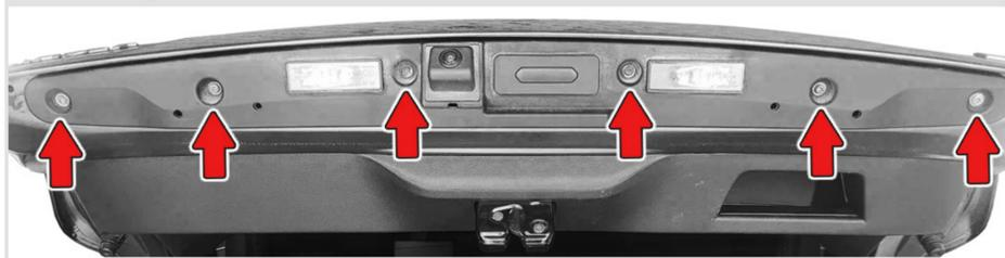
**2** Отсоедините **разъемы подсветки номера, кнопки открывания багажника и камеры заднего вида** и снимите **торцевую накладку крышки багажника**.
