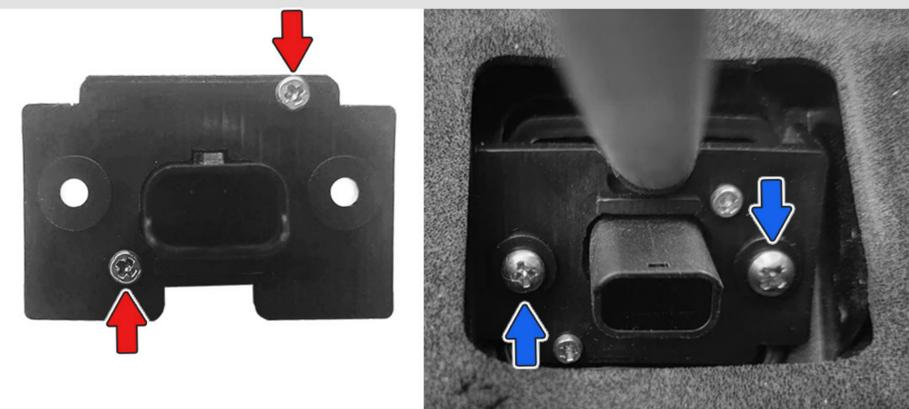
**5** Открутите **3 самореза TORX20**, освободите клипсы и снимите обивку крышки багажника.
