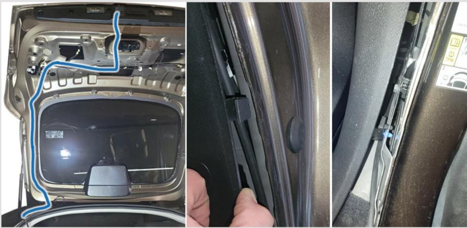
**9** Протяните шланг через штатный уплотнитель в подкапотное пространство. Используйте смазку для лучшего скольжения. Снимите **левый, правый** и **центральный** уплотнители моторного отсека. Отверните по **2 самореза TORX20** слева и справа.
