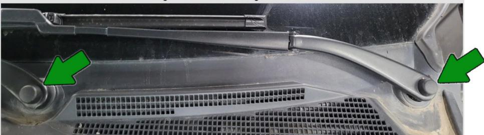
**11** Протяните шланг через **штатный уплотнитель** к бачку омывателя. Закрепите шланг **стяжками**.
