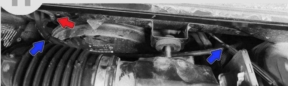
**12** Замените штатный соединитель на тройник как показано на фото. Подключите к нему шланг омывателя камеры. Установите на место пластиковую накладку, закрепите тройник стяжкой.
