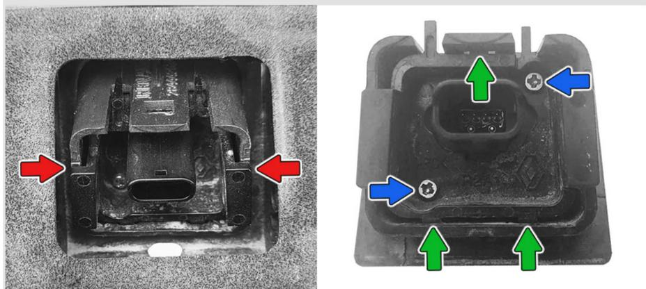
**4** Прикрутите камеру ко внутренней части нового кронштейна с помощью **штатных саморезов**. Установите наружную часть кронштейна с омывателем в накладку крышки багажника, вставьте изнутри камеру с частью кронштейна. Закрутите **2 самореза** из комплекта.
