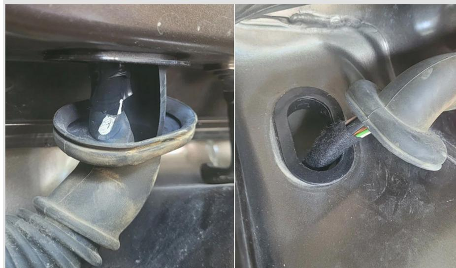
**7** Снимите уплотнители водительского и заднего левого дверных проемов. Частично отстегните верхнюю накладку задней левой стойки.
