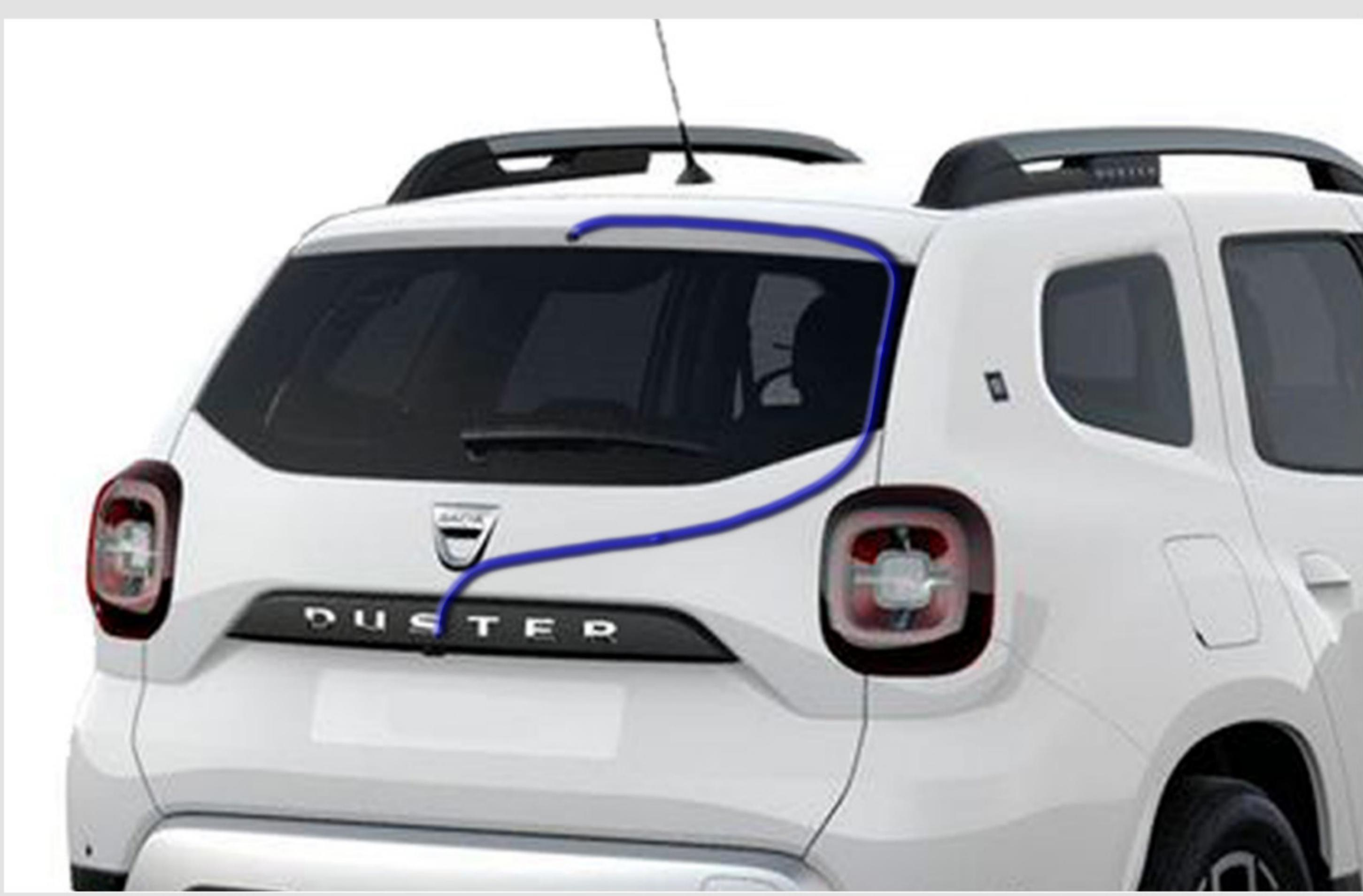
**10** Разрежьте штатный шланг заднего омывателя и установите тройник в место разреза.
