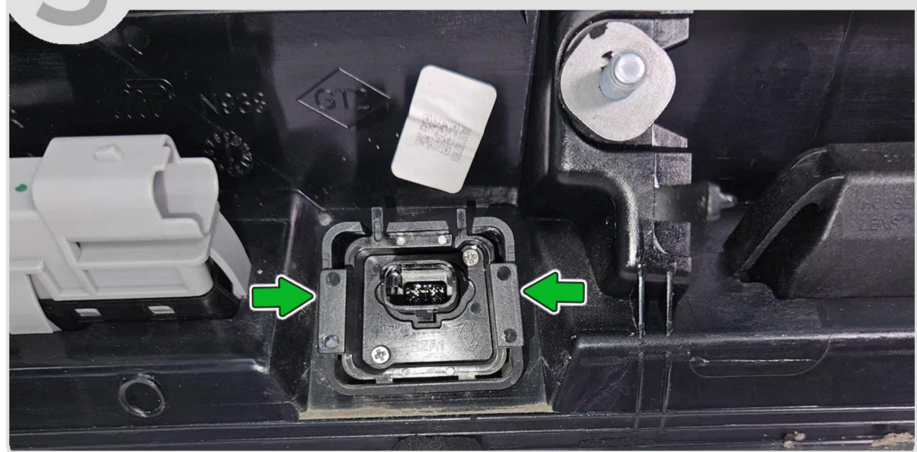
6 Открутите **2 самореза PH1**, освободите **3 фиксатора** и снимите камеру со штатного кронштейна.
