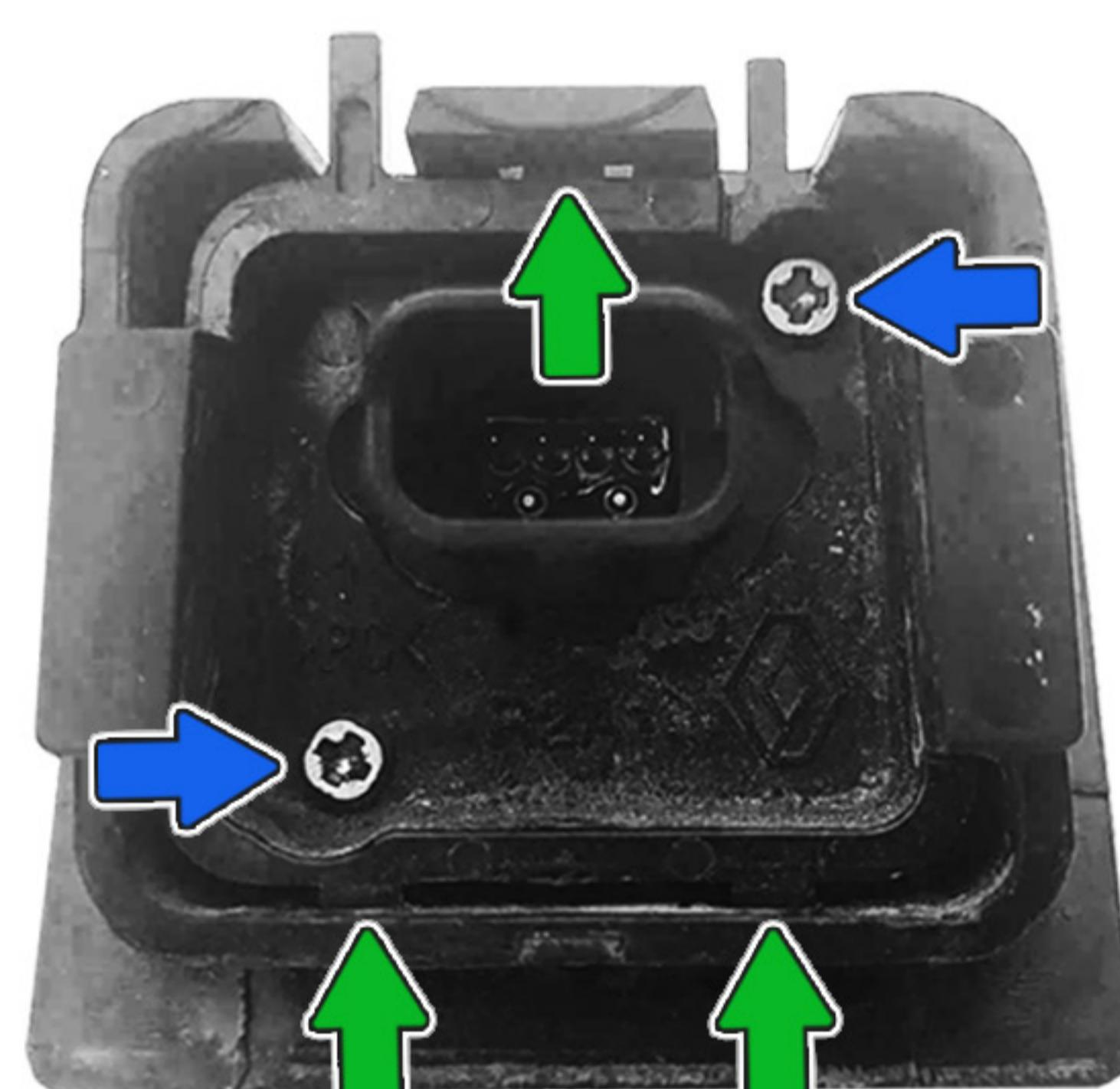
7 Прикрутите камеру к внутренней части нового кронштейна с помощью **штатных саморезов**.
