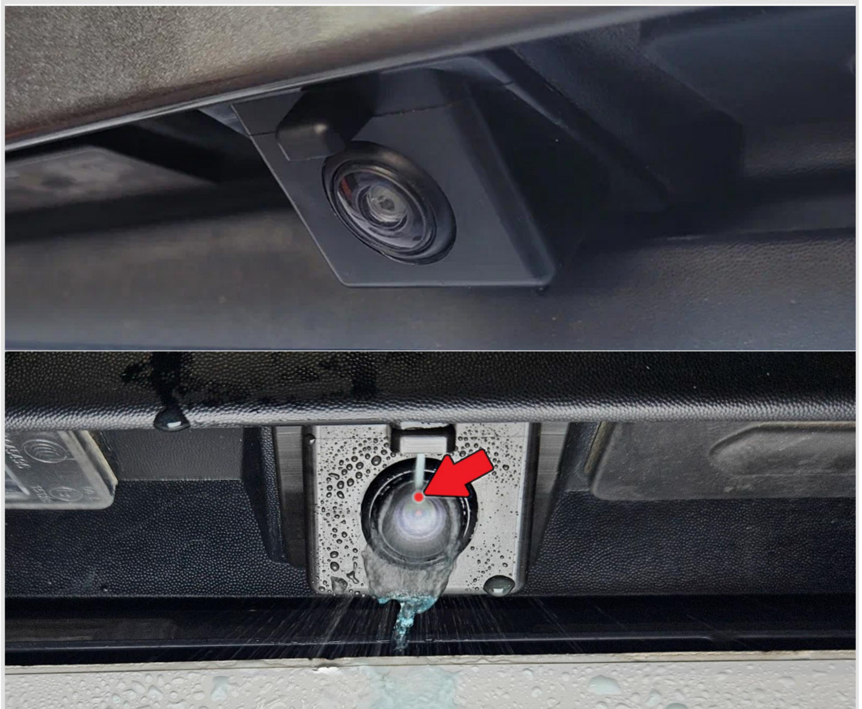
**13** Для регулировки форсунки используйте кнопку - гвоздь (в комплекте), согнув её плоскогубцами, как это показано на рисунке.
