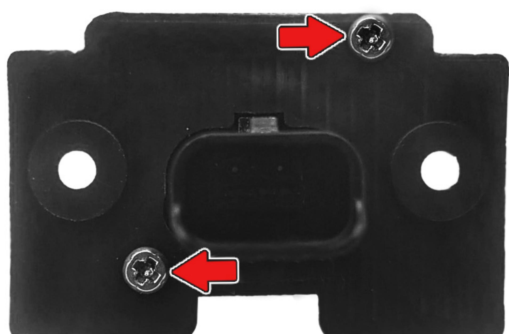
**8** Установите наружную часть кронштейна с омывателем в накладку крышки багажника, вставьте изнутри камеру с частью кронштейна. Закрутите **2 самореза** из комплекта. Установите наружную накладку на крышку багажника.
