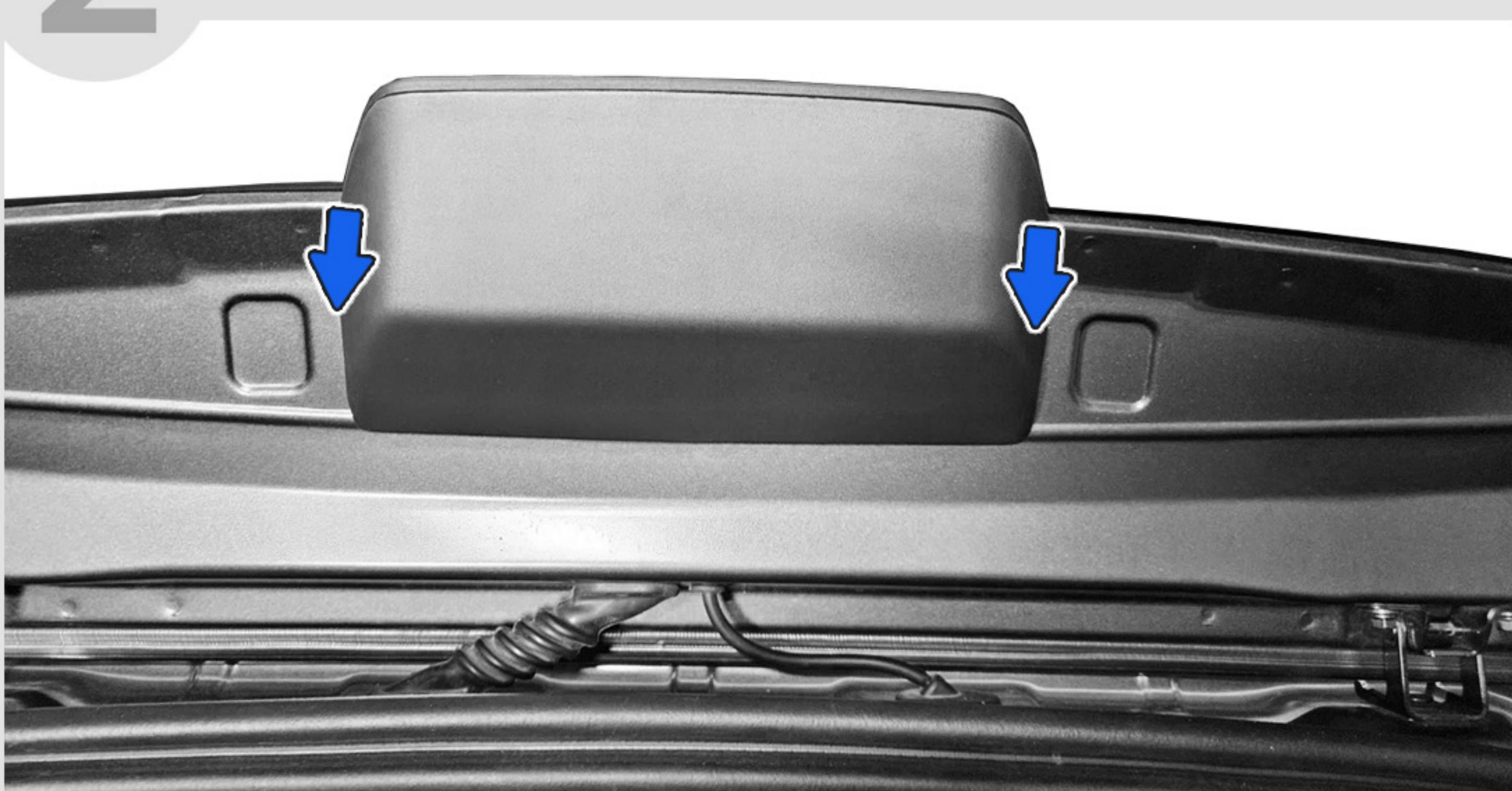
3 Торцевым ключом на 10 отверните **6 гаек** крепления наружной накладки двери багажника.
