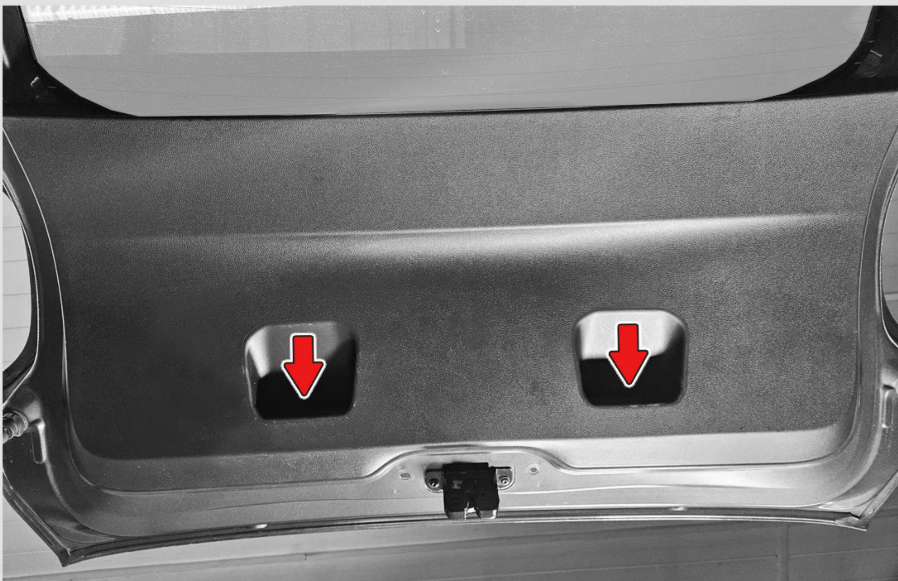
2 Снимите верхнюю накладку крышки багажника.
