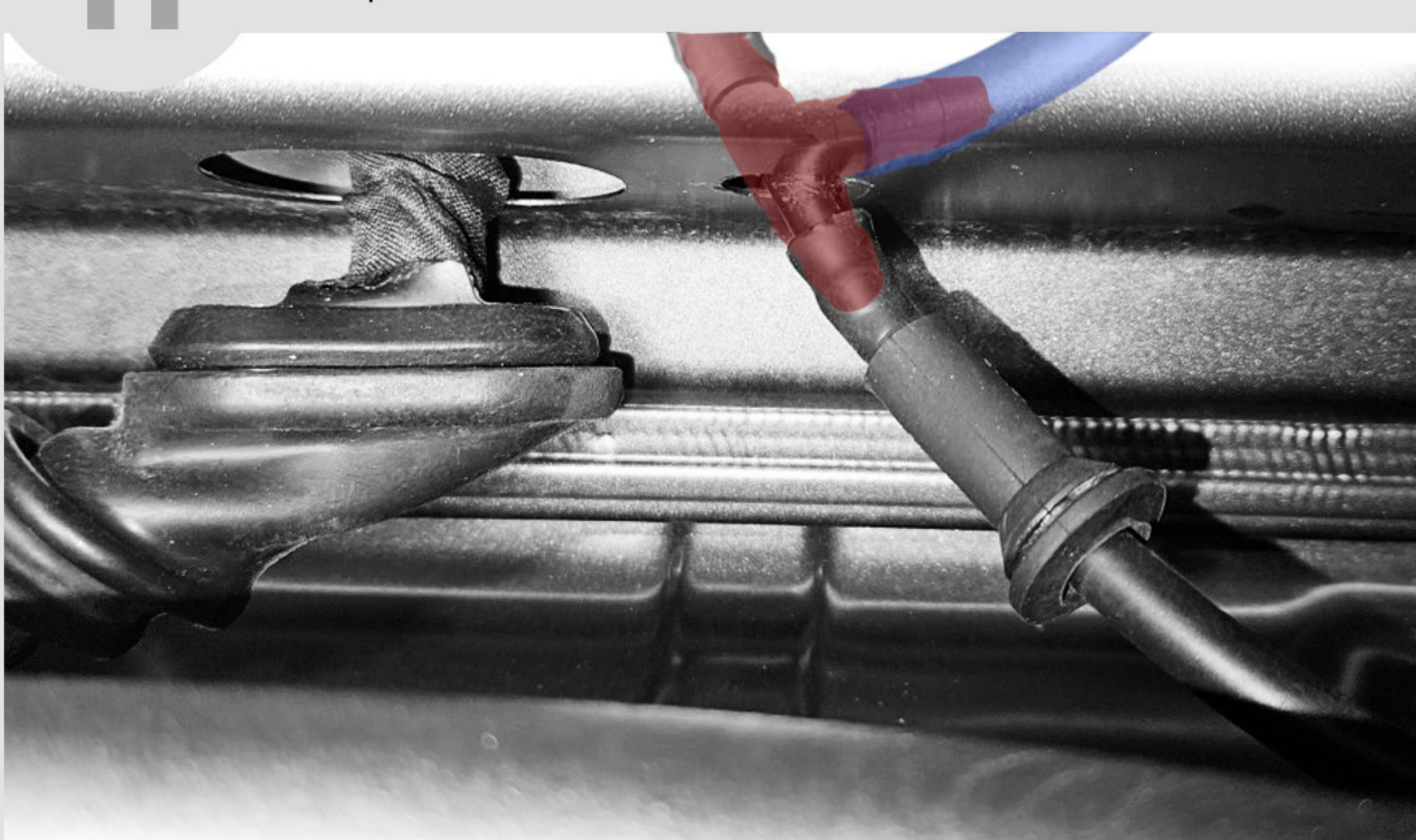
**12** Включите омыватель заднего стекла, убедитесь в отсутствии течей. Сборка авто осуществляется в обратной последовательности (при сборке убедитесь, что устанавливаемые накладки не пережимают шланг подачи жидкости к омывателю камеры).
