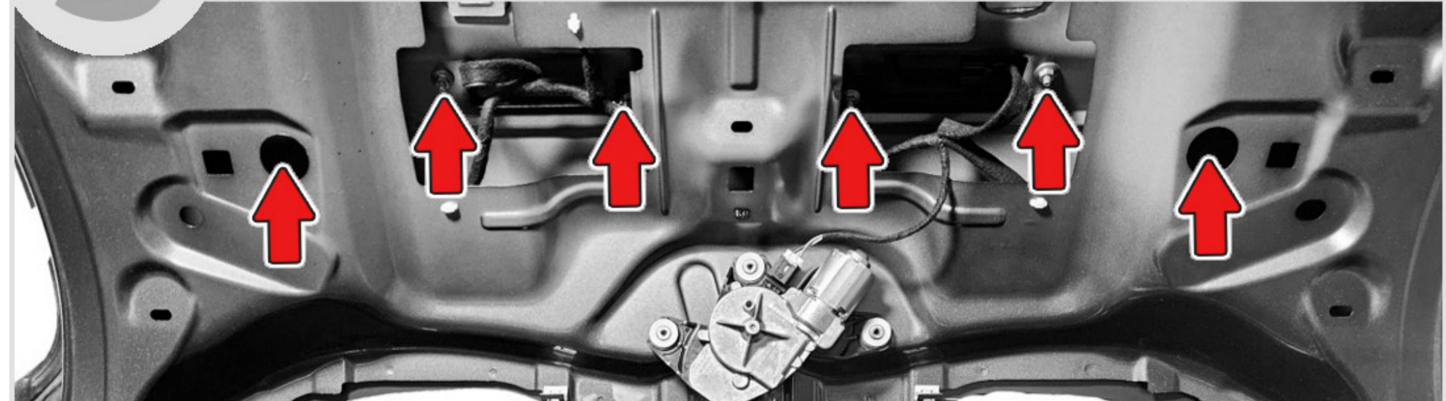
4 Защите кузов вокруг **наружной накладки** багажника малярной лентой. Прогрейте наружную накладку строительным феном (температурой около 100 °С) и снимите ее.
