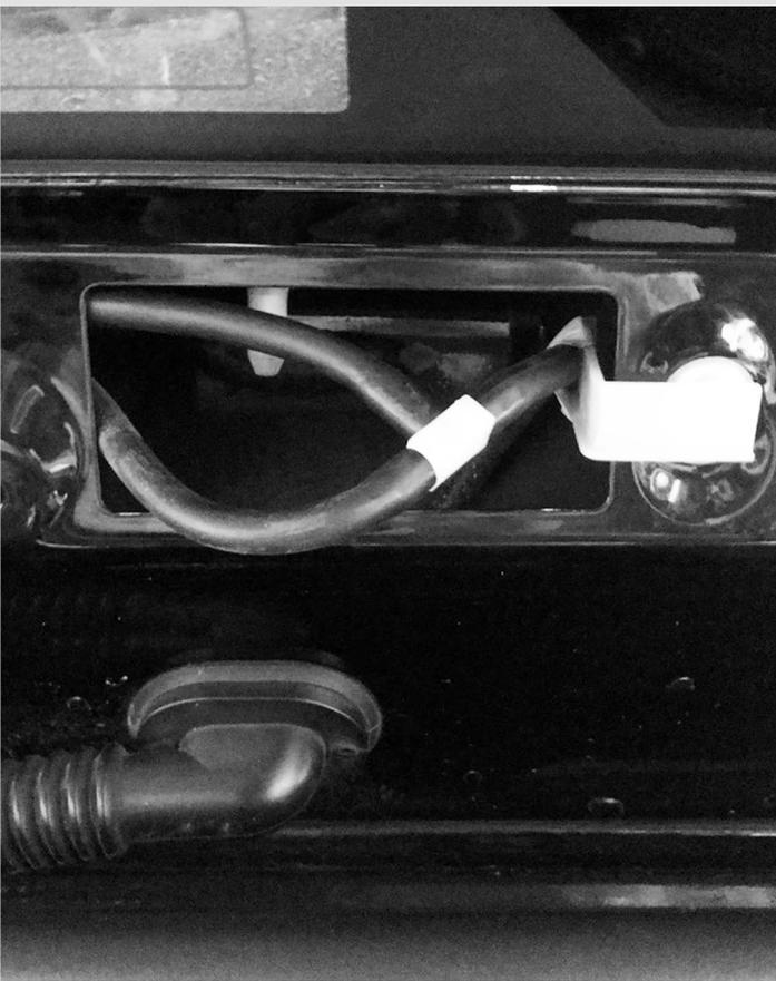
**10** Установите камеру с кронштейном в штатное место. Включите омыватель переднего или заднего стекла в зависимости от того, к которому подключились. Убедитесь в отсутствии течей. Сборка осуществляется в обратной последовательности. При сборке убедитесь, что устанавливаемые накладки не пережимают шланг подачи жидкости к омывателю камеры. При необходимости отрегулируйте положение шарика для наилучшего омывания камеры.
