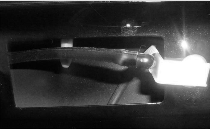
**9** Шлангом соедините тройник с обратным клапаном, закрепите шланг стяжками на штатной проводке.
